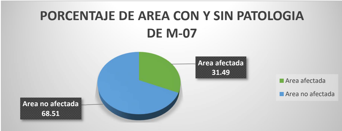
GRAFICO 14: el porcentaje de área afectada en el tramo es de 31.49% y con un 68.51% sin daño en el tramo.
