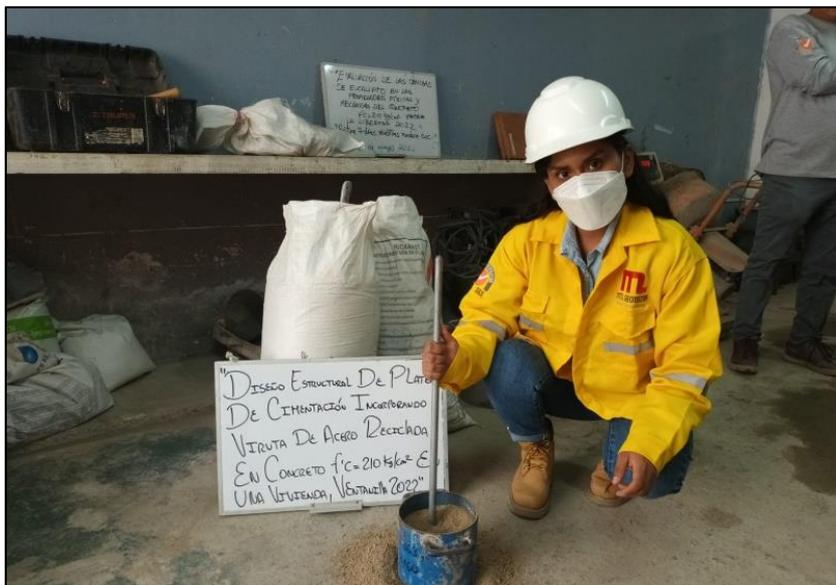
Imagen 4: Realización de ensayo de peso unitario en agregados.
