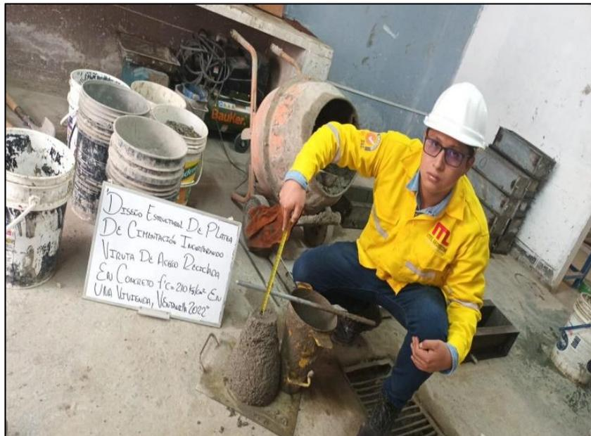
Imagen 7: Verificación del asentamiento del concreto-slump, para el tipo patrón y cada porcentaje de incorporación de viruta de acero.
