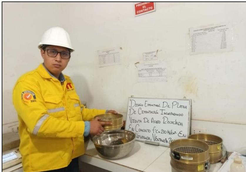
Imagen 4: Realización de ensayo de granulometría en agregados.
