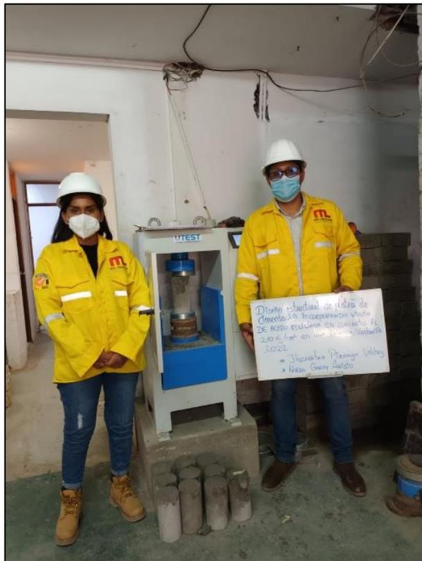
Imagen 11: Ensayo de rupturas en probetas (compresión) a los 7 días de curado.
