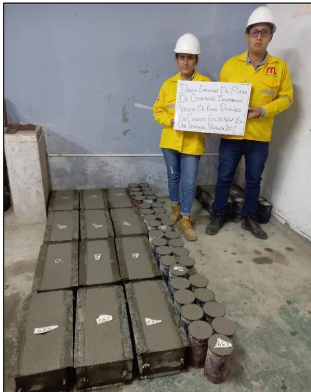
Imagen 9: Visualización del total de muestras vaciadas (36 muestras cilíndricas y 12 prismáticas) de concreto patrón y con adición de viruta de acero.
