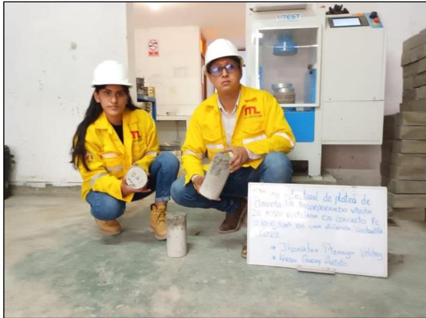
Imagen 12: Ensayo de rupturas en probetas (compresión), a los 14 días de curado
