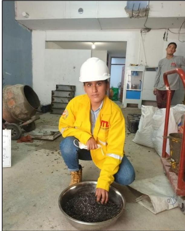
Imagen 8: Limpieza de la viruta de acero antes de ser incorporada en la mezcla de concreto.
