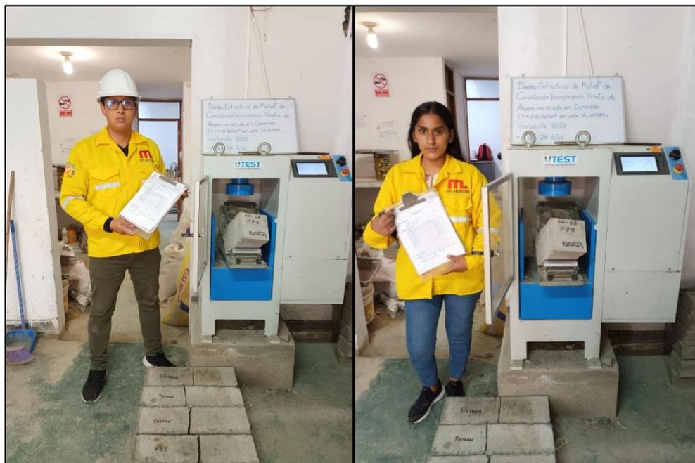
Imagen 15: Ensayo de rupturas en vigas (flexión), a los 28 días de curado
