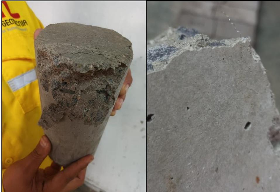
Imagen 14: Visualización de viruta de acero en el concreto posterior al ensayo de compresión (imagen izquierda) y ensayo a flexión (imagen de la derecha)
