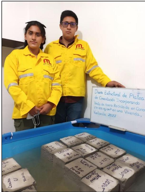
Imagen 10: Curado de las muestras de concreto patrón y con adición de acero.
