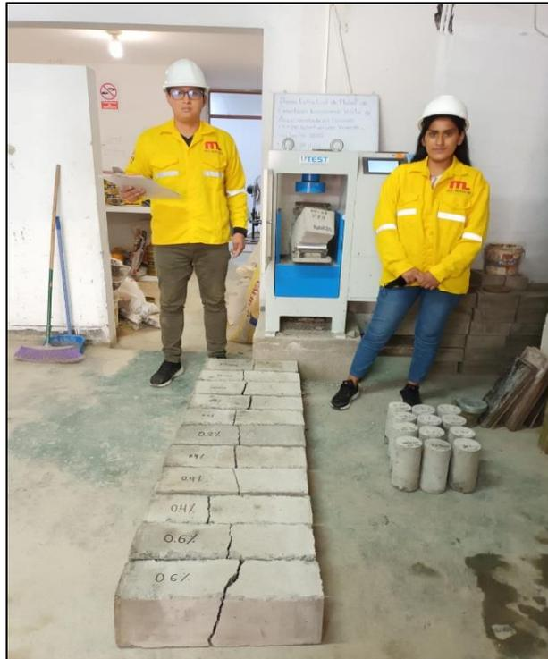
Imagen 16: Ensayo de rupturas en vigas (flexión) y en cilindros (compresión), a los 28 días de curado.
