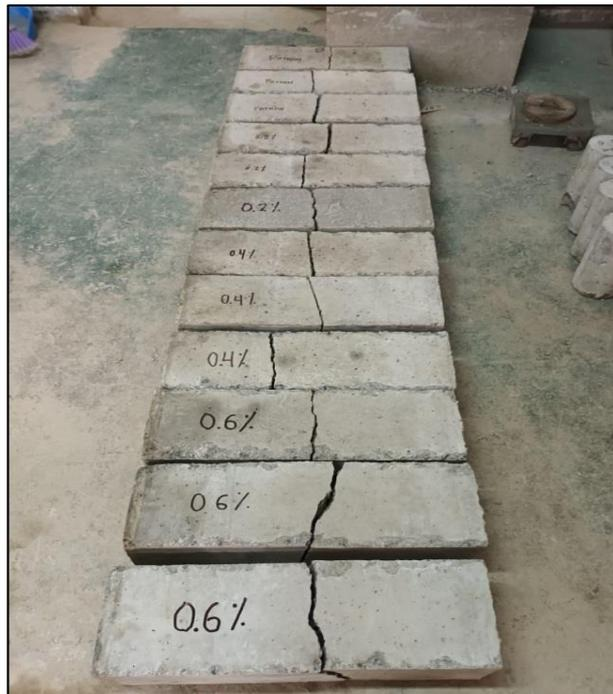
Imagen 17: Ensayo de rupturas en vigas (flexión), a los 28 días de curado.
