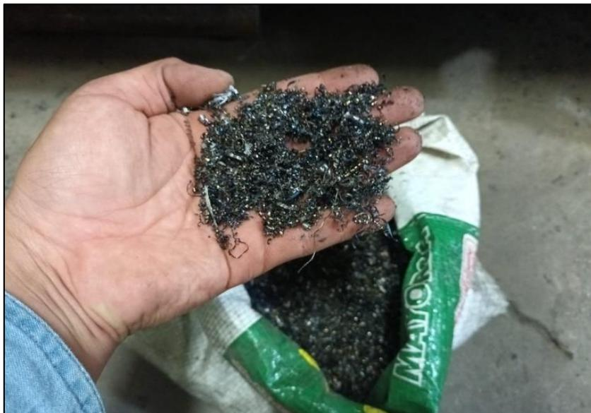
Imagen 2: Visualización de viruta de acero recién extraída de maquinarias.
