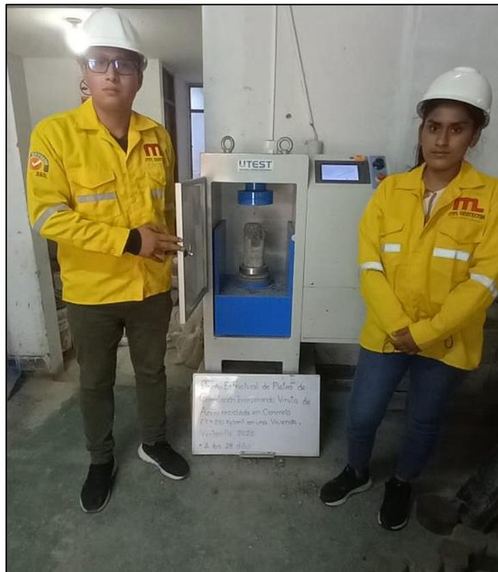
Imagen 13: Ensayo de rupturas en probetas (compresión), a los 28 días de curado
