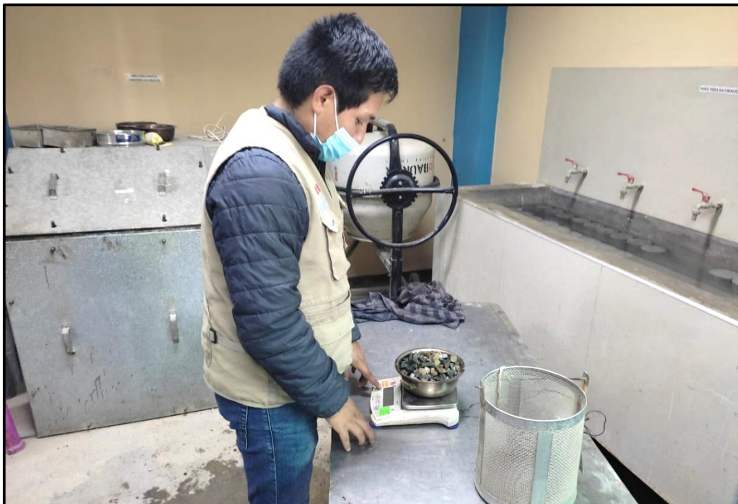
FOTO N°8: Ensayo de peso específico del agregado grueso
