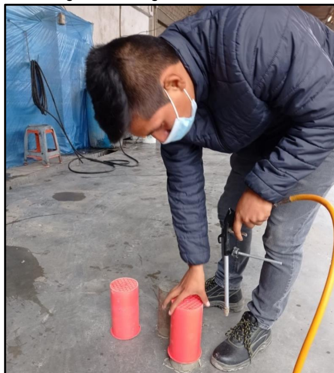
FOTO N° 14: Desmoldado de probetas de concreto f'c 175 kg/cm 2 y f'c 210 kg/cm 2 con agua residual tratada
