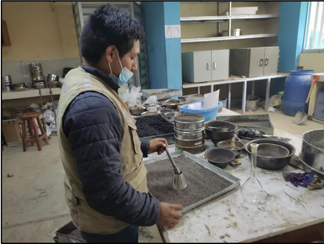
FOTO N°9: Ensayo de peso específico del agregado fino
