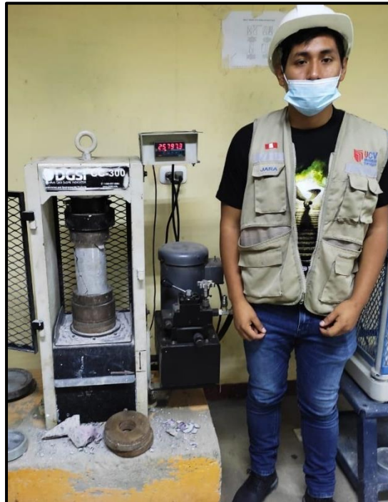
FOTO N°24: Rotura de probetas f'c 175 kg/cm 2 y f'c 210 kg/cm 2 con 28 días de curado con agua residual trata y agua potable.
