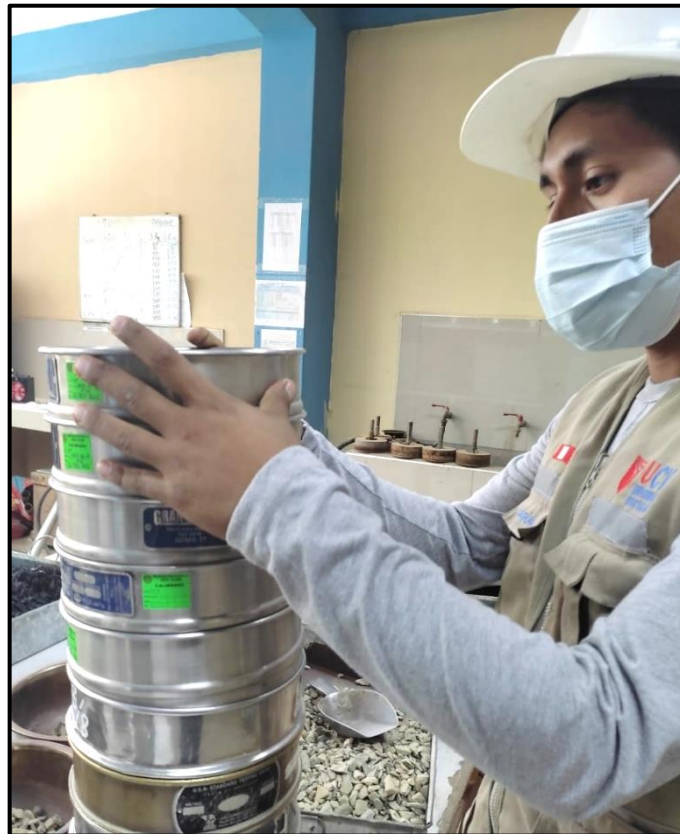
FOTO N°7: Ensayo granulométrico del agregado grueso.
