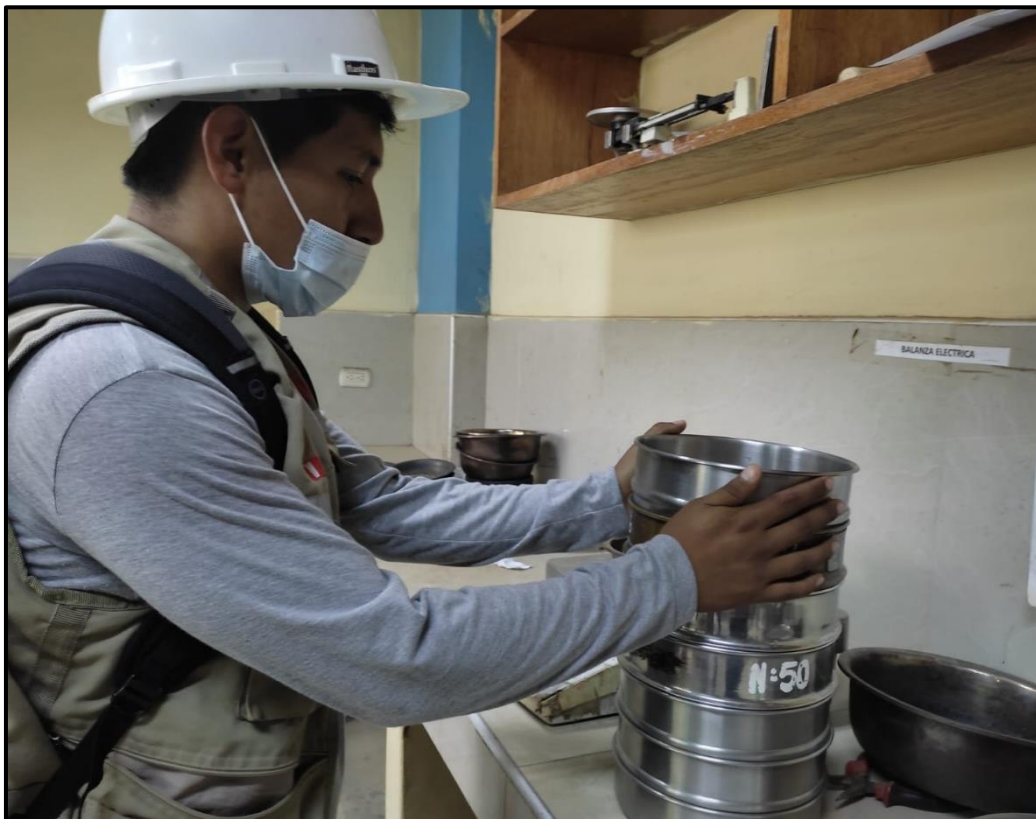
FOTO N°6: Ensayo granulométrico del agregado fino.
