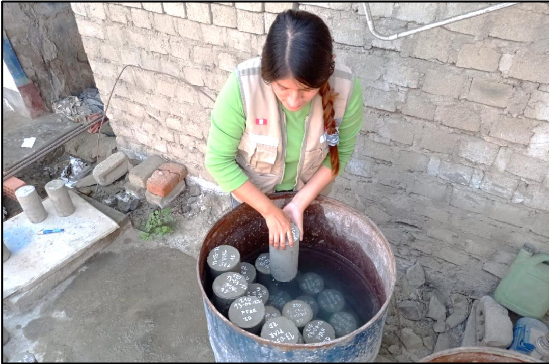
FOTO N° 21: Curado de probetas de concreto f'c 175 kg/cm 2 y f'c 210 kg/cm 2 con agua potable.
