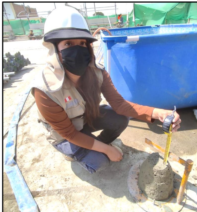
FOTO N° 12: Medida del asentamiento del concreto f'c 175 kg/cm 2 y f'c 210 kg/cm 2 con agua residual tratada.
