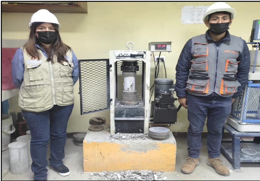
FOTO N° 22: Rotura de probetas f'c 175 kg/cm 2 y f'c 210 kg/cm 2 con 7 días de curado.
