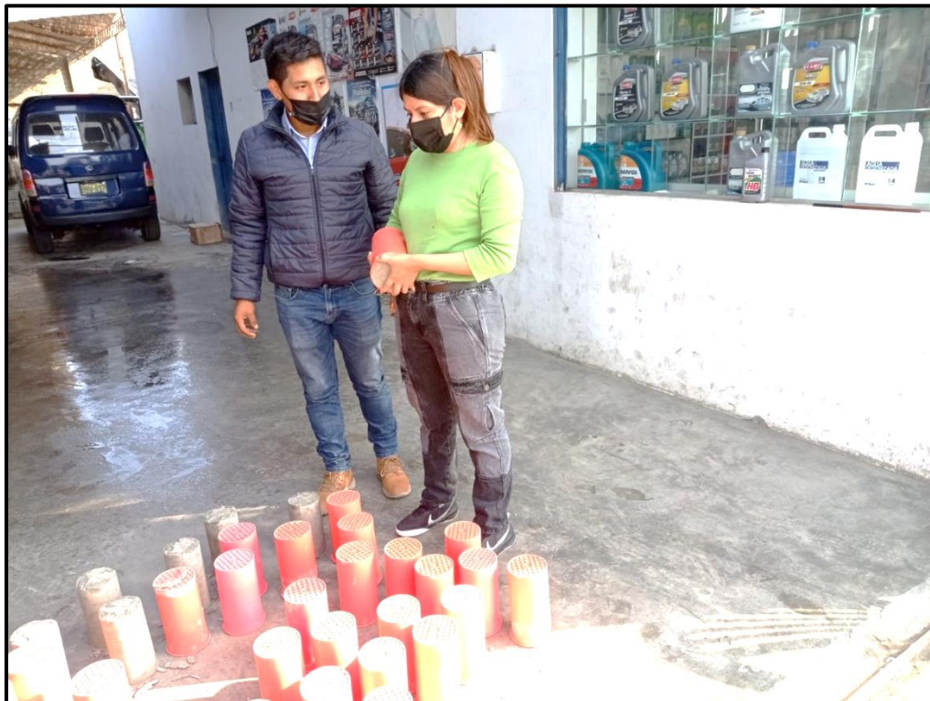
FOTO N° 20: Desmoldado de probetas de concreto f'c 175 kg/cm 2 y f'c 210 kg/cm 2 con agua potable.
