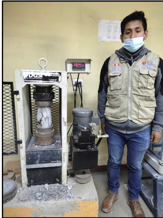
FOTO N° 23: Rotura de probetas f'c 175 kg/cm 2 y f'c 210 kg/cm 2 con 14 días de curado con agua residual tratada y agua potable.
