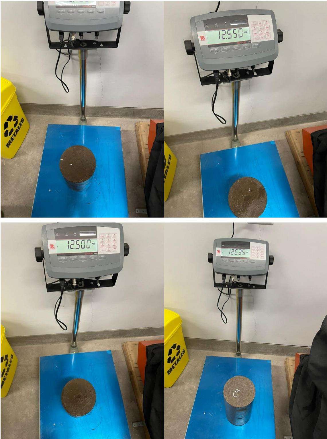
Figura 13. Proceso de peso unitario de las probetas de control
