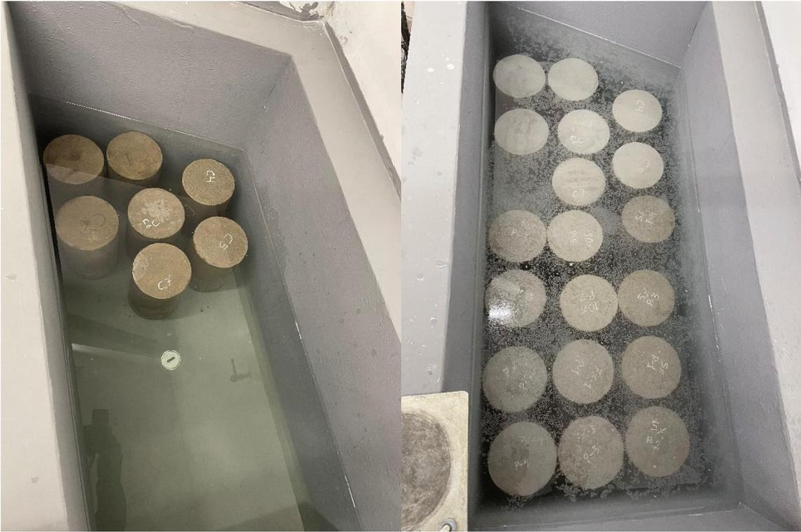
Figura 11. Ubicación de 26 probetas en las pozas de curado
