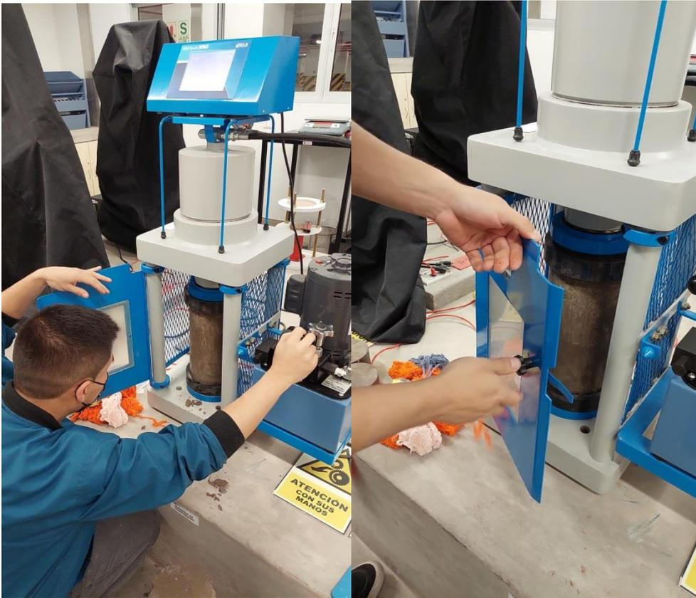
Figura 16. Introducción de las probetas a la máquina de compresión
