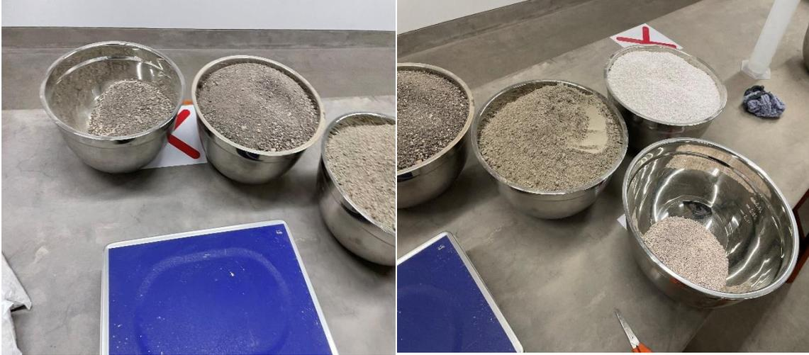
*Figura 3. Pesado de los elementos del concreto*
