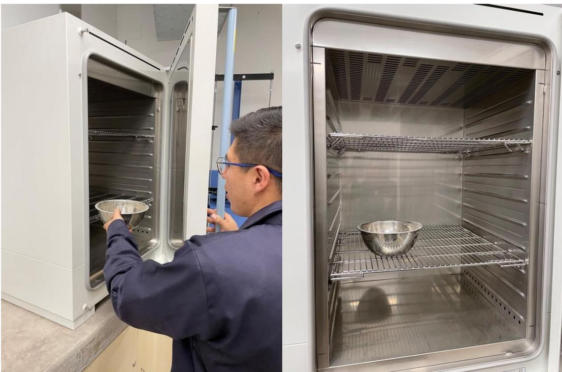
Figura 27. Introduciendo la muestra al horno a  $110^{\circ} \pm 5^{\circ}$
