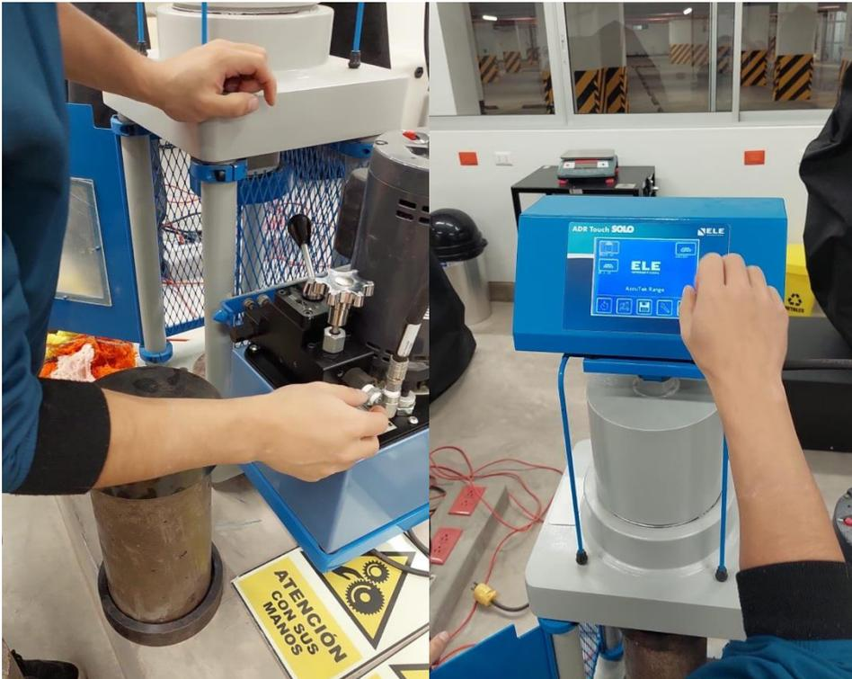
Figura 14. Calibración de la maquina a compresión
