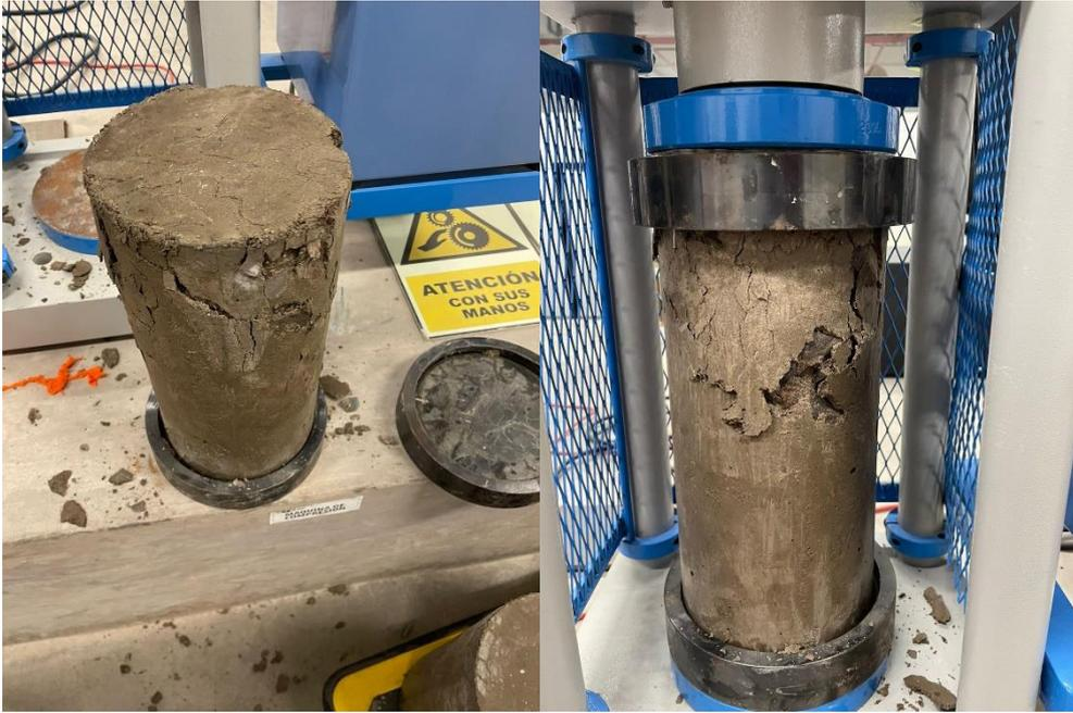
Figura 18. Muestra luego de ser sometida al ensayo de compresión
