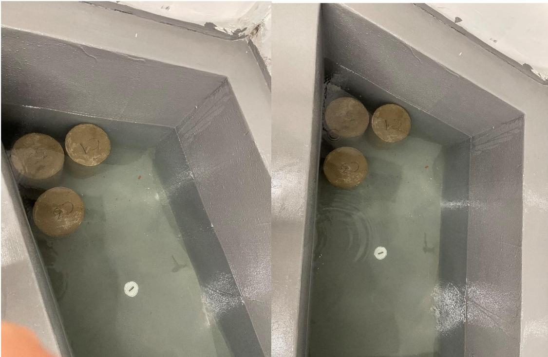
Figura 10. Etapa de curado de las probetas debidamente rotuladas
