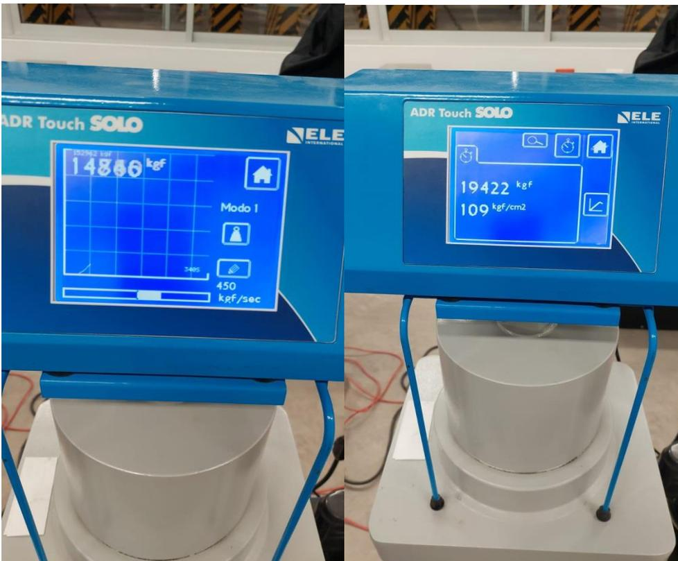
Figura 17. Ensayo a compresión a los 14 días de curado
