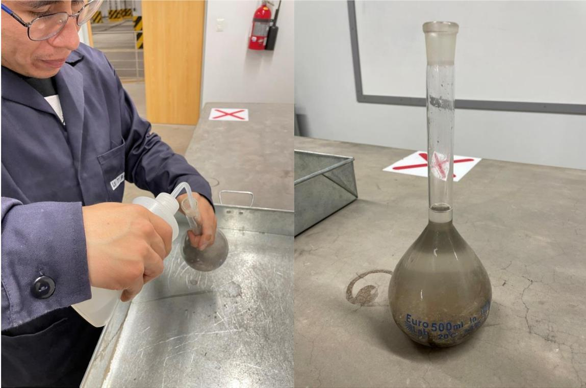
Figura 24. Aforando el matraz para el ensayo de peso específico
