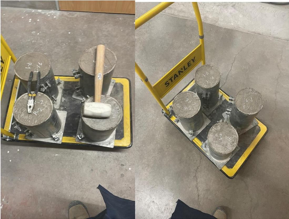
Figura 7. Proceso de desmoldar las probetas
