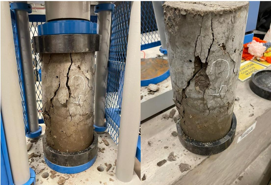
Figura 21. Identificación de fallas de probetas a 28 días de curado
