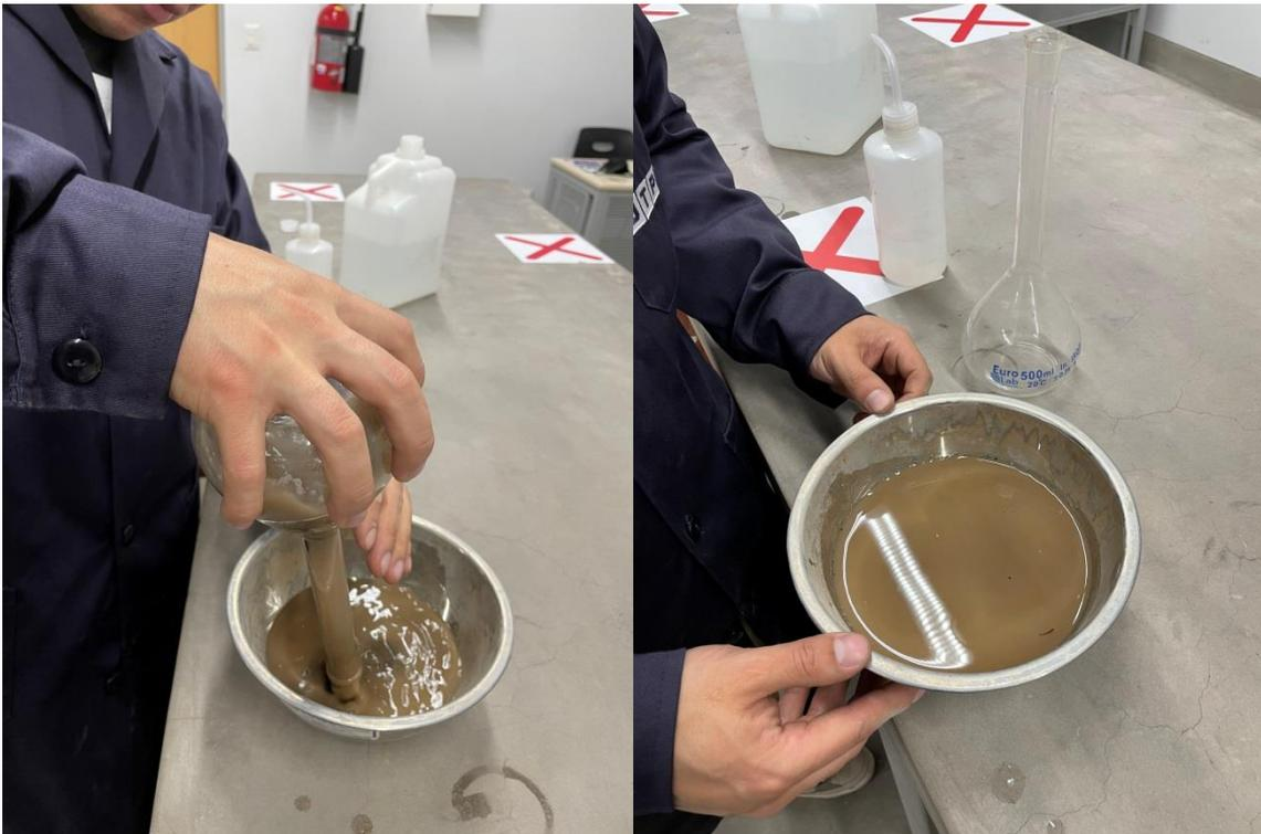
Figura 26. Desaforando la muestra del matraz calibrado
