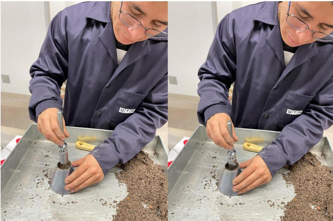
Figura 23. Ensayo de absorción de arena para el agregado fino
