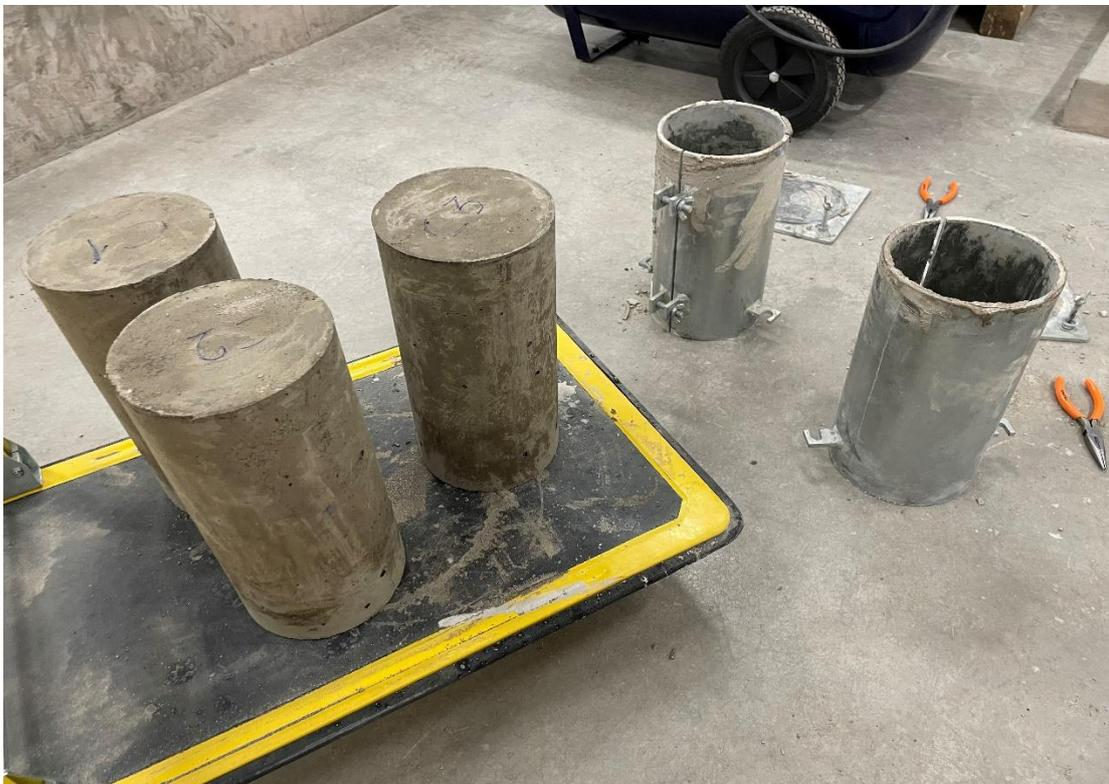
Figura 8. Acarreo de las probetas para ser sumergidas en las pozas de curado
