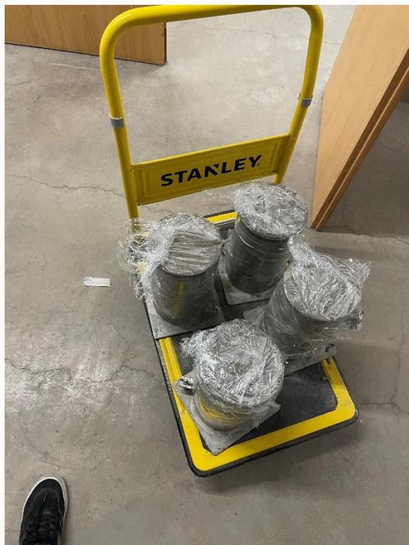
Figura 6. Almacenamiento de las probetas luego del vaciado en el molde
