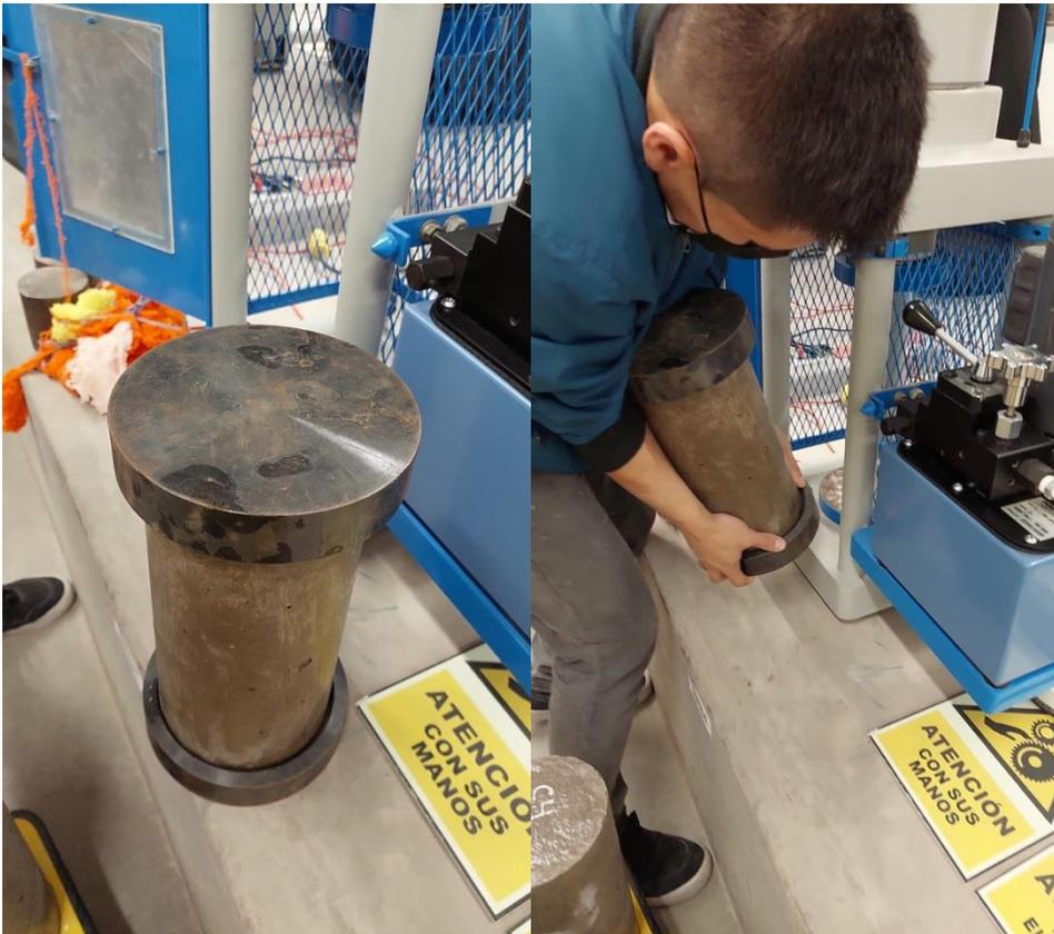
Figura 15. Alistando las probetas para el ensayo de compresión
