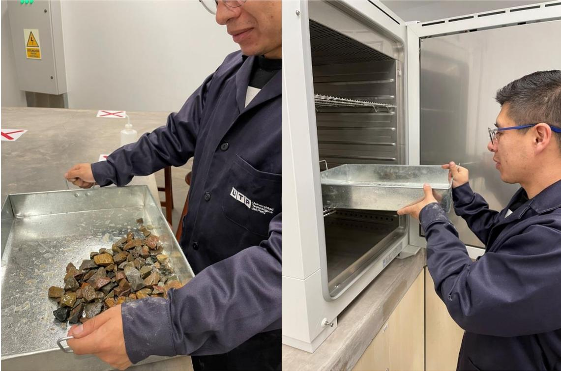
Figura 28. Proceso para determinar el porcentaje de humedad del agregado grueso
