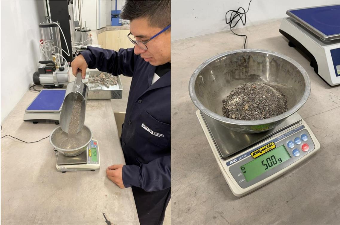
Figura 22. Pesado del agregado fino para ensayo de peso específico
