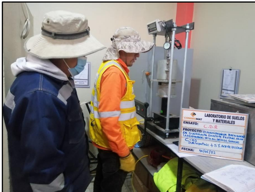
Figura 20. Toma de lecturas en la prensa CBR.
