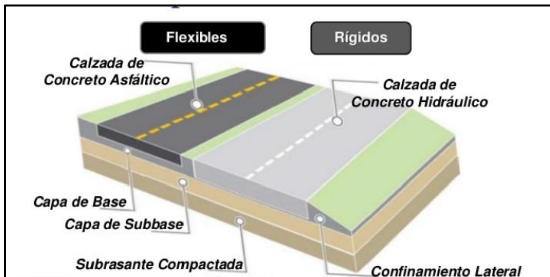
Figura 2. . Estructura de pavimentos
