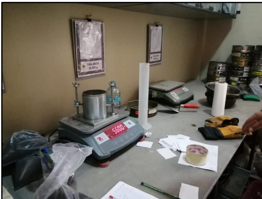
Figura 18. Ensayo de Proctor modificado.
