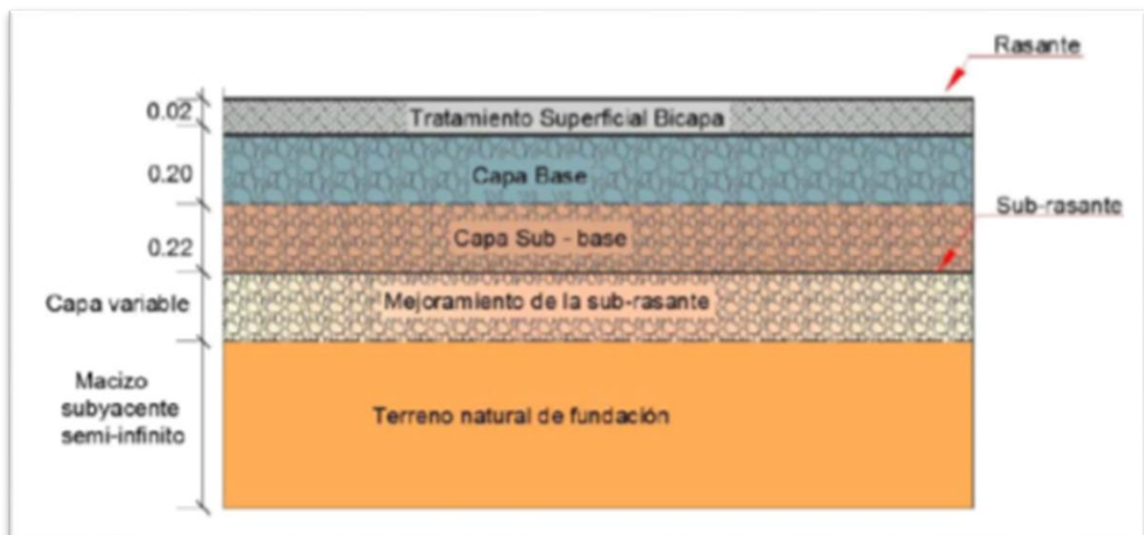
Figura 2. Sección transversal - Pavimento flexible
