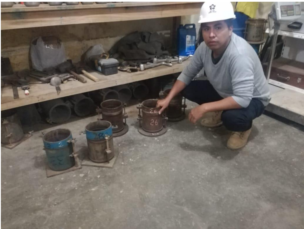
Figura 37. Preparación del molde para la compactación de la muestra
