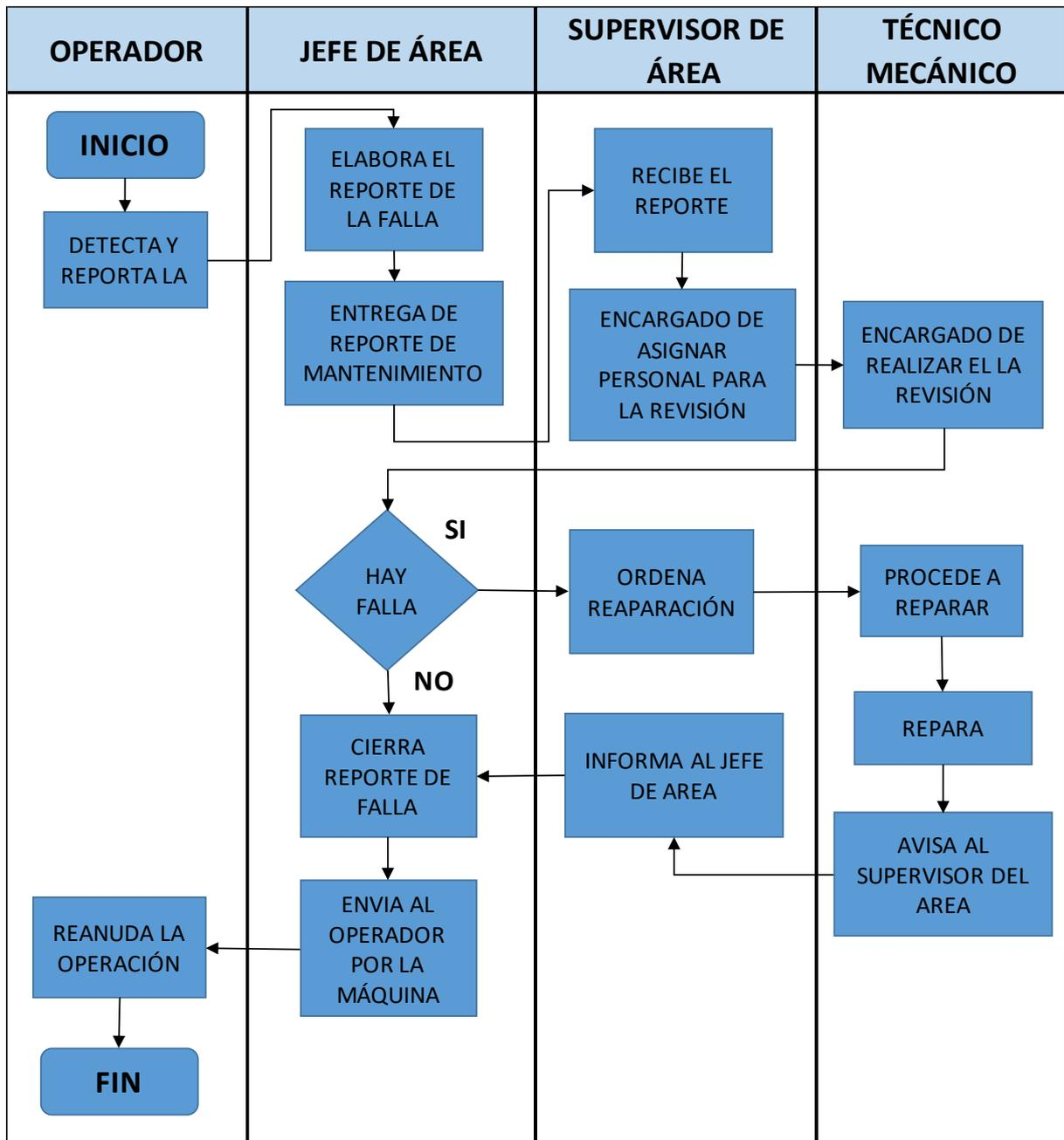
Figura 13. Diagrama de Flujo del mantenimiento correctivo
