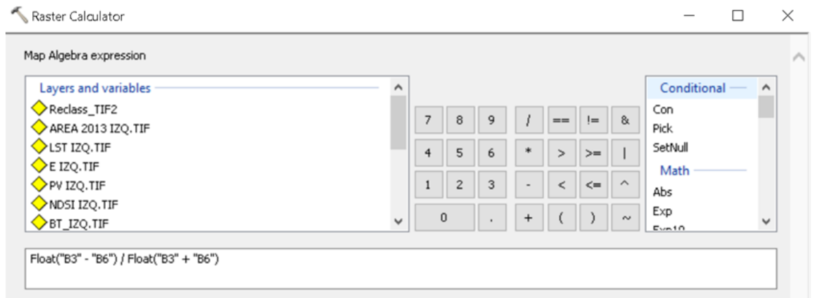
Figura 17: Cálculo del Índice de Vegetación de Diferencia Normalizado (NDVI)
