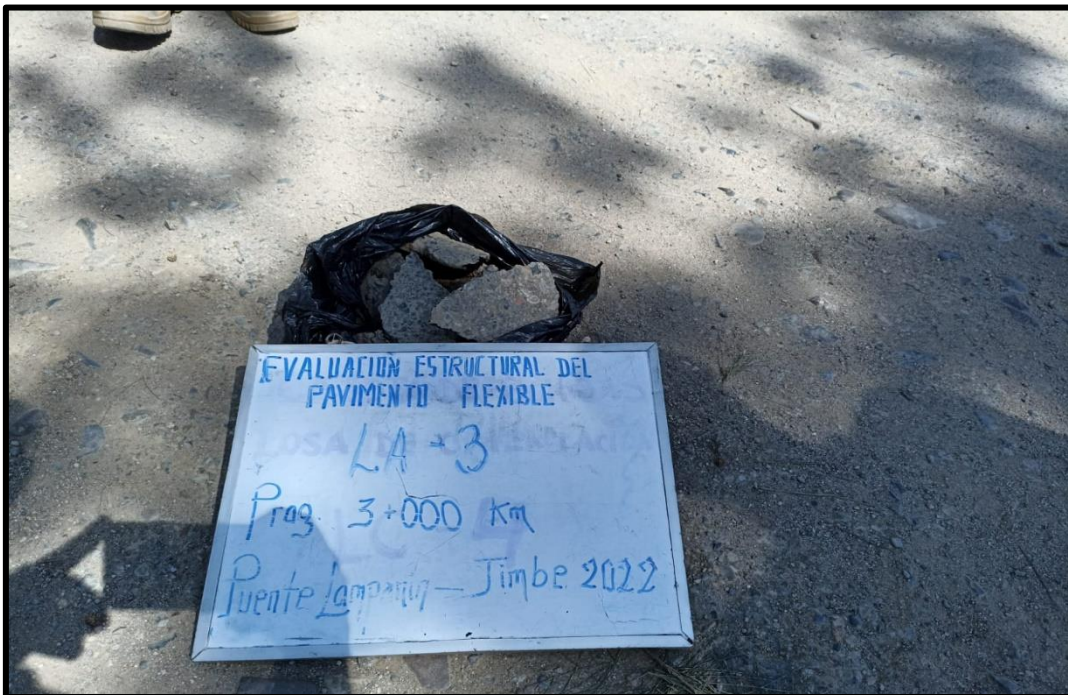
Figura 27: Muestra 3 para lavado asfáltico
