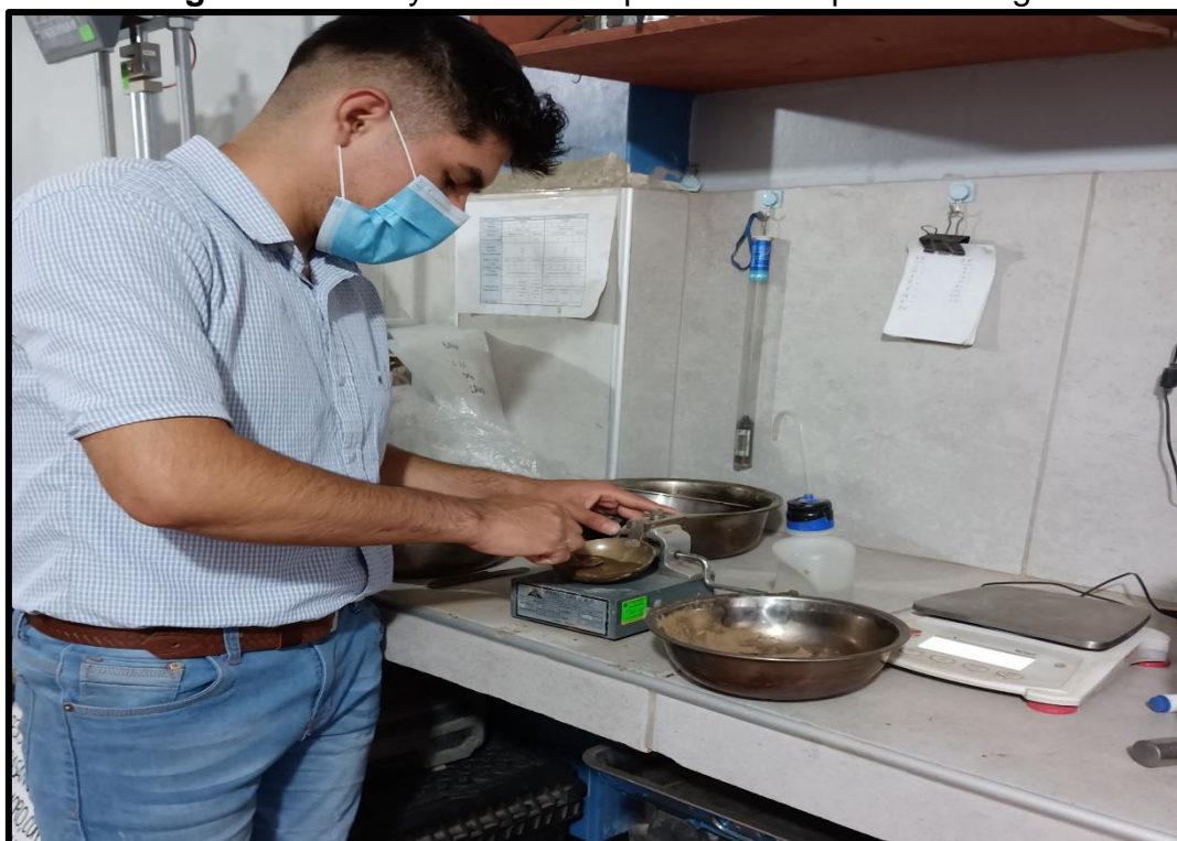
Figura 32: ensayo de limite liquido en la copa de Casagrande
