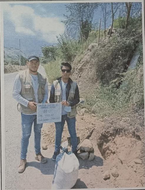
Foto N°01: Vista de ubicación de la calicata C-01, en su parte superficial presencia de terreno natural con gravas aisladas, material de afirmado y al borde carpeta asfáltica de 0.00 a 0.24m. de espesor; seguido de grava biengraduada con limo y arena (GW-GM) de compacidad densa, ligeramente húmeda y de color beige claro de 0.24 a 1.50m. de profundidad. No se registró presencia de napa freática.
