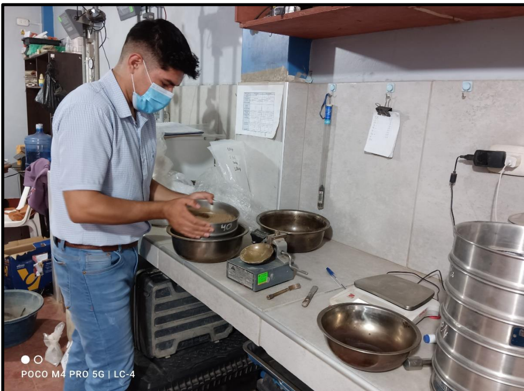
Figura 30: Tamizado para ensayos de los límites de atterberg
