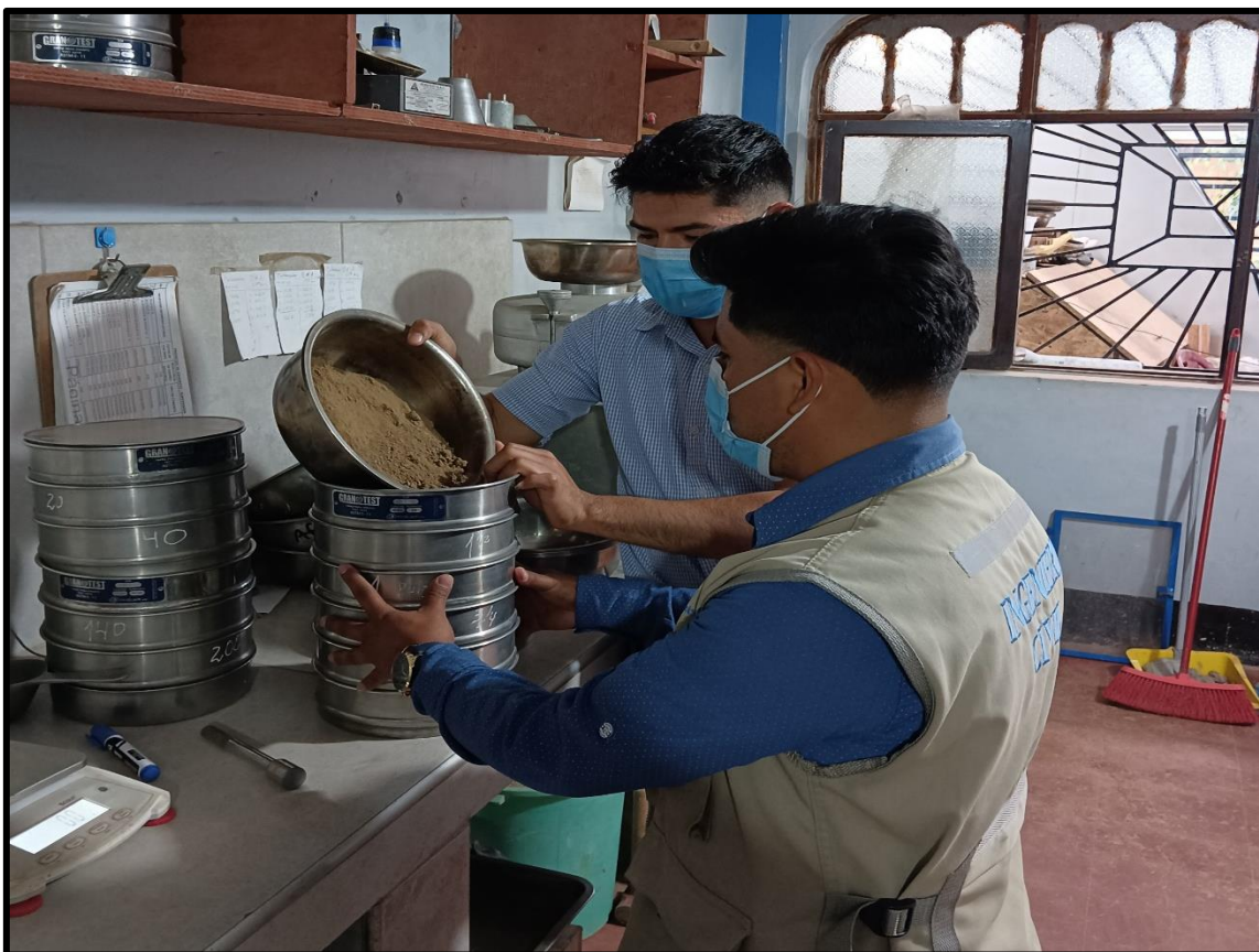
Figura 28: Tamizado de muestras para granulometría
