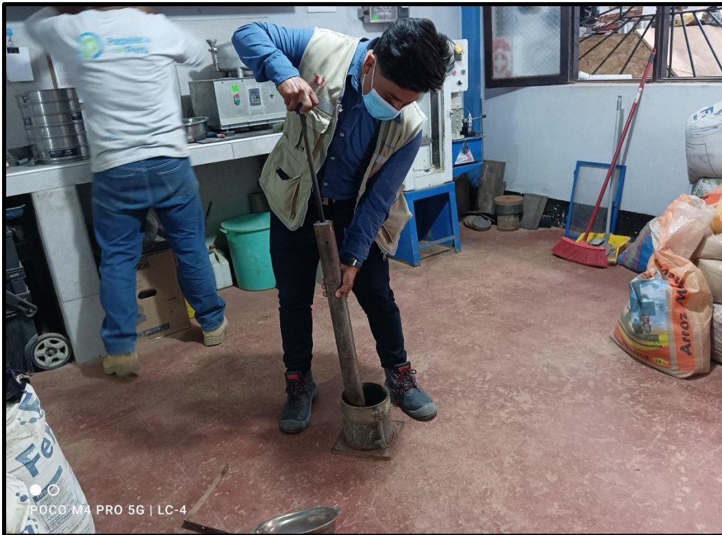
Figura 29: Compactación de la primera capa de Proctor modificado
