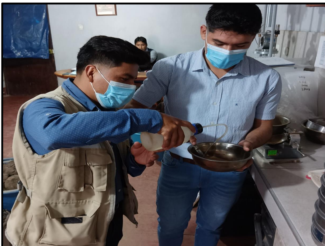
Figura 31: Proceso de ensayo de limite liquido
