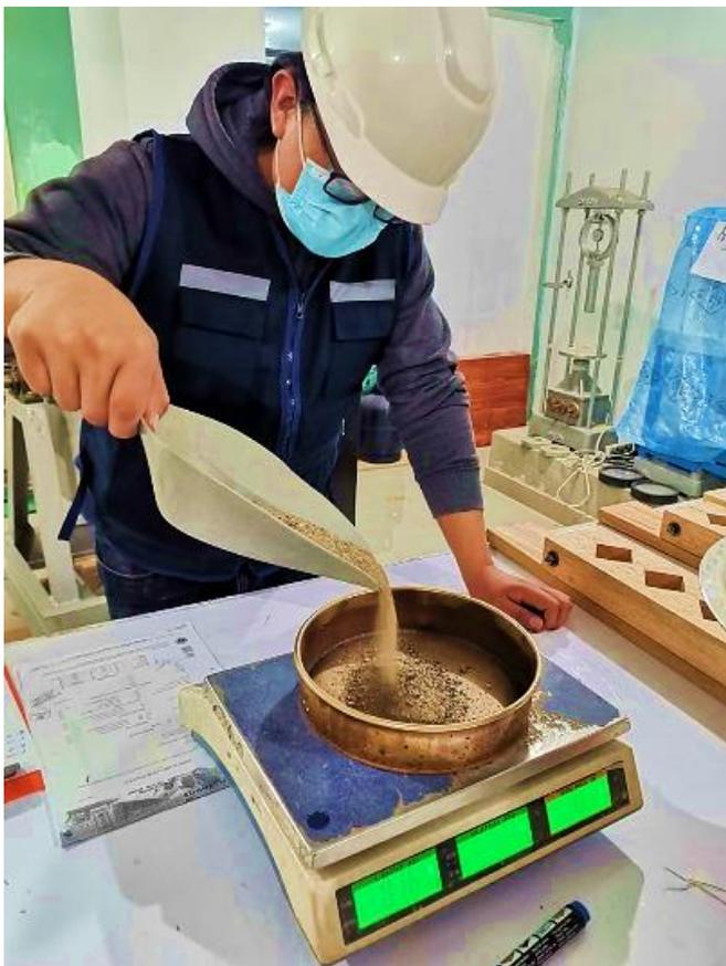
7. Añadido de la fibra de la penca de tuna a la mezcla según diseño
