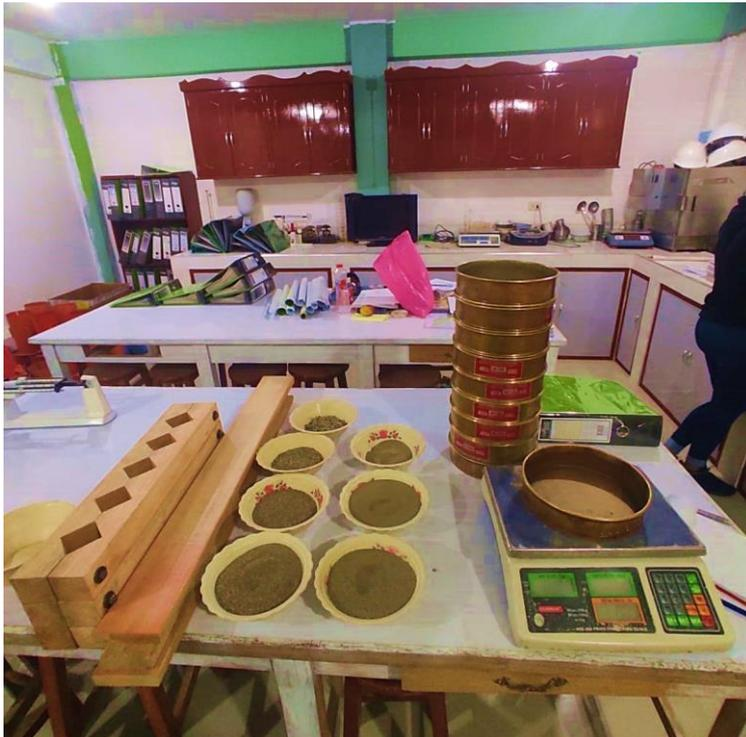
6. Pesado de los materiales según el diseño de mezcla
