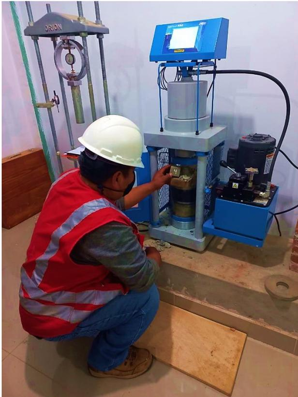
18. Rotura al catorceavo día de secado de los cubos (5 cubos de cada diseño)
