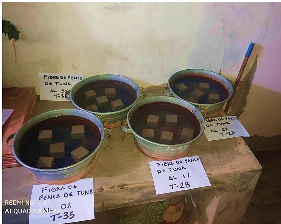
16. Rotura al tercer día de secado de los cubos (5 cubos de cada diseño)
