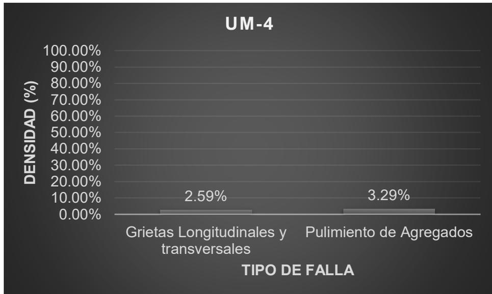
Figura 101. Densidad de las fallas en la progresiva (km): 0+120 – 0+160
