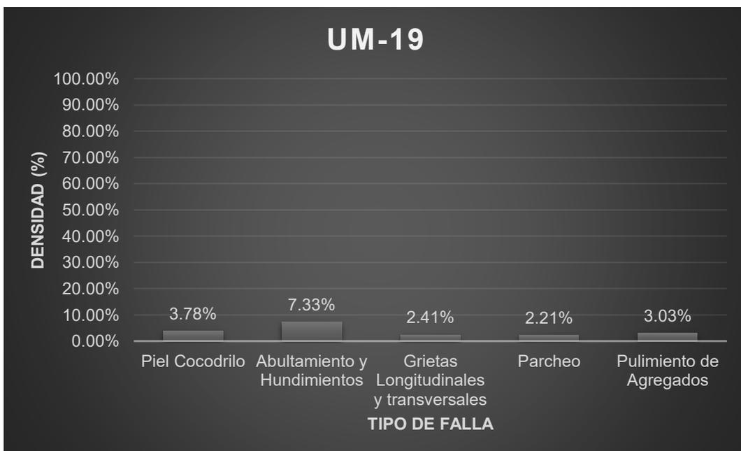
Figura 116. Densidad de las fallas en la progresiva (km): 0+720 – 0+760
