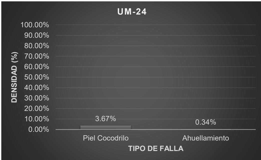
Figura 121. Densidad de las fallas en la progresiva (km): 0+920 – 0+960
