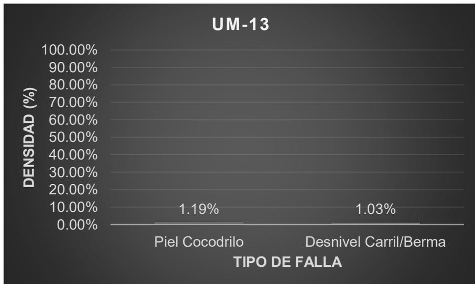
Figura 110. Densidad de las fallas en la progresiva (km): 0+480 – 0+520
