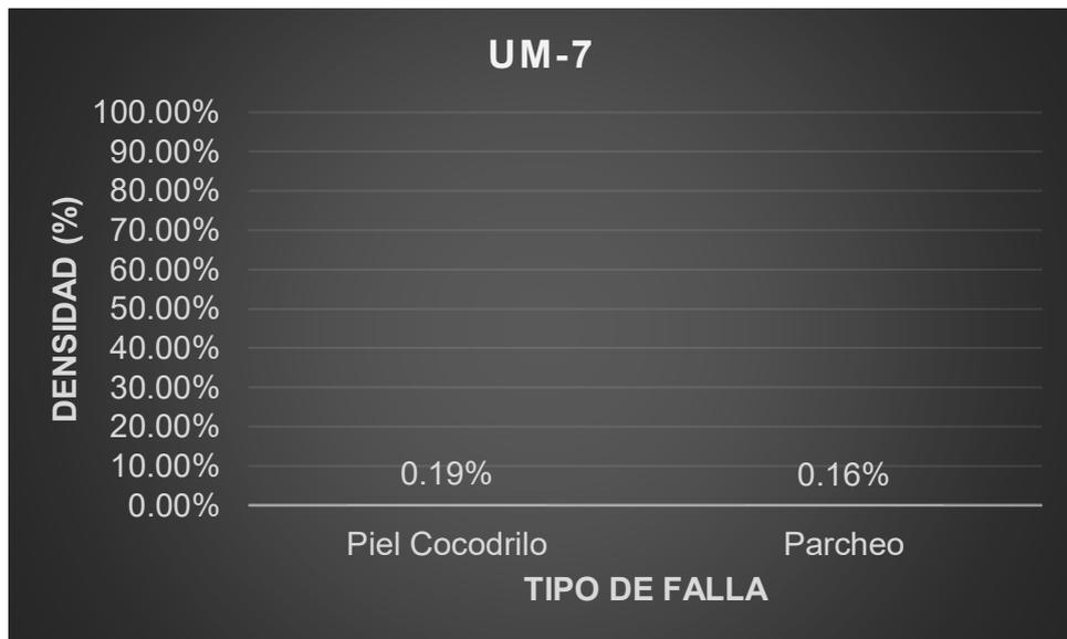
Figura 104. Densidad de las fallas en la progresiva (km): 0+240 – 0+280
