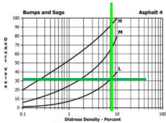
Figura 68. Curva de valor deducido – Abultamientos y Hundimientos - UM-19
