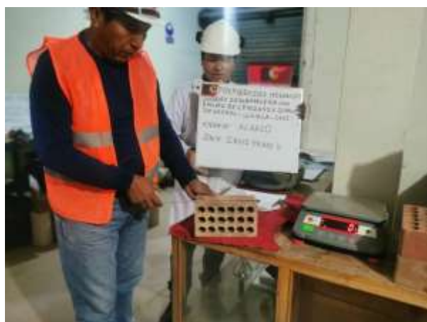
Figura 8. Ensayo de alabeo
