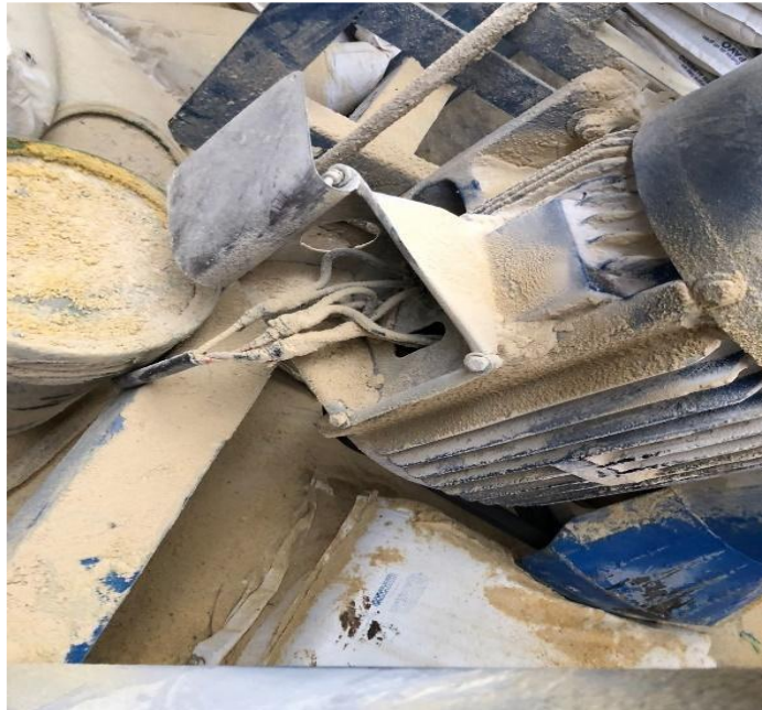
Figura 4: Mecanismo de maquinaria expuestos en el área de mezclado en la empresa "Molinos Sullana AB"
