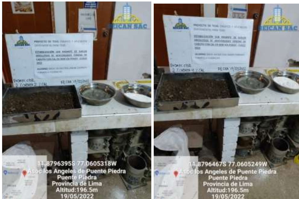
Material de trabajo, ceniza de cabuya, suelo arcilloso y cal hidratada
