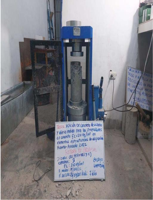
**Figura 18:** ensayo a la resistencia a la compresión con adición A. Fino(5%V.M) + A. Grueso (15% CR) para concreto  $f'c=210 \text{ Ka/cm}^2$
