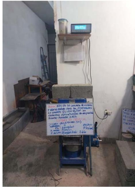
**Figura 20:** ensayo a la resistencia a la tracción con adición A. Fino(20%V.M) + A. Grueso (35% CR)  $f'c=210 \text{ Ka/cm}^2$
