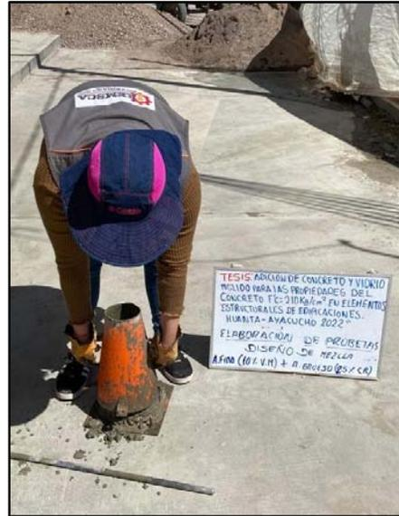
Figura 15. Ensayo del asentamiento de concreto.
