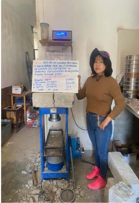
**Figura 17:** Ensayo de la resistencia a la flexión patrón
