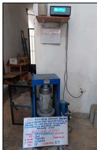
Figura 18. Prueba a la compresión del concreto (28 días).
