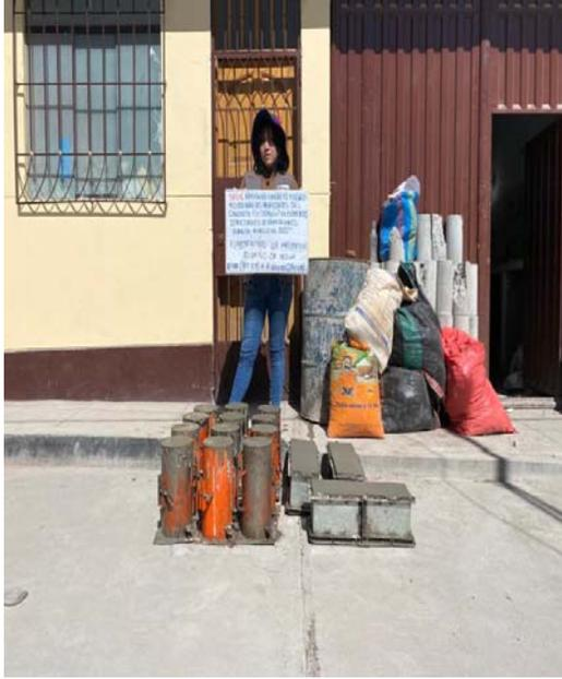
**Figura 13:** Elaboración de probetas y de vigas de concreto con adición A. Fino(10%V.M) + A. Grueso (25% CR) en  $f'c=210 \text{ Kg/cm}^2$
