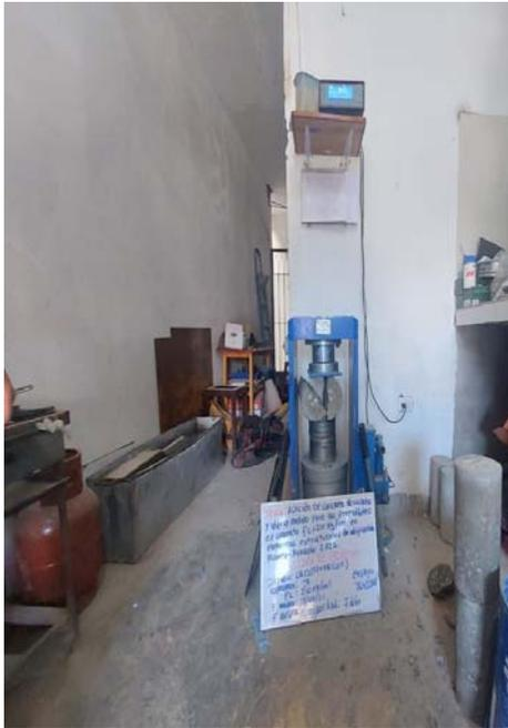
**Figura 20:** ensayo a la resistencia a la tracción con adición A. Fino(20%V.M) + A. Grueso (35% CR)  $f'c=210 \text{ Kg/cm}^2$
