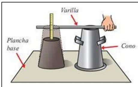
Figura 3. Ensayo del asentamiento slump.
