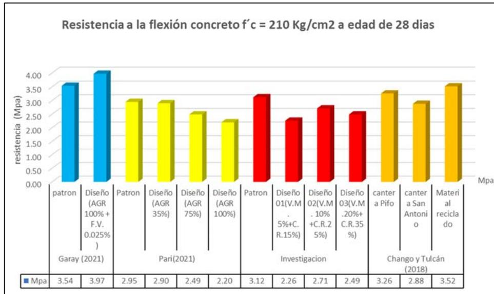
Figura 32. Valores de resistencia a la flexión  $f'c=210\text{kg/cm}^2$  para diferentes tipos de curado a edades de 28 días.
