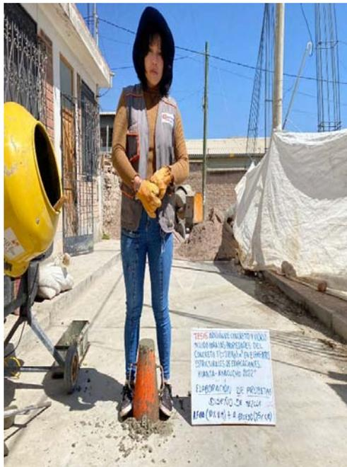
**Figura 11:** elaboración de la prueba de slump de la adición A. Fino(10%V.M) + A. Grueso (25% CR) para concreto  $f'c=210$  Kg/cm<sup>2</sup>
