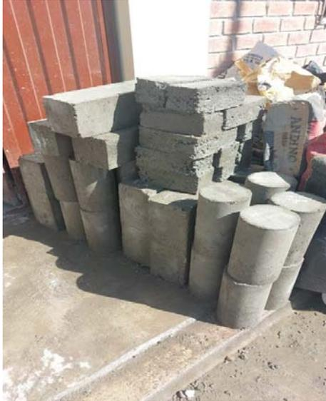
**Figura 05:** desmolde del concreto y vigas
