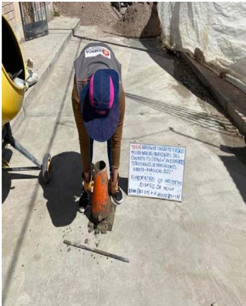
**Figura 15.** elaboración de la prueba de slump de la adición A. Fino(20%V.M) + A. Grueso (35% CR) para concreto  $f'c=210 \text{ Kg/cm}^2$
