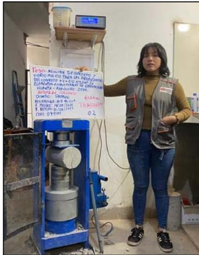
Figura 21. Prueba a la tracción del concreto (07 días).
