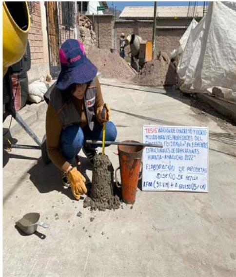
**Figura 07:** elaboración de la prueba de slump de la adición A. Fino(5%V.M) + A. Grueso (15% CR) para concreto  $f'c=210 \text{ Kg/cm}^2$
