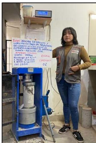
Figura 17. Prueba a la compresión del concreto (07 días).
