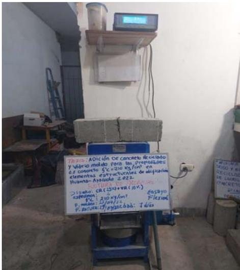
**Figura 19:** ensayo a la resistencia a la flexión con adición A. Fino(10%V.M) + A. Grueso (25% CR)
