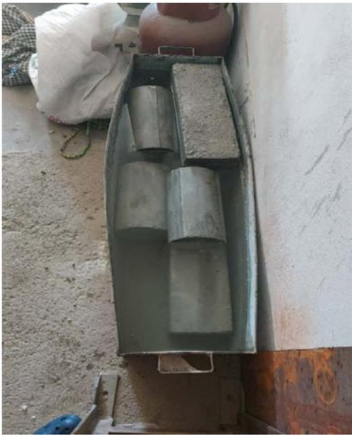
**Figura 14:** curado sumergido de probetas y vigas de concreto con adición A. Fino(10%V.M) + A. Grueso (25% CR) en  $f'c=210 \text{ Kg/cm}^2$
