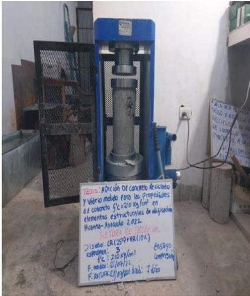
**Figura 17:** ensayo a la resistencia a la compresión con adición A. Fino(10%V.M) + A. Grueso (25% CR)  $f'c=210 \text{ Kg/cm}^2$
