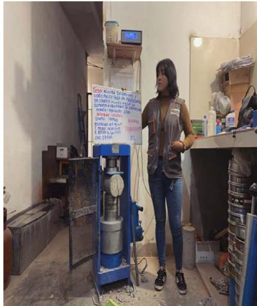
**Figura 20:** Ensayo de la resistencia a la Tracción de concreto patrón
