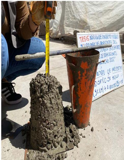
**Figura 16:** resultado del asentamiento de la adición A. Fino(20%V.M) + A. Grueso (35% CR) es 8.75 cm.
