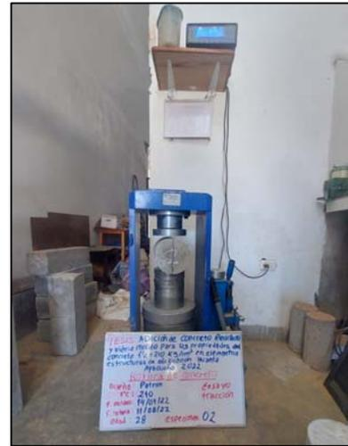
Figura 22. Prueba a la tracción del concreto (28 días).
