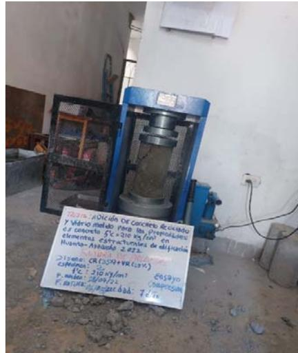
**Figura 20:** ensayo a la resistencia a la compresión con adición A. Fino(20%V.M) + A. Grueso (35% CR)  $f'c=210 \text{ Kg/cm}^2$
