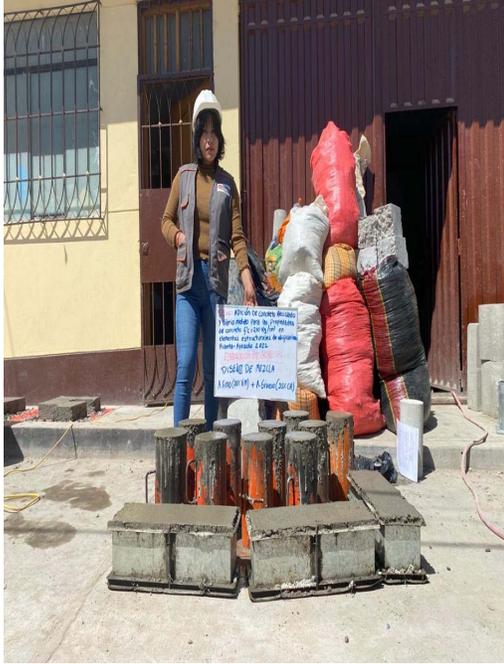
**Figura 17:** Elaboración de probetas y de vigas de concreto con adición A. Fino(20%V.M) + A. Grueso (35% CR) en  $f'c=210 \text{ Kg/cm}^2$
