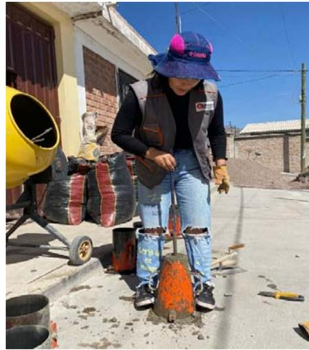
**Figura 02:** Elaboración de la prueba de slump de concreto patrón para  $f'c=210 \text{ Kg/cm}^2$  es 7.88cm.
