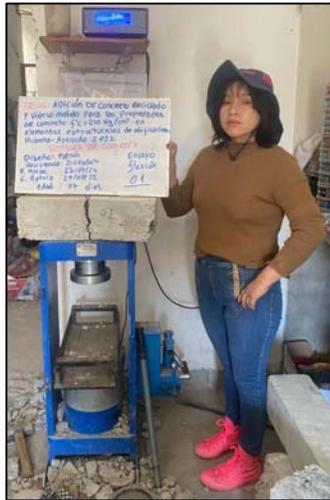
Figura 25. Prueba a la flexión del concreto (07 días).
