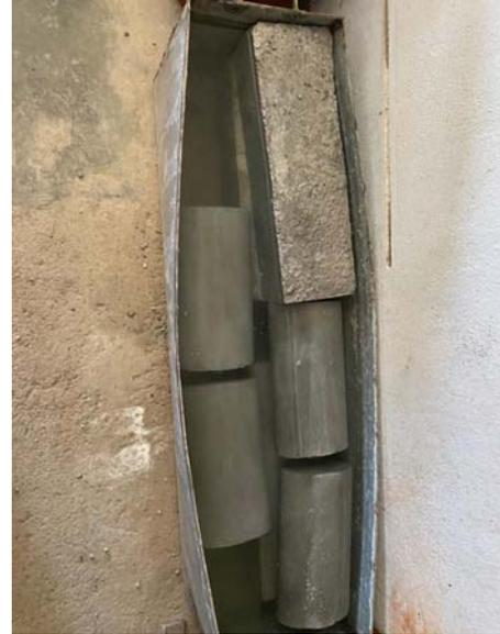
**Figura 06:** curado de concreto y vigas por sumergido
