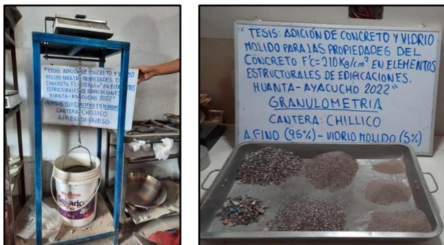
**Figura 09.** Prueba de laboratorio (absorción y peso específico).
