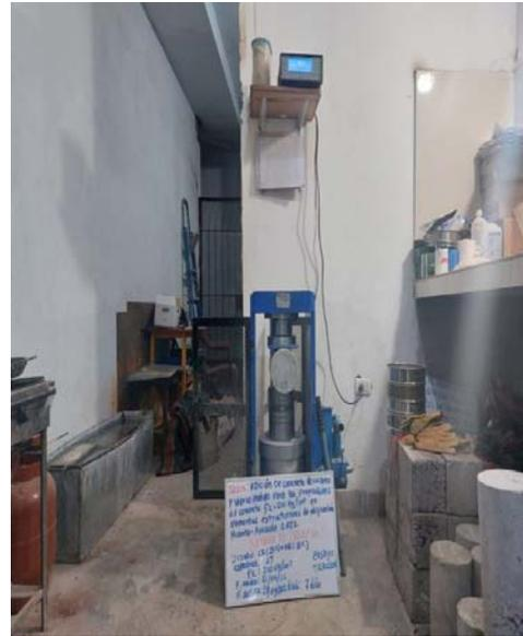
**Figura 18:** ensayo a la resistencia a la tracción con adición A. Fino(10%V.M) + A. Grueso (25% CR)
