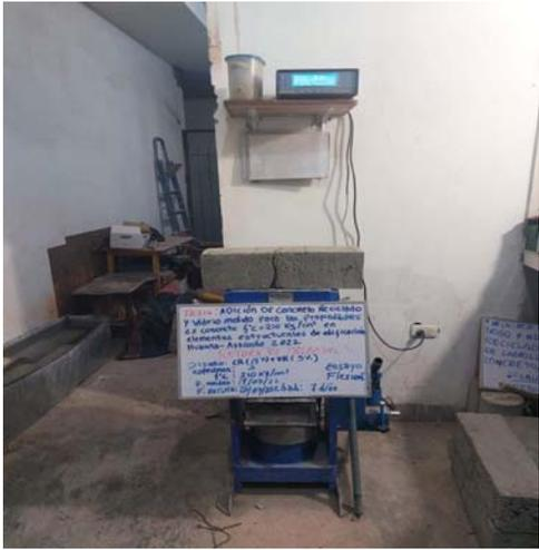
**Figura 20:** ensayo a la resistencia a la flexión con adición A. Fino(5%V.M) + A. Grueso (15% CR) .
