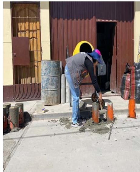
**Figura 04:** Elaboración de las probetas y vigas de concreto patrón para  $f'c=210 \text{ Kg/cm}^2$  en resistencias compresión, tracción y flexión
