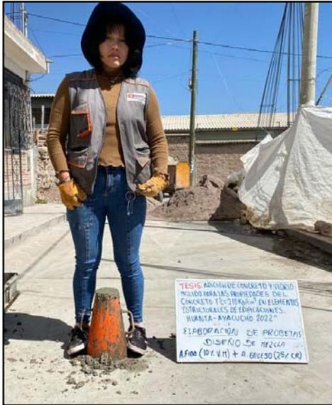
Figura 14. Ensayo del asentamiento de concreto.
