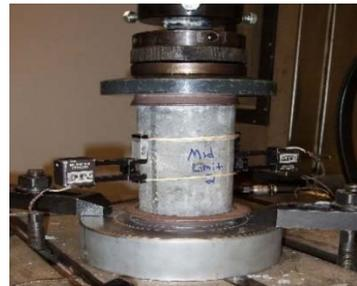
Figura 4. Ensayo a la compresión.
