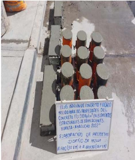
**Figura 09:** Elaboración de probetas y de vigas de concreto con adición A. Fino(5%V.M) + A. Grueso (15% CR) en  $f'c=210$
