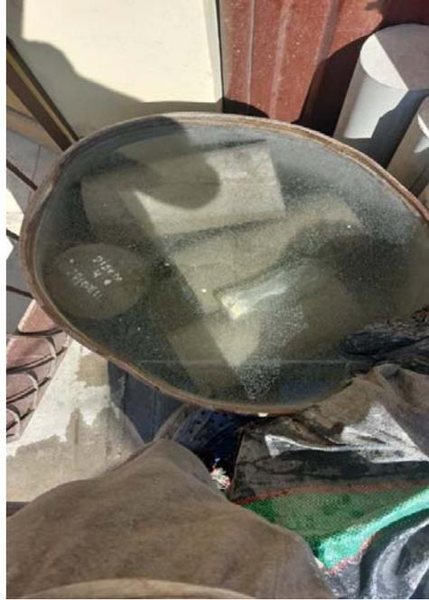
**Figura 18:** curado sumergido de probetas y vigas de concreto con adición A. Fino(20%V.M) + A. Grueso (35% CR) en  $f'c=210 \text{ Kg/cm}^2$
