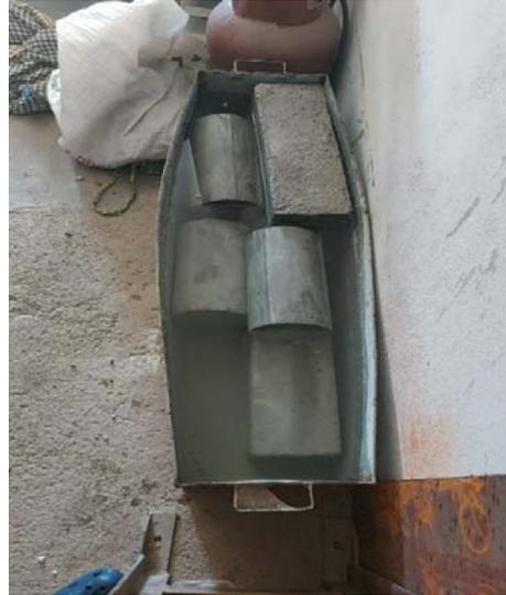
**Figura 10:** curado sumergido de probetas y vigas de concreto con adición A. Fino(5%V.M) + A. Grueso (15% CR) en  $f'c=210$  Kg/cm<sup>2</sup>
