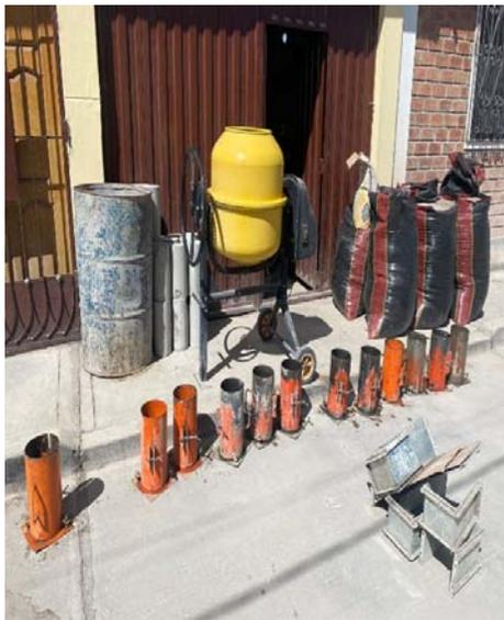
**Figura 03:** Preparación de los moldes para la elaboración del concreto  $f'c=210 \text{ Kg/cm}^2$ .
