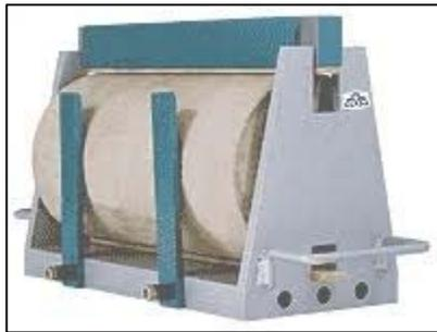
Figura 5. Ensayo de la resistencia a la tracción.
