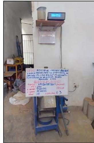
Figura 26. Prueba a la flexión del concreto (28 días).
