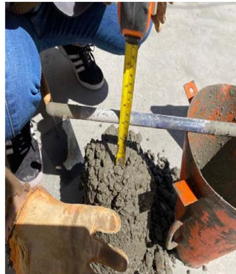
**Figura 08:** resultado del asentamiento de la adición A. Fino(5%V.M) + A. Grueso (15% CR) 8.88 cm.
