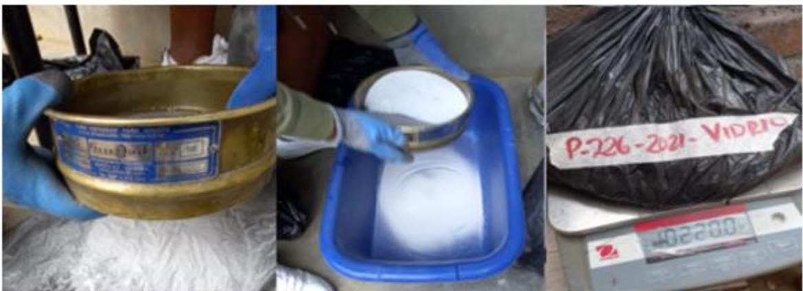
**Figura 12:** Tamizado, recolección y pesaje del polvo de vidrio reciclado
