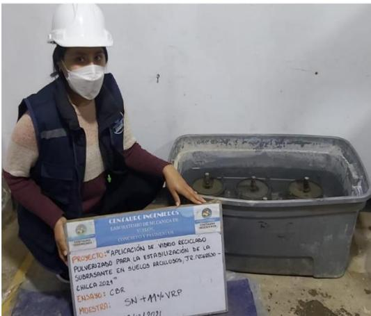
Foto 14: Saturación de los moldes de CBR.
