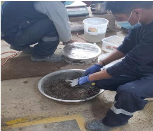
Foto 9: Mezcla de SN + 4%VRP para Ensayo de Proctor modificado.
