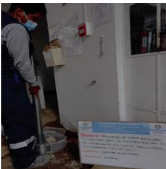
**Figura 23:** Ensayo de Proctor modificado – Patrón (SN)
