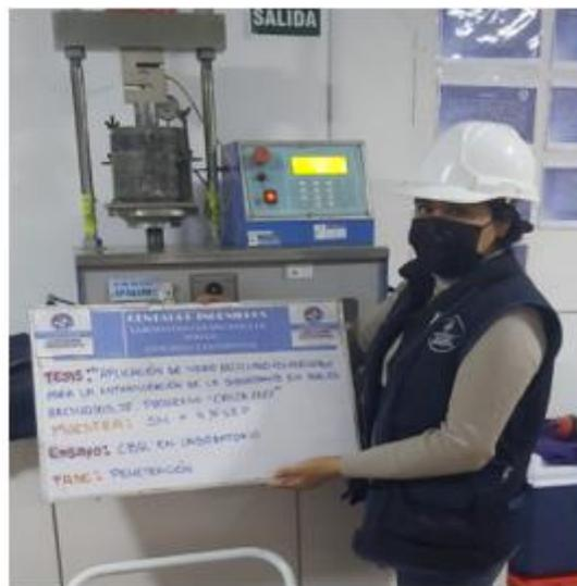
**Figura 28:** Ensayo de CBR - Penetración
