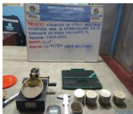
**Figura 21:** Ensayo de Límites de Atterberg – SN+4%VRP
