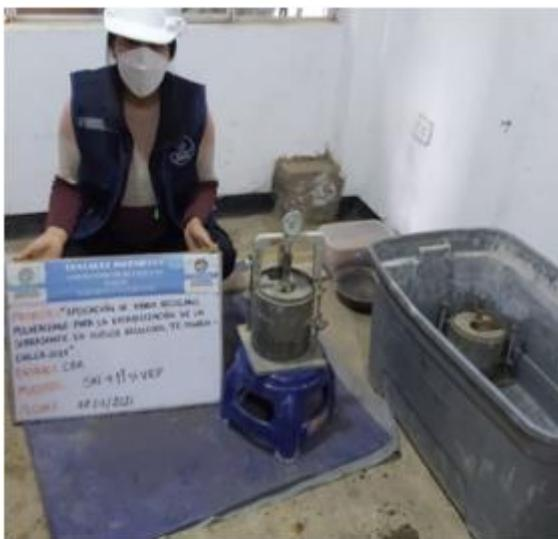
**Figura 27:** Ensayo de CBR – Saturación
