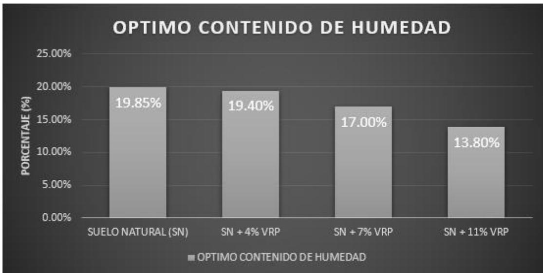
**Figura 25:** Gráfico de Proctor modificado (OCH) con dosificaciones de VRP
