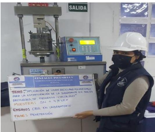
Foto 16: Penetración del SN+4%VRP
