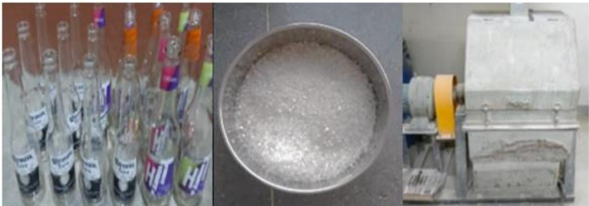
**Figura 11:** Reciclaje de botellas de vidrio, triturado y molienda
