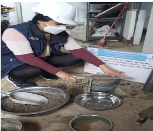
Foto 11: Enrasado del molde para el Proctor modificado.
