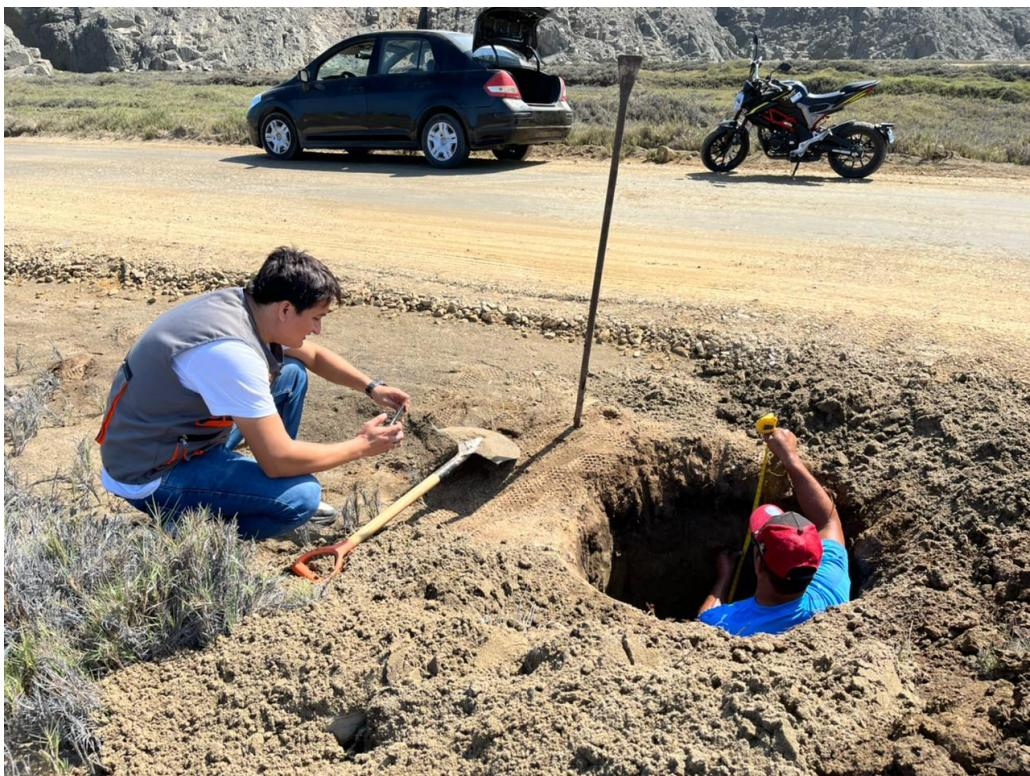
Imagen 09: Las calicatas se realizaron con una profundidad de 1.50m tal como exige la normativa vigente del MTC.
