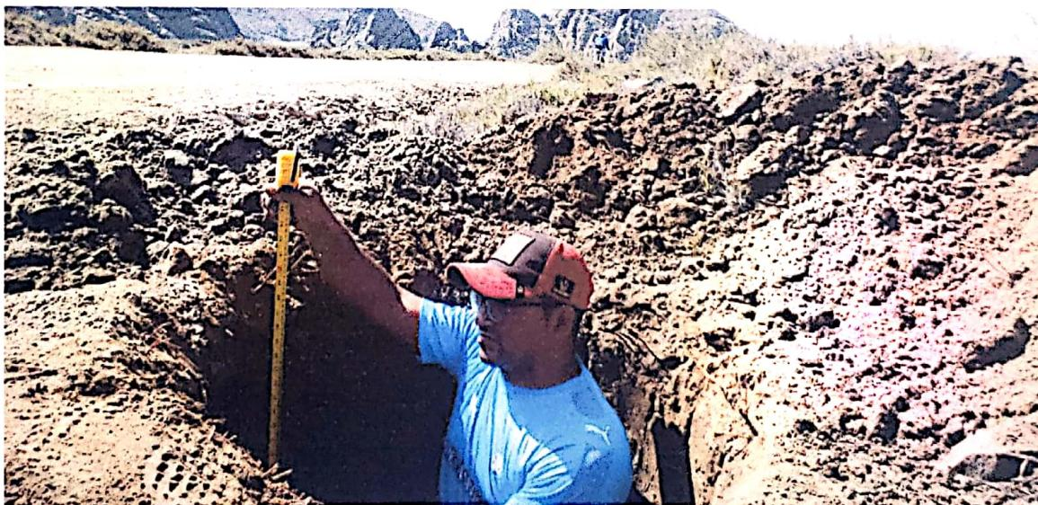
En la imagen se aprecia la realización de la calicata para la toma de muestra a una profundidad de 1.50 m
