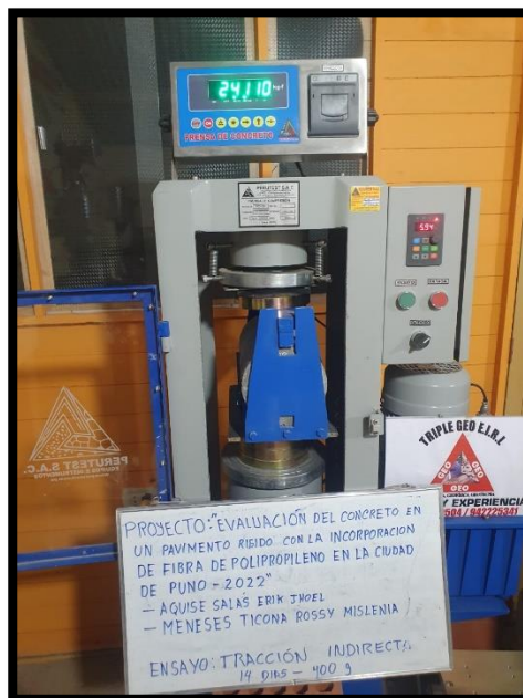
Figura 20. Ensayo de resistencia a la tracción por el método brasileño,
