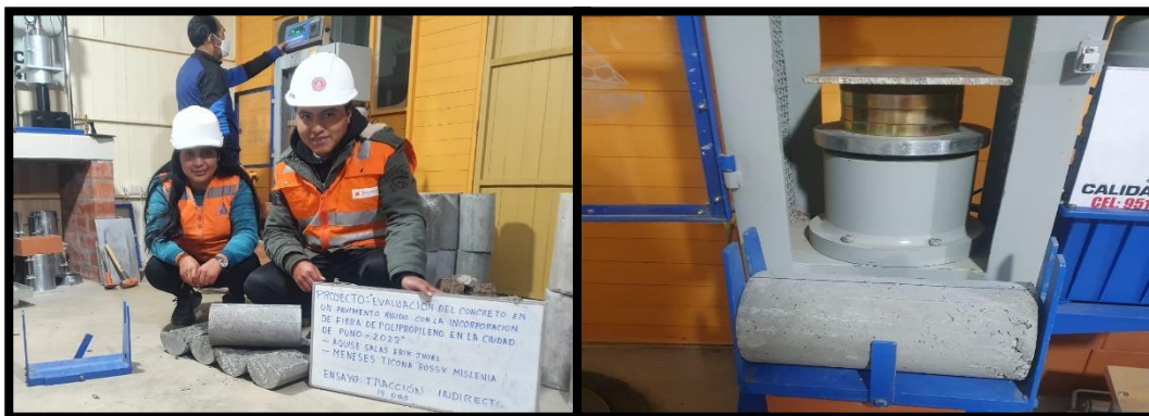
Ilustración n° 9: se observa el inicio de rotura de las muestras a la resistencia a tracción indirecta del concreto convencional y incorporado con fibras de polipropileno
