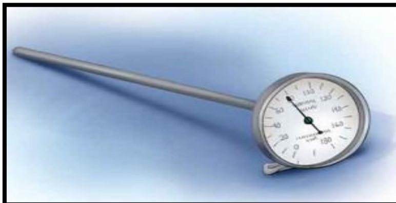
Figura 6. Aparato para la medición de la temperatura del concreto
