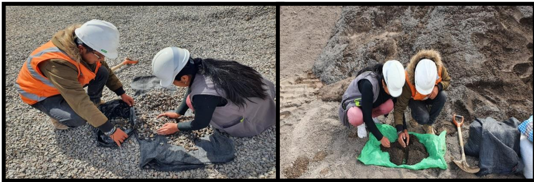
Ilustración n°2: según la norma NTP 400.010 nos indica para la extracción de la muestra, en la imagen observamos el cuarteo y extracción del agregado grueso y fino (piedra chancada y arena gruesa) en una bolsa de plástico para mantener su contenido de humedad para analizarlo en el laboratorio
