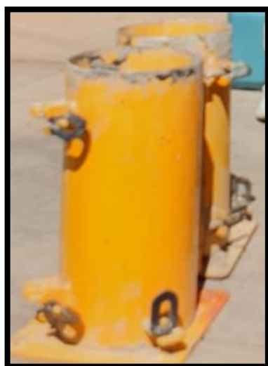
Figura 7. Molde para la elaboración de briquetas cilíndricas.
