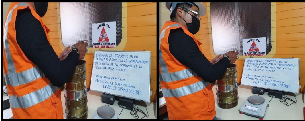
Ilustración n°4: En la figura se observa la elaboración del ensayo de granulometría de los agregados
