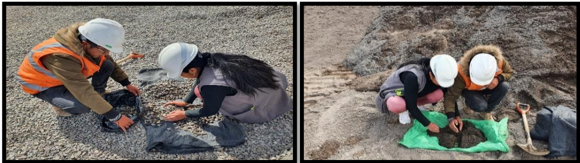
Figura 26. Extracción de muestras de agregados.
