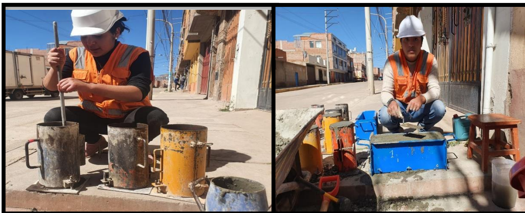
Ilustración n° 6: se observa la colocación del concreto en moldes de 0.15 cm de diametro y 0.30cm de altura, en el molde de la viga de siguiendo los procedimientos de colocado para su consolidacion.
