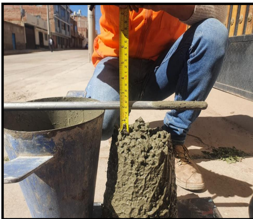
Figura 5. Prueba de asentamiento según norma NTP 339 035.
