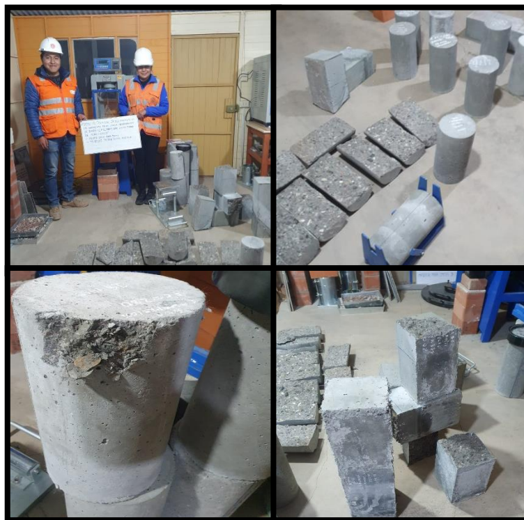
lustracion n° 11: se observa a las muestras con los diferentes tipos de fallas al ser sometidas a esfuerzos de compresion, flexion y traccion indirecta, en el ensayo a compresion se aprecia la fractura de tipo 5, para el ensayo a la traccion indirecta se observa una falla a traccion normal ya que se dividio en dos partes iguales.
