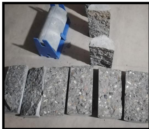
Figura 31. Fracturas de la resistencia a tracción indirecta
