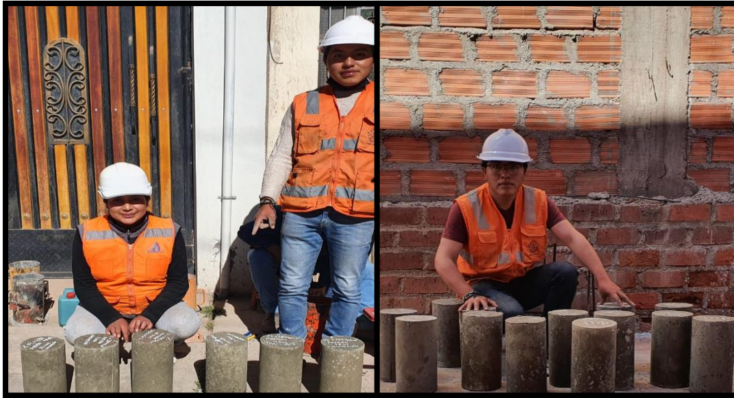
Ilustración n°7: Se realiza el desencofrado de las briquetas convencionales y incorporado con fibras de polipropileno para sus respectivos curados a los 7, 14 y 28 días
