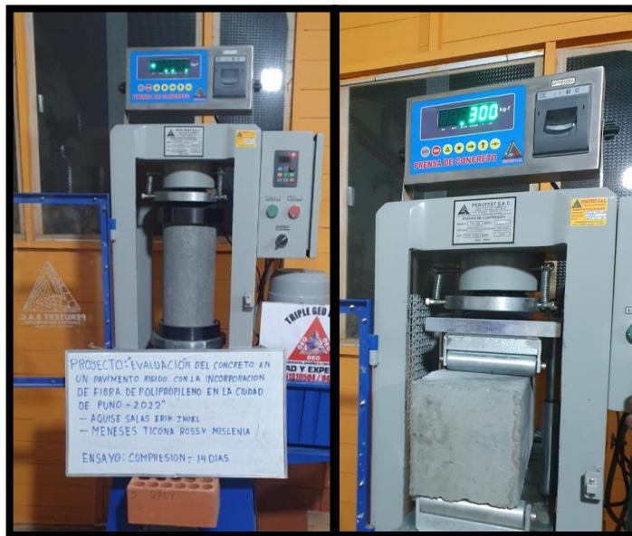
Figura 30. Resistencia a esfuerzos sometidos a compresión y flexión
