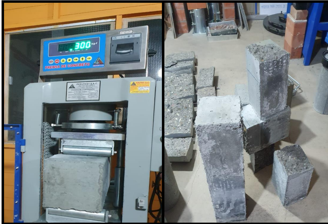
lustracion n° 10: se observa la rotura de las muestras a la resistencia a flexion del concreto convencional y incorporado con fibras de polipropileno
