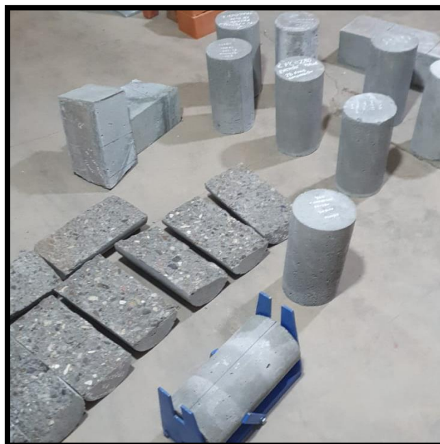
Figura 23. Tipo de falla - tracción normal.
