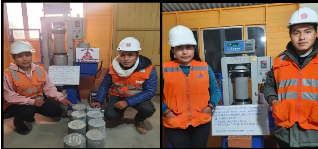
Ilustración n°8: se observa el inicio de rotura de las muestras a la resistencia a compresión del concreto convencional y incorporado con fibras de polipropileno
