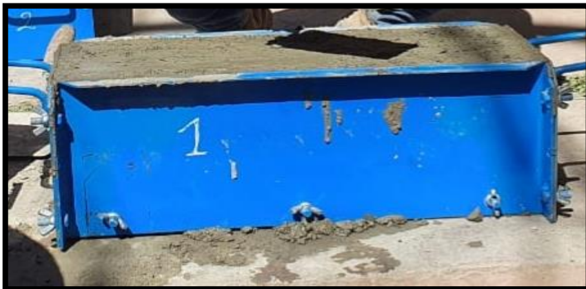
Figura 15. Molde de viga para resistencia a la flexión.
