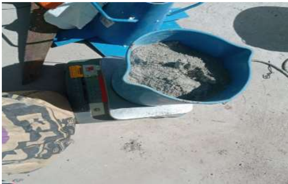
Fotografía 18 pesado de cemento según dosificación de la mezcla.
