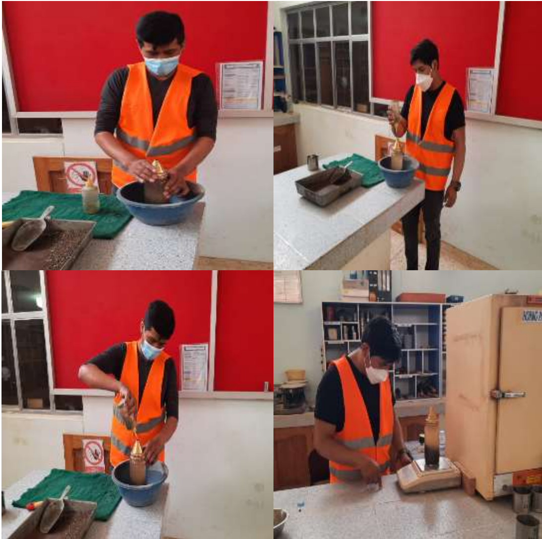
Fotografía 14 Ensayo de Cono Truncado.
