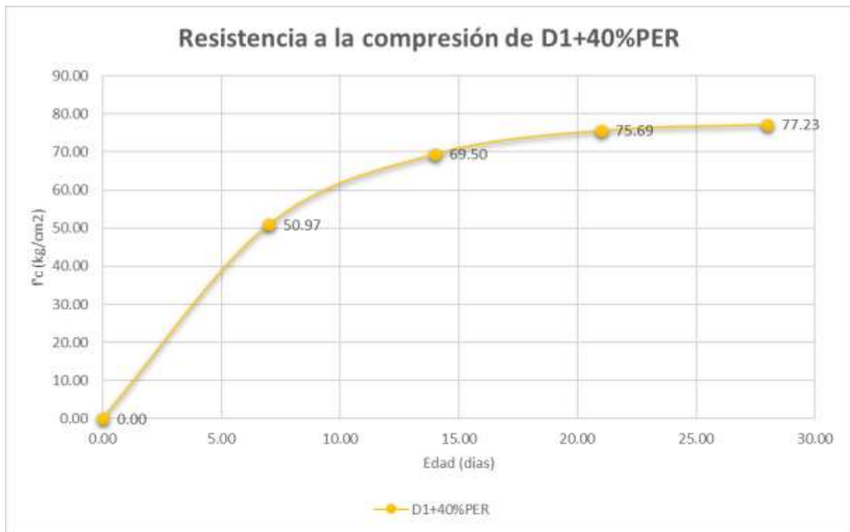
Figura 6 representación gráfica de f'_b a diferentes edades de diseño 1 + 40%PER.
