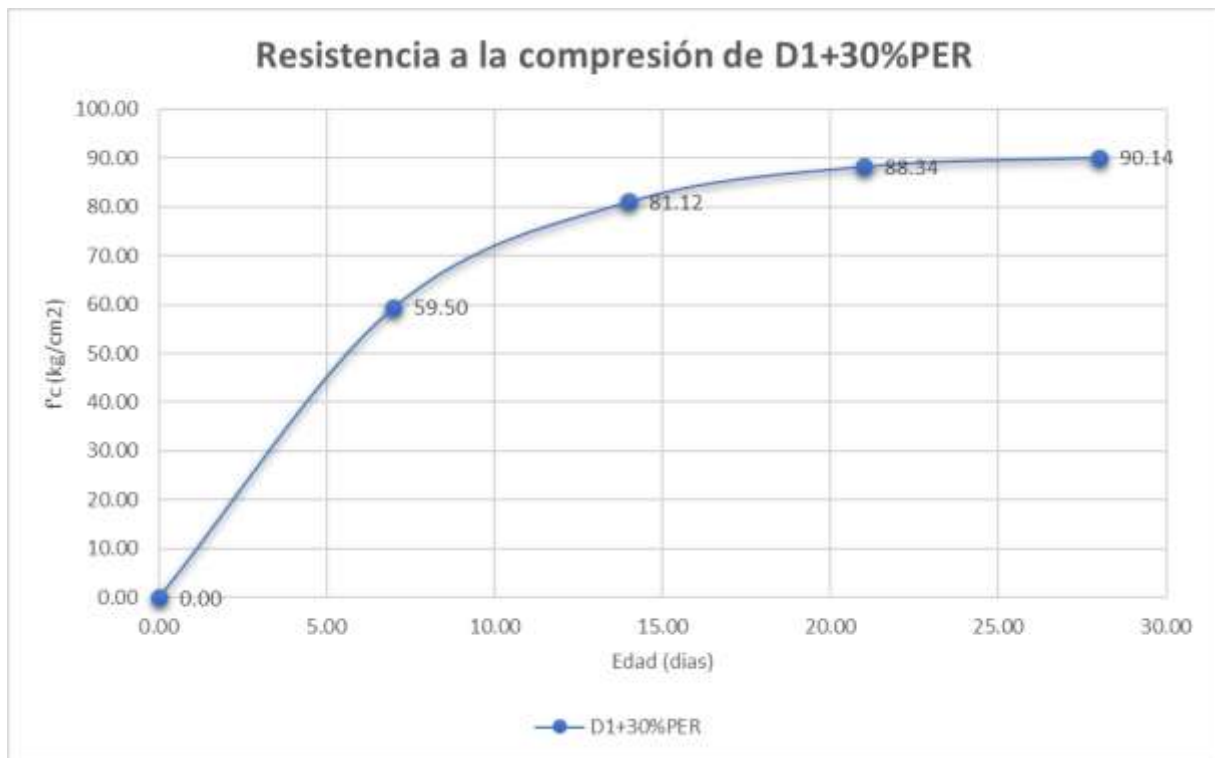
Figura 5 representación gráfica de f'_b a diferentes edades de diseño 1 + 30%PER.
