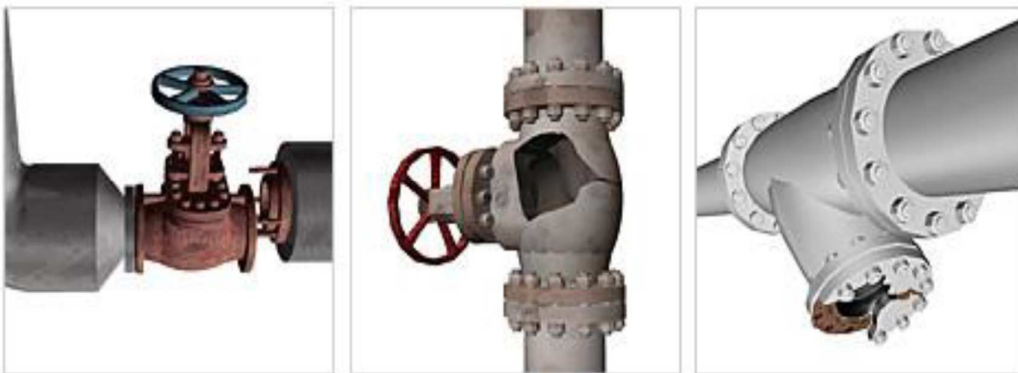
Imagen 02: daños causados por el golpe de ariete.
