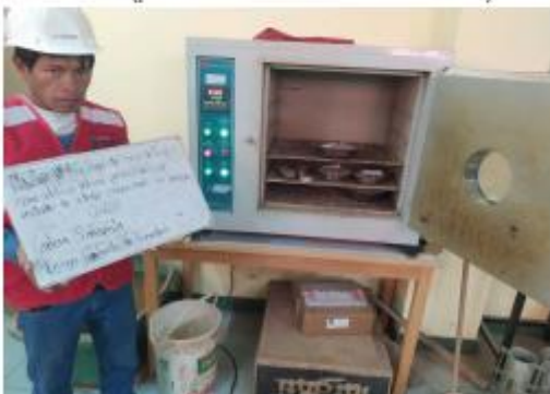
Figura 7: Ensayo de contenido de % de humedad del suelo
