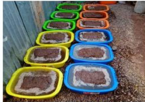
Figura 4: Adobes sumergidos en agua durante 24 horas (ensayo de resistencia a la absorción)
