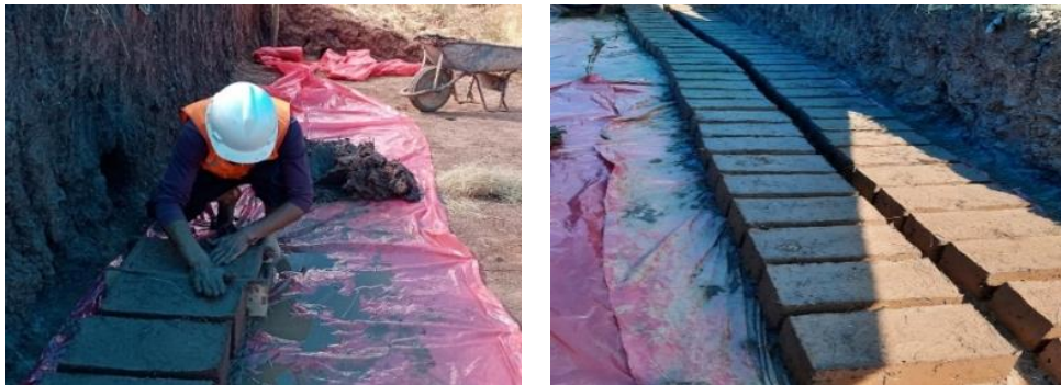
Figura 26. Proceso de elaboración y secado del adobe
