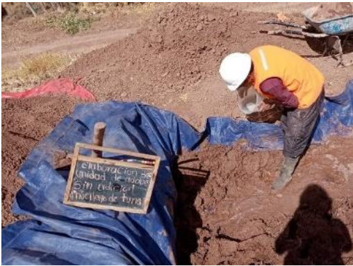
Figura 24. Mezcla de adobe sin adición y con 30% de mucílago de tuna
