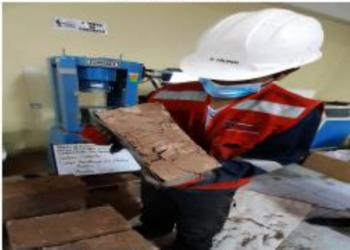
Figura 3: Rotura del ensayo esfuerzo máximo a la flexión (Mr)
