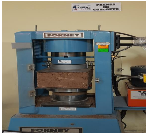
Figura 12. Ensayo de resistencia a la flexión del adobe Fuente: Autoría propia
