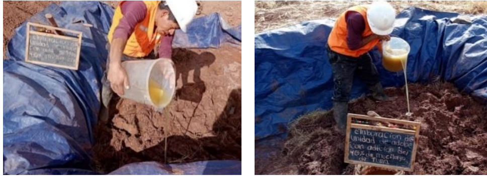
Figura 25. Mezcla con adición del 60% y 90% de mucílago de tuna
