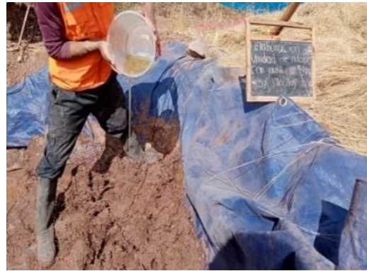
Figura 24. Mezcla de adobe sin adición y con 30% de mucílago de tuna
