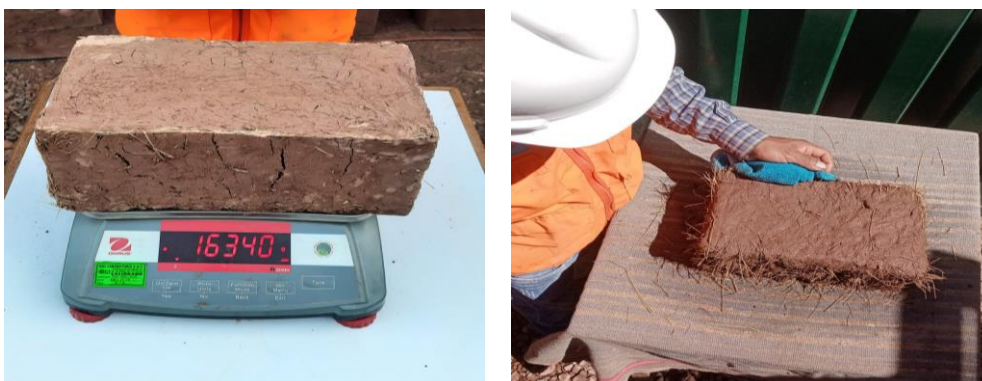
Figura 14. Ensayo de resistencia a la absorción del adobe Fuente: Autoría Propia
