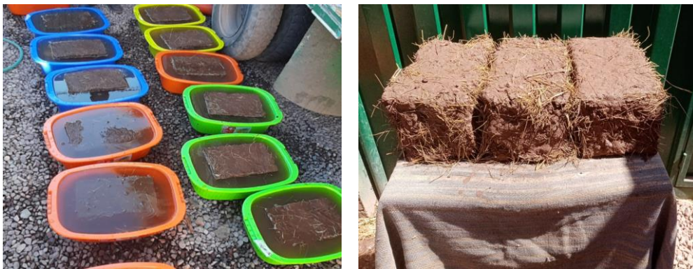
Figura 15. Ensayo de resistencia a la inmersión del adobe
