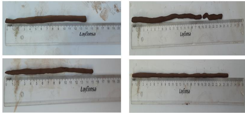
Figura 16. Prueba de cinta de barro
