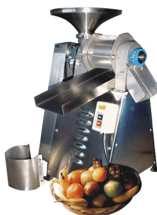
Figura 4: Despulpadora horizontal de tornillo sin fin.
