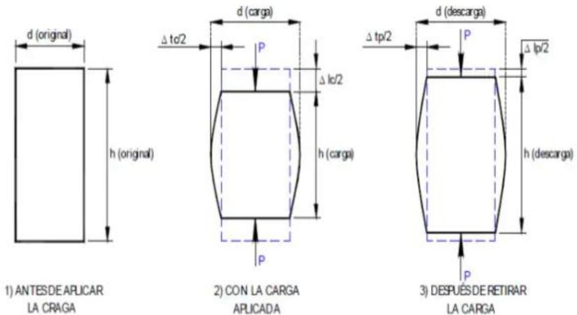
Figura 13. Representación de los especímenes cilíndricos durante el proceso de cálculo del módulo de elasticidad.
