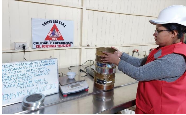
Figura 21. Ensayo de granulometría
