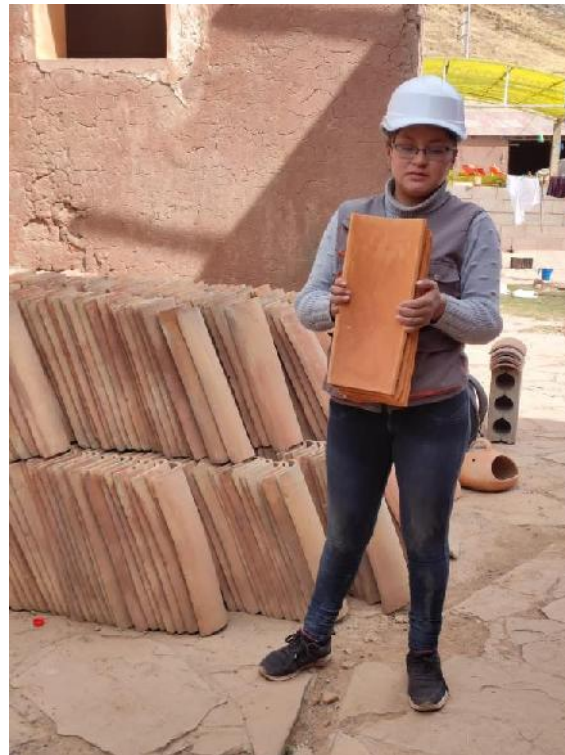
FOTOGRAFÍA 6 – Tejas elaboradas con adición de ladrillo artesanal
