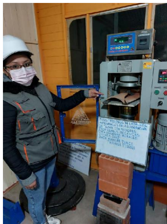
FOTOGRAFÍA 8 – Ensayo de flexión de las tejas
