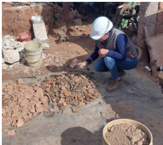
Figura 7. Trituración con uso de herramienta manual
