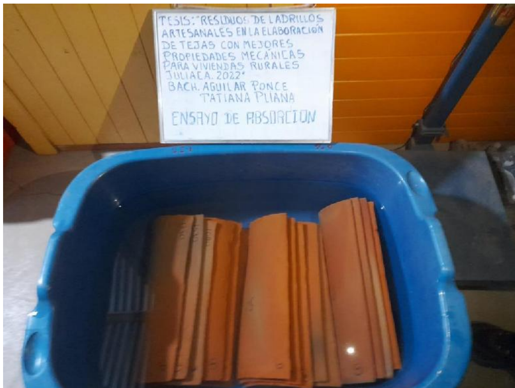
FOTOGRAFÍA 10 – Ensayo de absorción de las tejas
