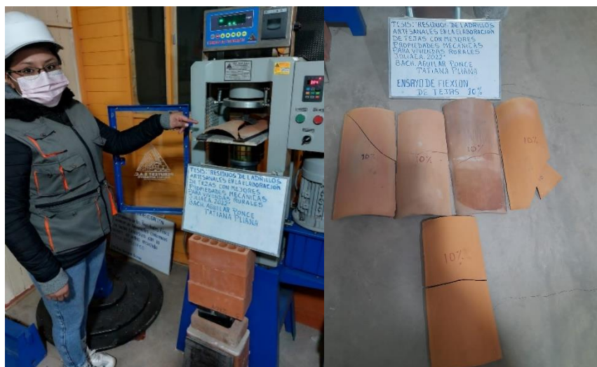
Figura 23. Ensayo de resistencia a la flexión de tejas
