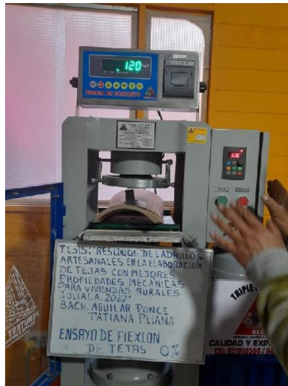
FOTOGRAFÍA 8 – Ensayo de flexión de las tejas
