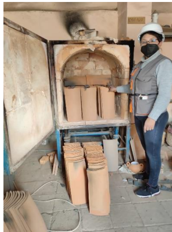
Figura 18. Extracción de tejas del horno
