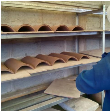
Figura 15. Almacenaje de tejas en andamios
