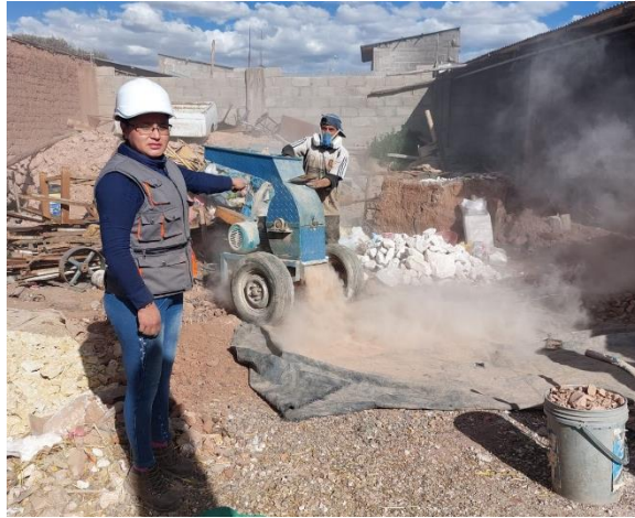
Figura 8. Trituración con uso de maquina moledora
