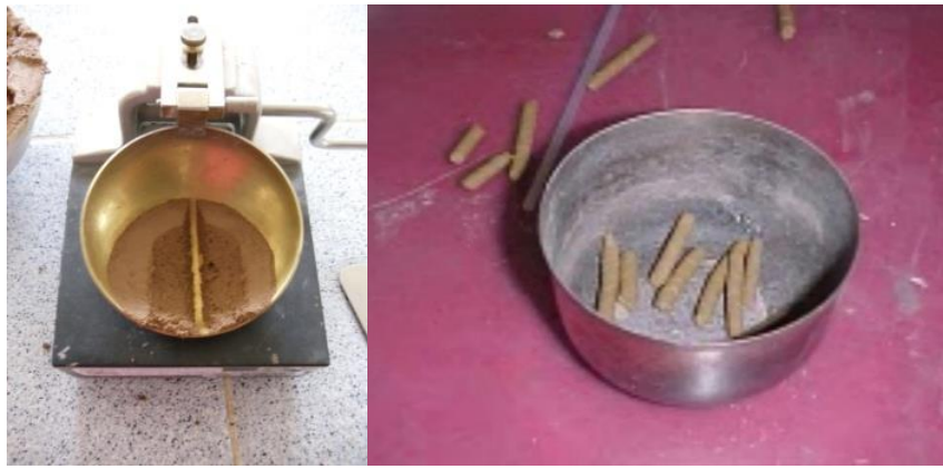
Figura 22. Ensayos de límites de consistencia
