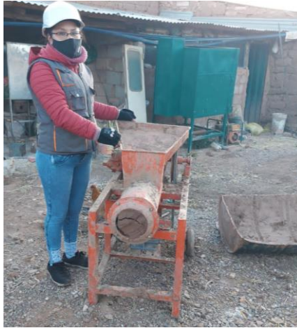
Figura 12. Fabricación de la pasta para elaborar tejas
