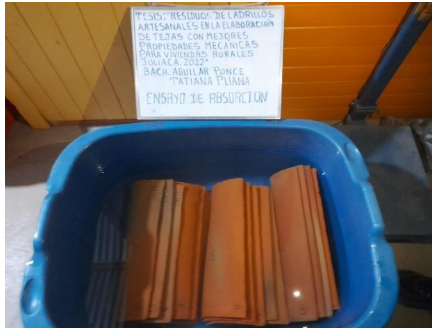
Figura 24. Ensayo de absorción de tejas
