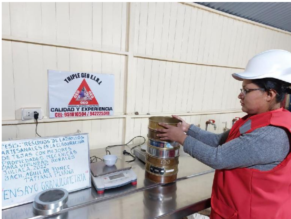
FOTOGRAFÍA 4 – Ensayo de granulometría de material arcilloso
