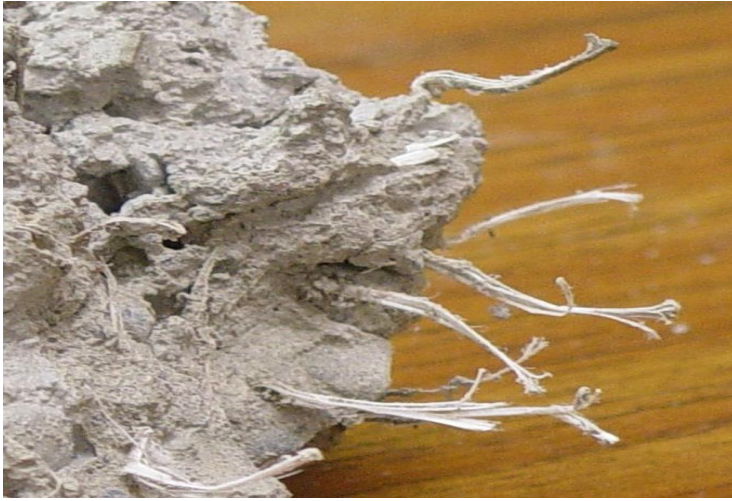
FOTOFRAFIA 3 CONCRETO CON FIBRA DE POLIPROPILENO
