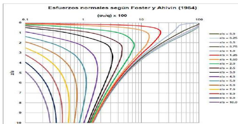
Figura 3. Tensiones verticales debido a la carga circular (Foster y Ahlyn)
