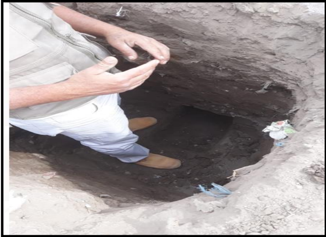
Foto 5. Procedimiento visual manual de caracterización de suelos en situ
