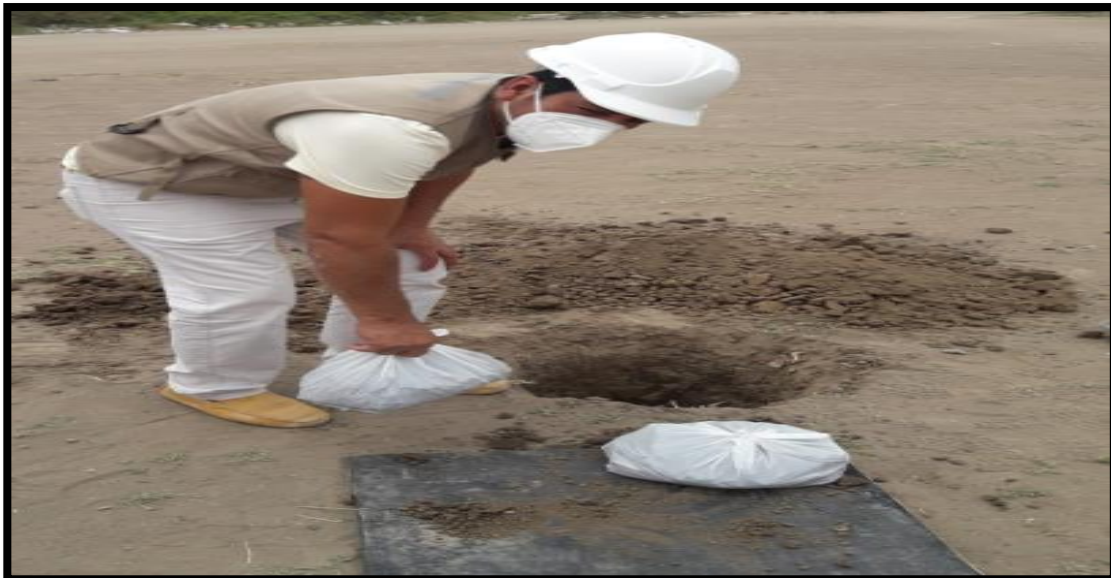
Foto 6. Procedimiento de extracción de muestras alteradas
