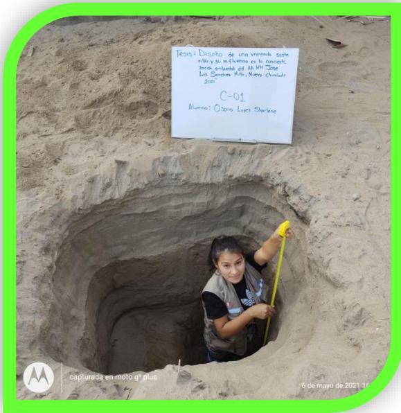
*Foto N°04: Se visualiza a la alumna Osorio Lopez Sharlene en trabajos de la medición de profundidad de 1.80 m. de la **Cn°01***
