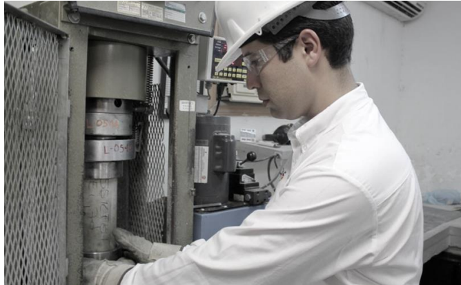
Figura 2 prueba de compresión
