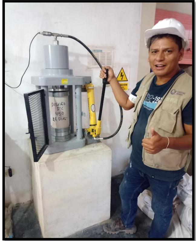
En la presente imagen se puede ver la colocación de las probetas a la prensa hidráulica para el procedimiento de ruptura
