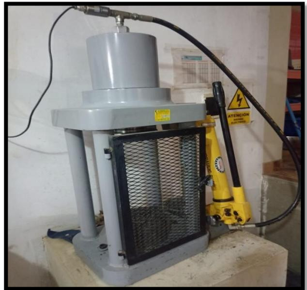
En la presente imagen se puede ver la colocación de las probetas a la prensa hidráulica para el procedimiento de ruptura
