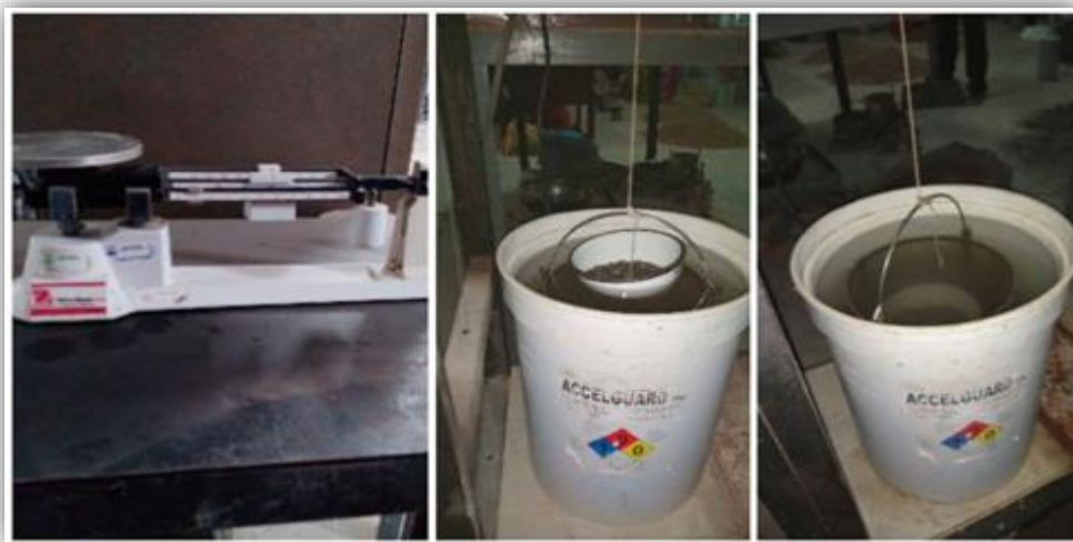
Foto N°08: Ensayo de gravedad específica y absorción del agregado grueso.
