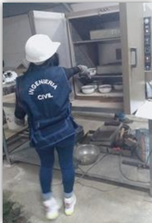
Foto N°04: Retirando las muestras del horno.
