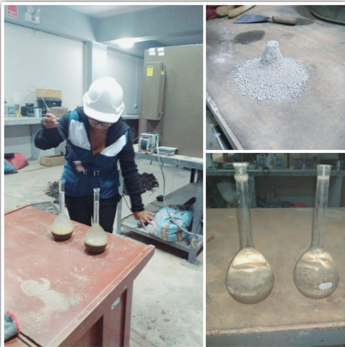
Foto N°07: Ensayo de gravedad específica y absorción del agregado fino.
