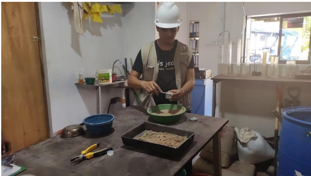
Imagen N° 06: Se aprecia la selección del agregado, en este caso la arena fina.
