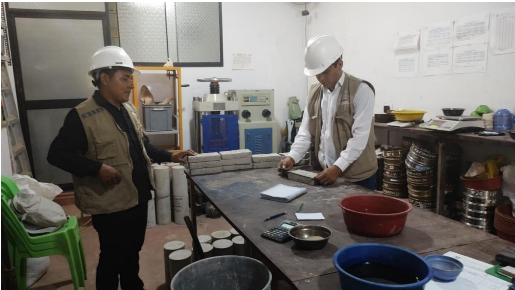
Imagen N° 12: Se verifica cada unidad con las dimensiones exactas.
