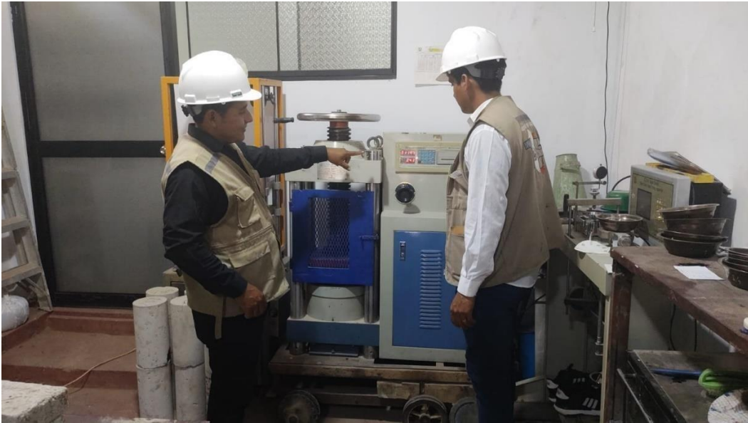
Imagen N° 11: Se aprecia la colocación de los últimos bloques para el ensayo a compresión.
