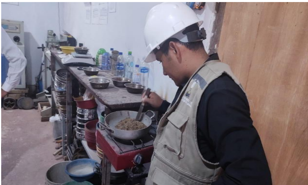
Imagen N° 01: Se aprecia al secado de la arena seleccionada para el diseño.
