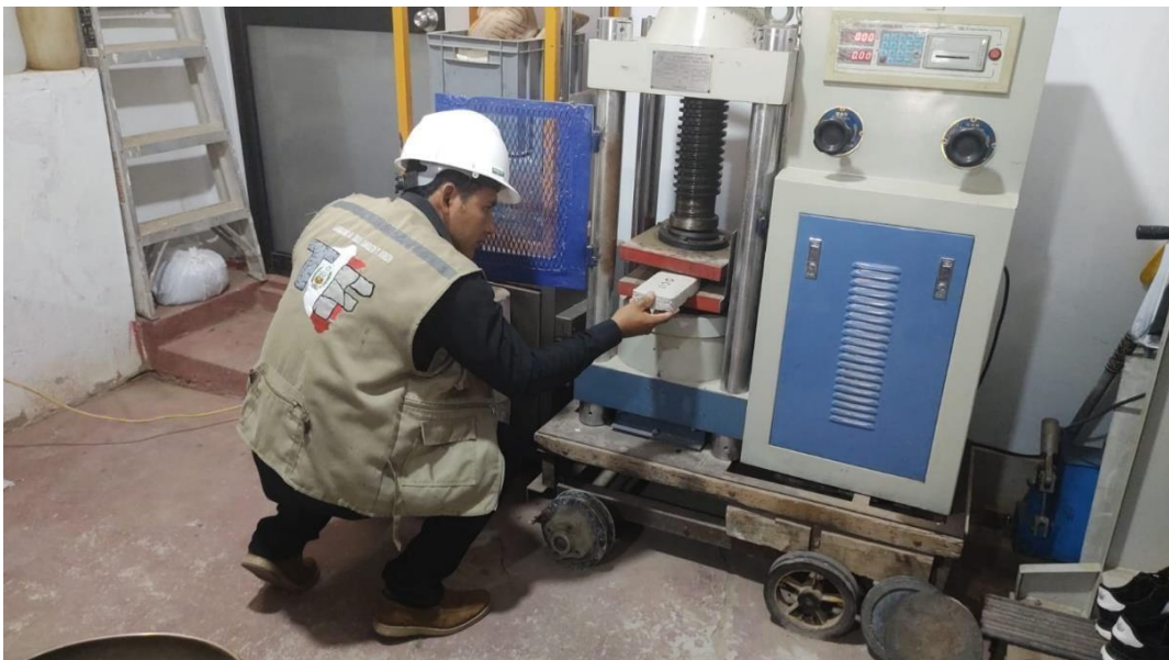
Imagen N° 10: Se aprecia la colocación de los diferentes bloques a la prensadora para el ensayo a compresión.
