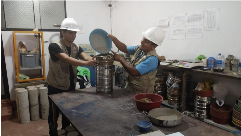
Imagen N° 03: Se aprecia el tamizado del agregado en este caso la arena fina.
