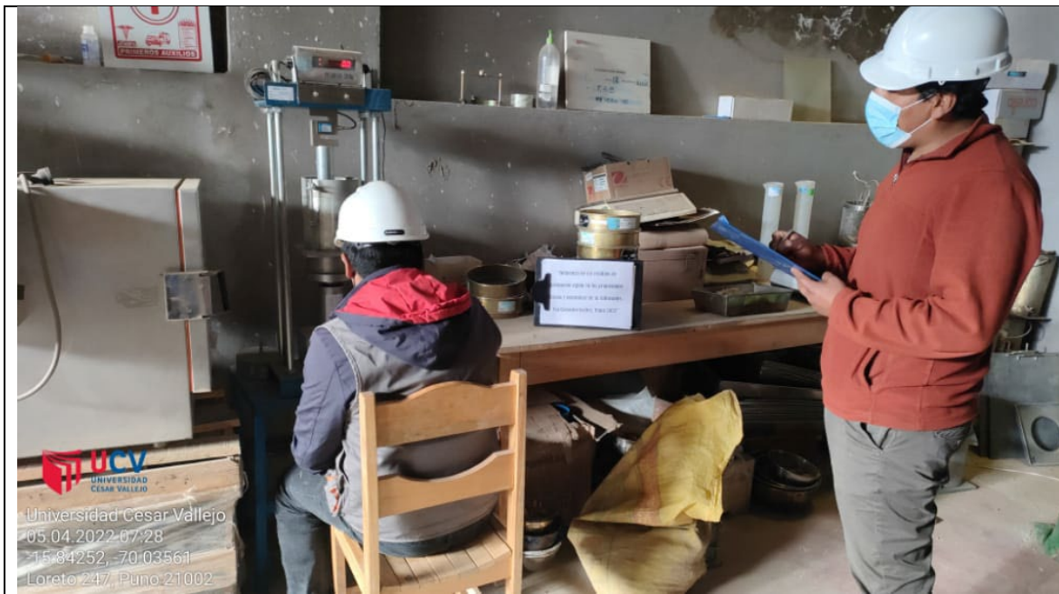
Figura 11. Ensayo de CBR
