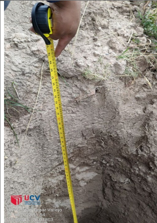
Figura 05. Profundidad de 1.50m calicata 1
