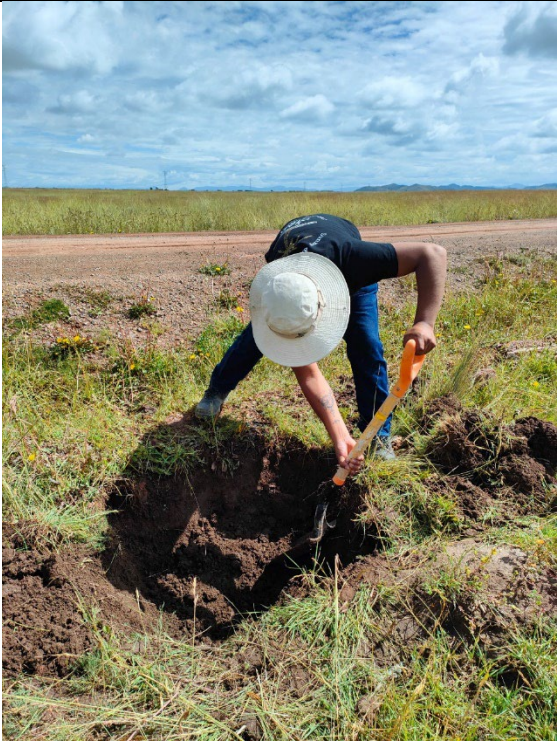
Figura 04. Excavación de la calicata 1
