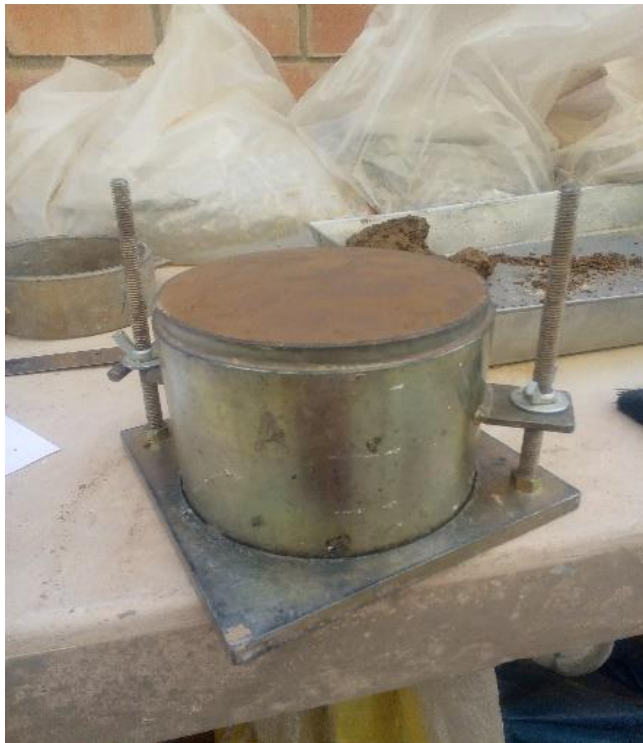
COMPACTACIÓN, COLOCACIÓN Y ENRASE DE LA MUESTRA.
