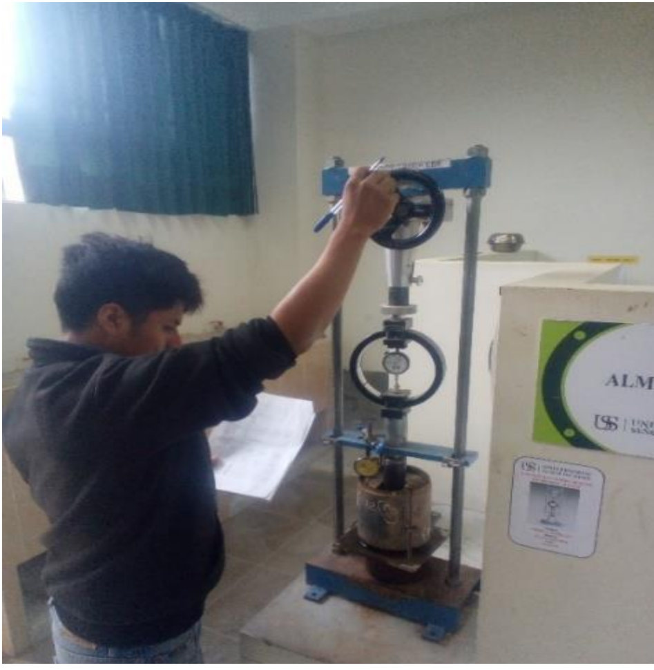
PROCEDIMIENTO PARA EL ENSAYO DE PENETRACIÓN CBR.
