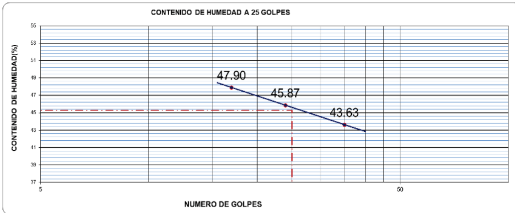
Figura 29. Representación gráfica del ensayo de Límite Líquido, calicata 2.
