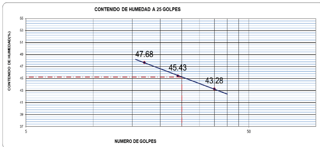
Figura 28. Representación gráfica del ensayo de Límite Líquido, calicata 1.
