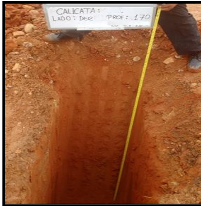
Figura 28: Excavación de calicata para obtener las muestras
