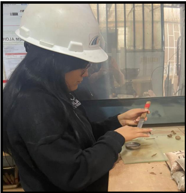
Figura 31: Proceso para determina el límite plástico
