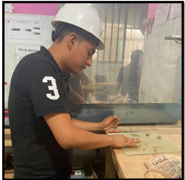
Figura 31: Proceso para determina el límite plástico
