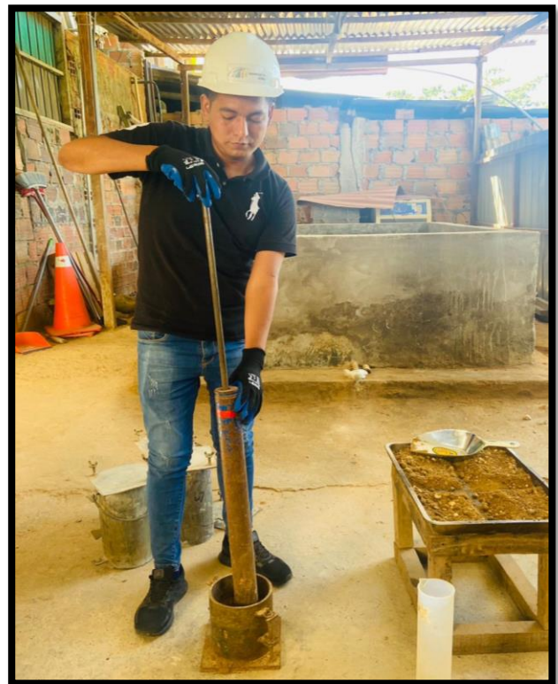
Figura 33: Prueba de proctor modificado
