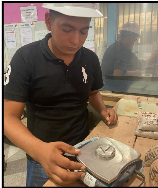
Figura 32: Pesado de muestra para determinar el límite plástico
