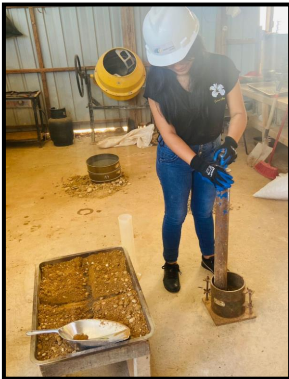
Figura 33: Prueba de proctor modificado
