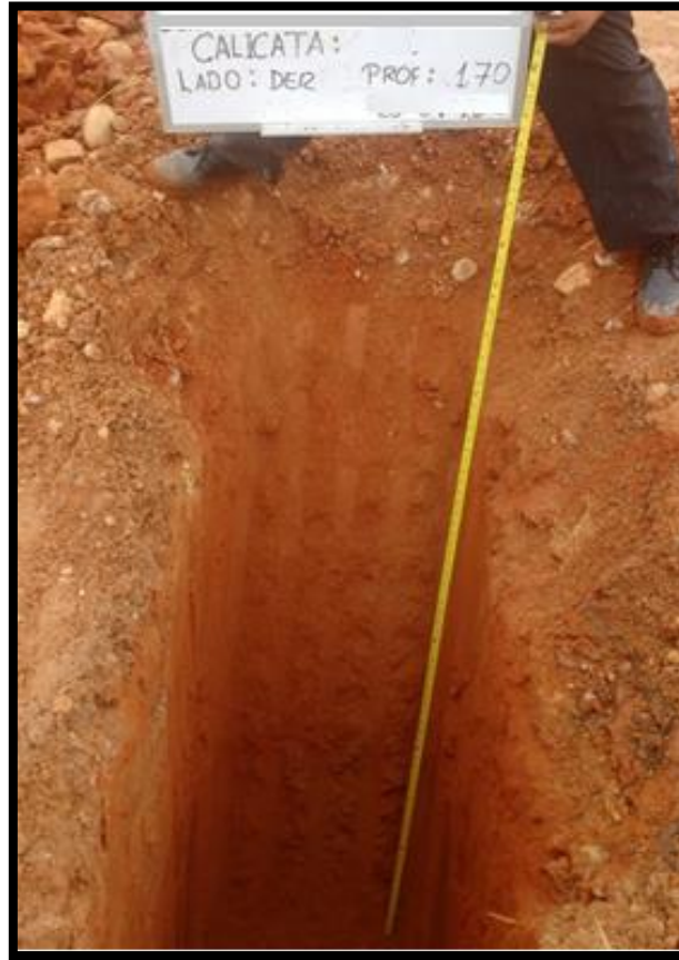
Figura 4: Excavación de calicata
