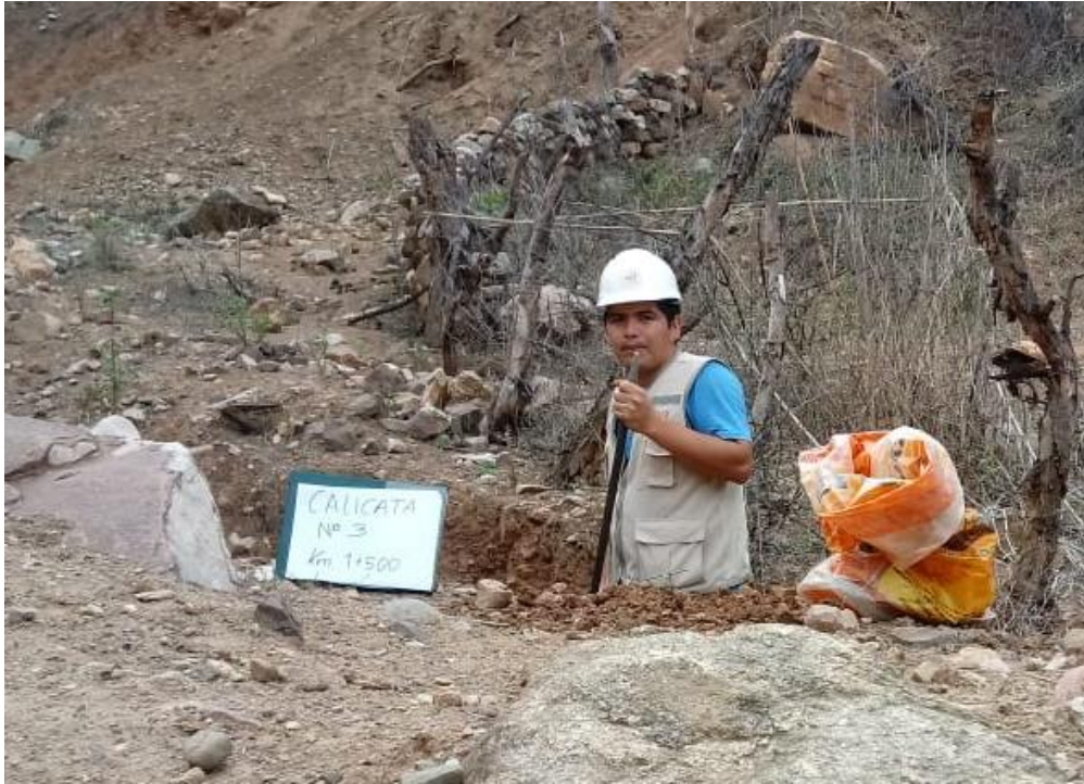
FOTO 05: Excavación de Calicata para la extracción de muestra de suelo.
