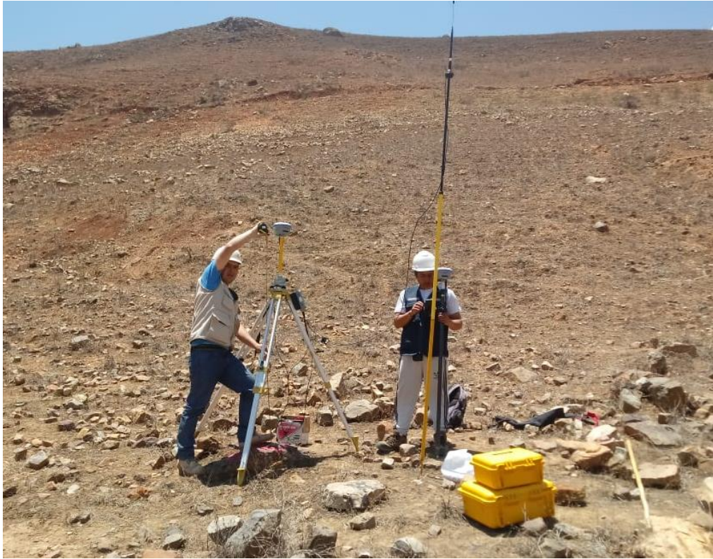
FOTO 03: Instalación de los Equipos Topográficos en campo.
