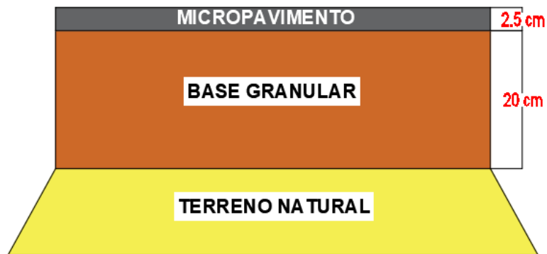
Figura 4. Diseño estructural del pavimento.
