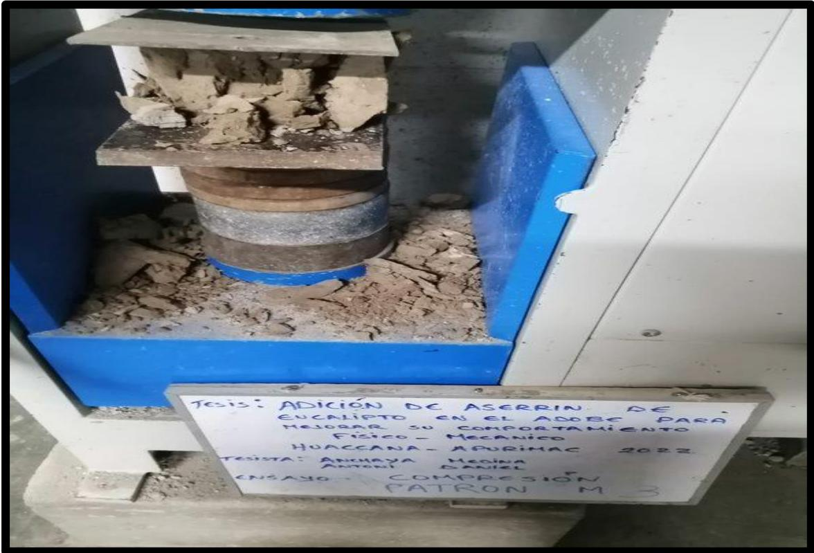
Fotografía 7: Adobe patron M3 ensayo a compresion
