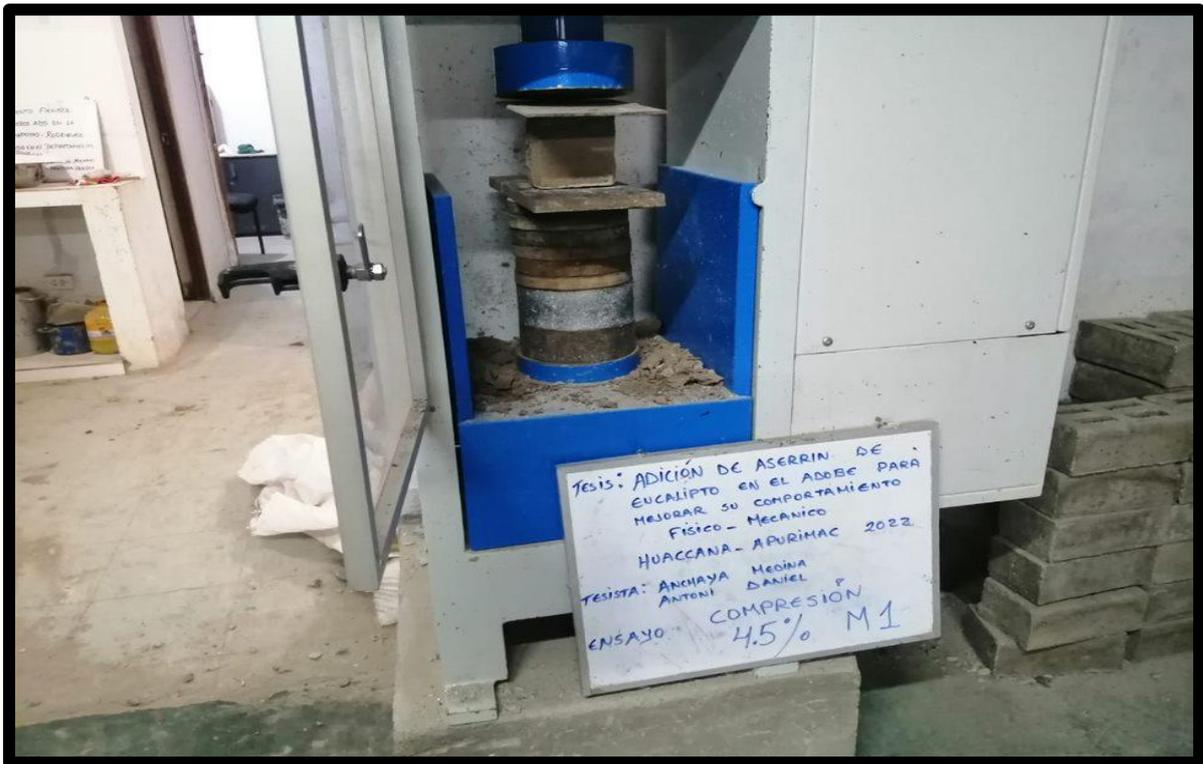
Fotografai 13: Adobe 4.5% aserrin y viruta M1 ensayo a compresion
