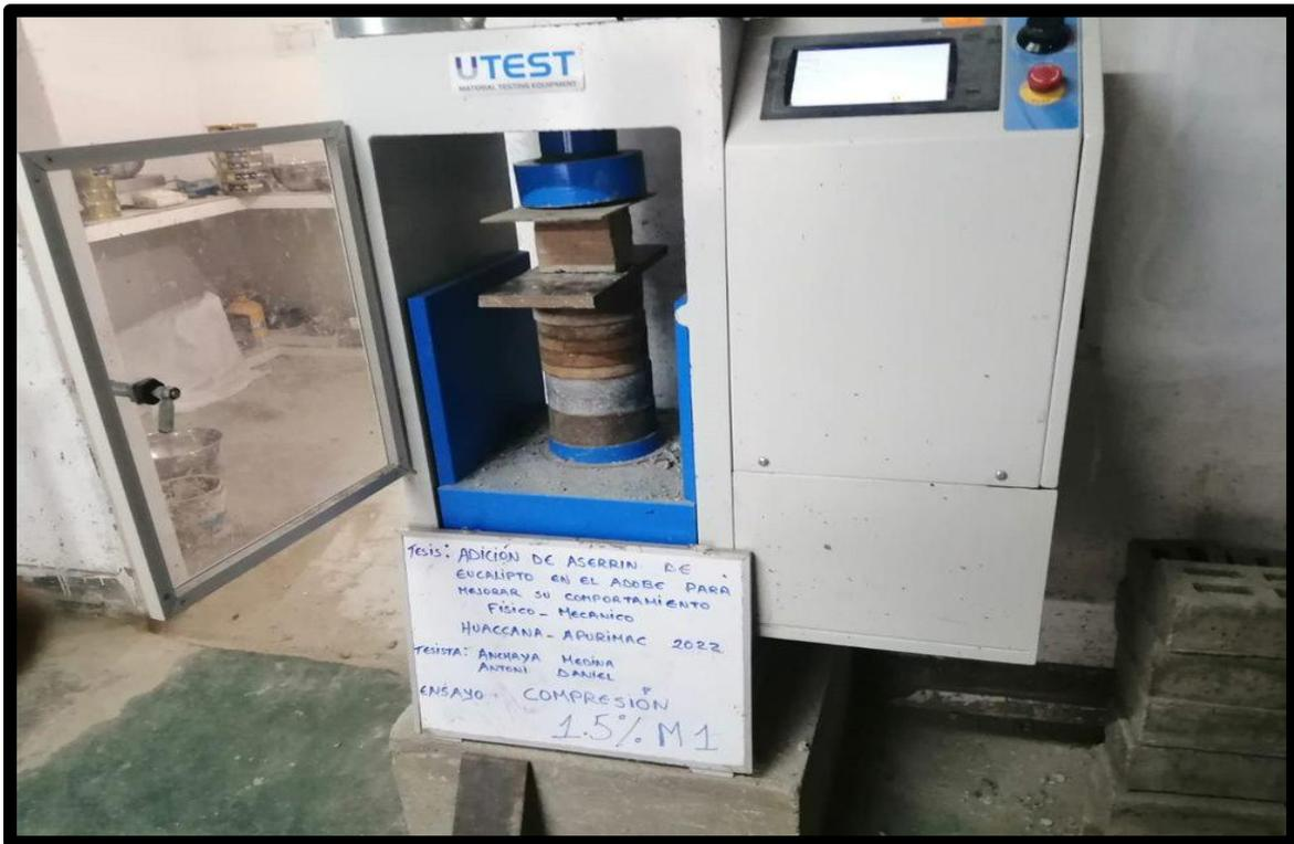
Fotografai 9: Adobe 1.5% aserrin y viruta M1 ensayo a compresion
