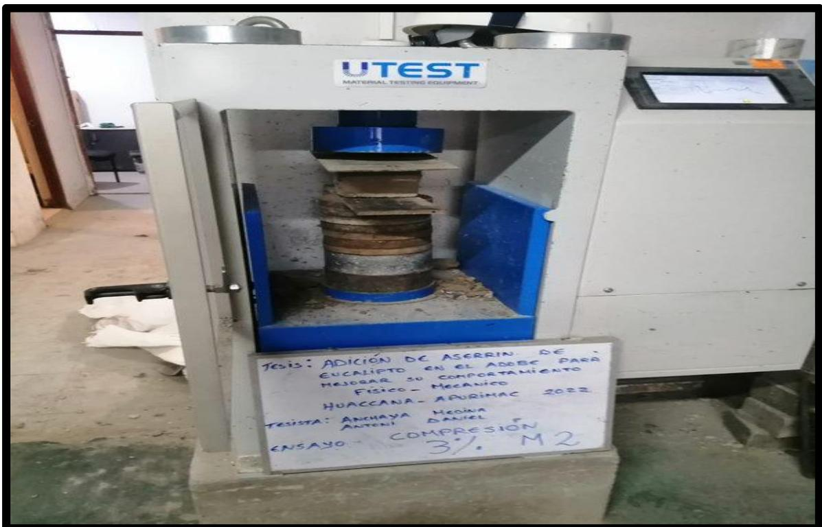
Fotografai 12: Adobe 3.0% aserrin y viruta M2 ensayo a compresion
