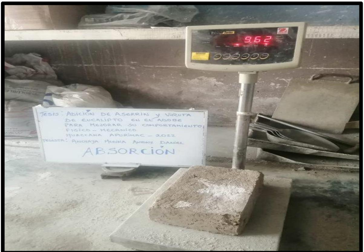
Fotografai 22: pesado de la muestra seca para ensayo de absorcion
