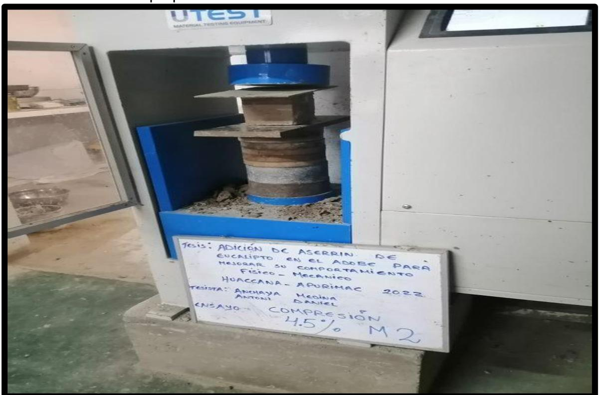
Fotografai 14: Adobe 4.5% aserrin y viruta M2 ensayo a compresion
