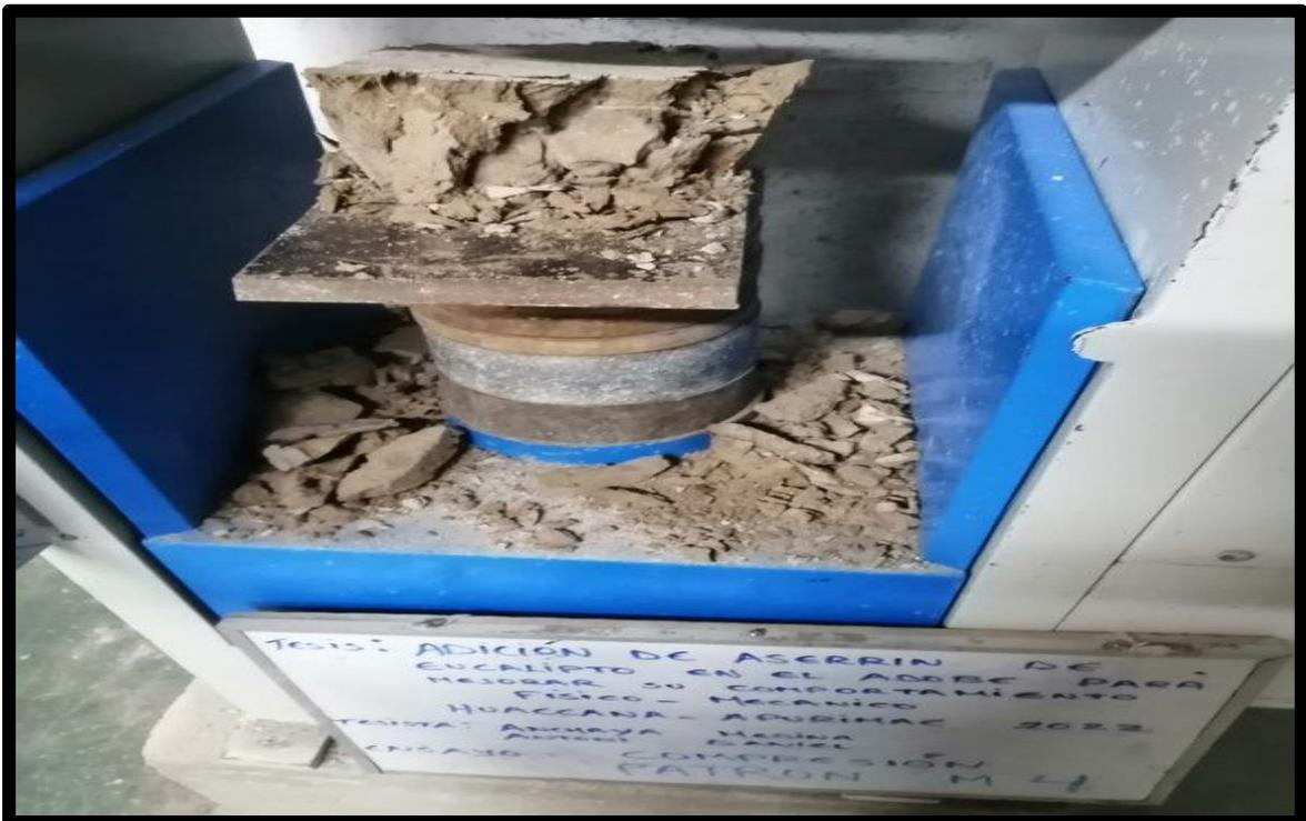
Fotografía 8: Adobe patron M4 ensayo a compresion
