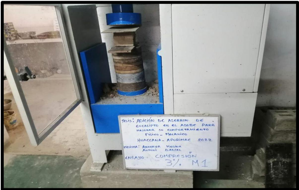
Fotografai 11: Adobe 3.0% aserrin y viruta M1 ensayo a compresion
