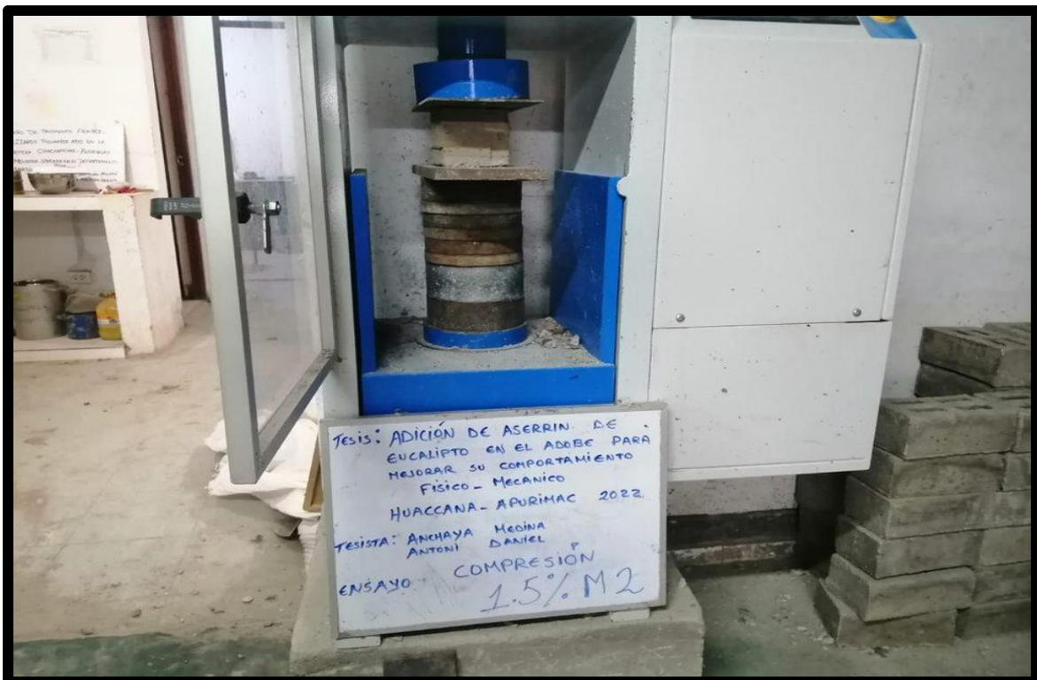
Fotografai 10: Adobe 1.5% aserrin y viruta M2 ensayo a compresion
