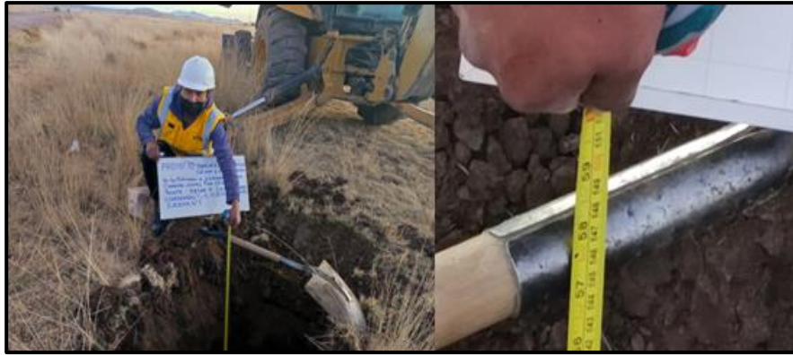
Figura 07. Perforación de calicatas y extracción de muestra
