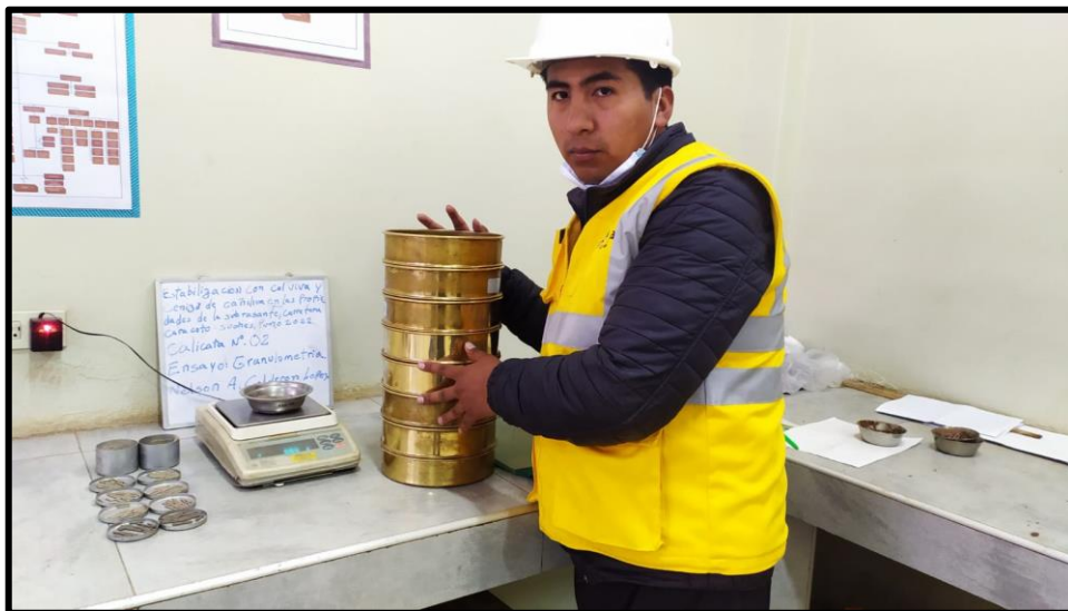
Fotografía 4. Ensayo de granulometría
