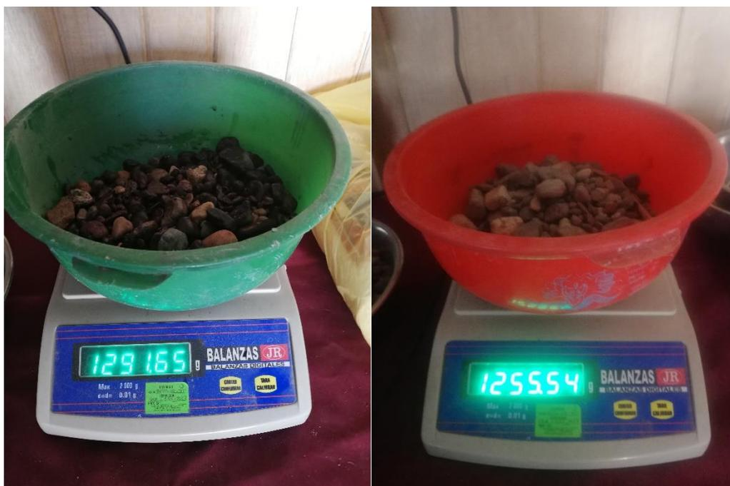
Figura 34. Fotografía de Peso específico y absorción del agregado grueso.
