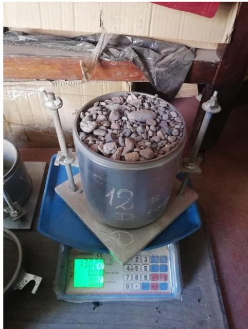
*Figura 31.* Fotografía de Peso unitario suelto del agregado grueso (cantera isla).
