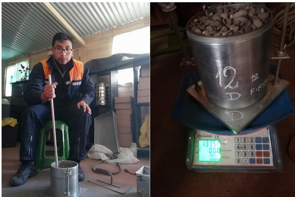
*Figura 32. Fotografía de Peso unitario compactado o varillado del agregado grueso de la cantera isla.*
