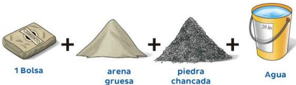
Figura 1. Materiales para un concreto
