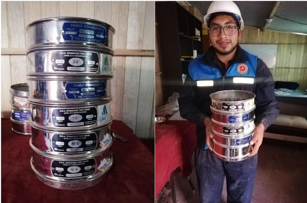
Figura 26. Fotografía de Tamices para granulometría del agregado grueso.
