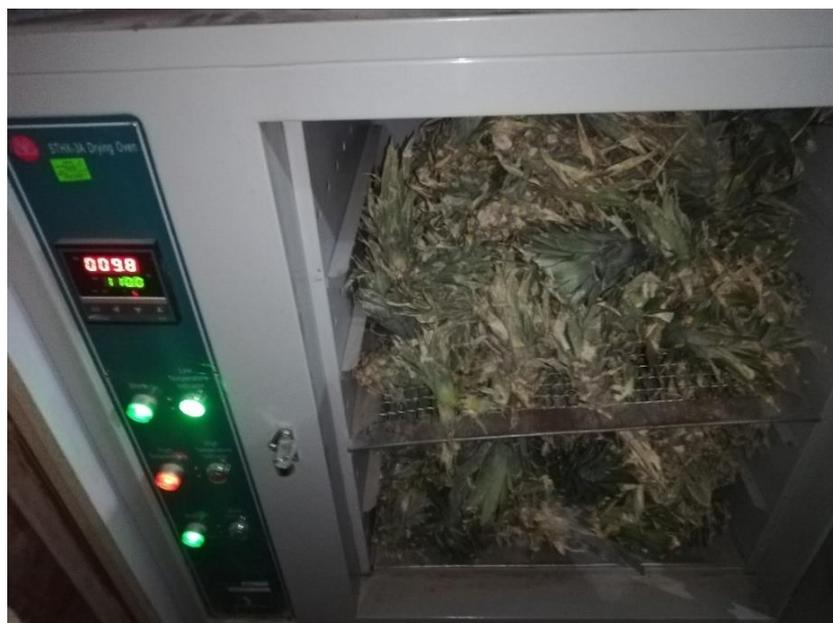
*Figura 16.* Inicio de secado al horno de las hojas de piña.
