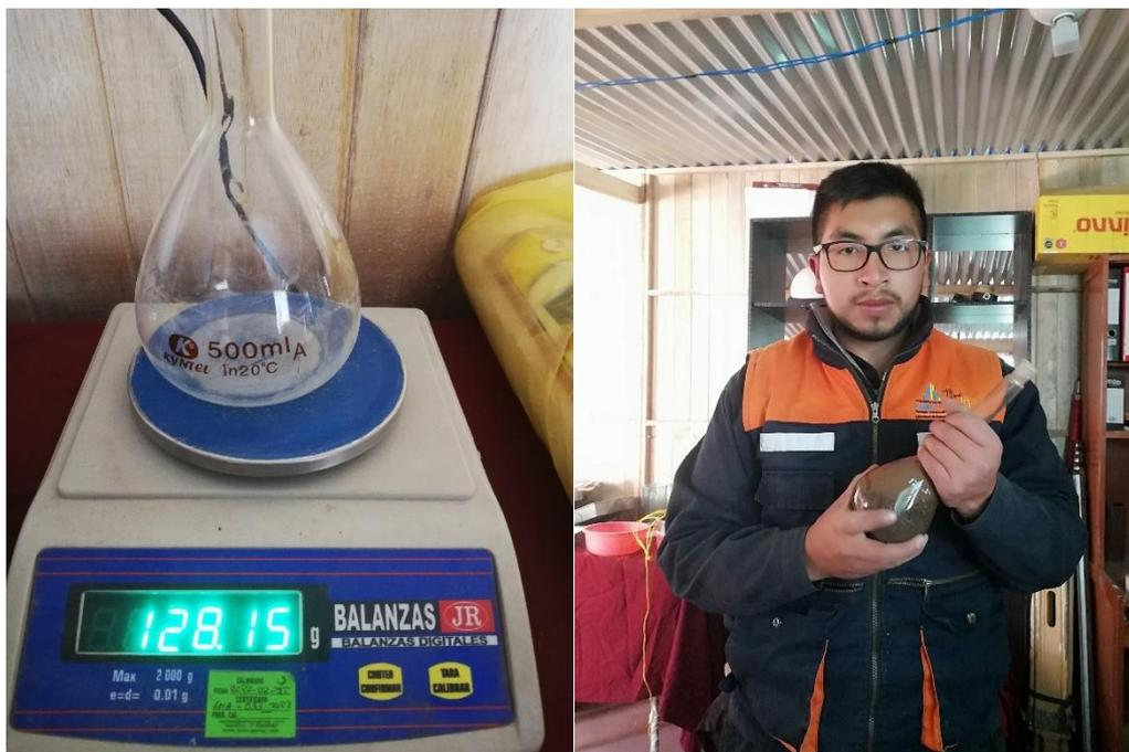
Figura 33. Fotografía de peso específico y absorción del agregado fino de la cantera isla.
