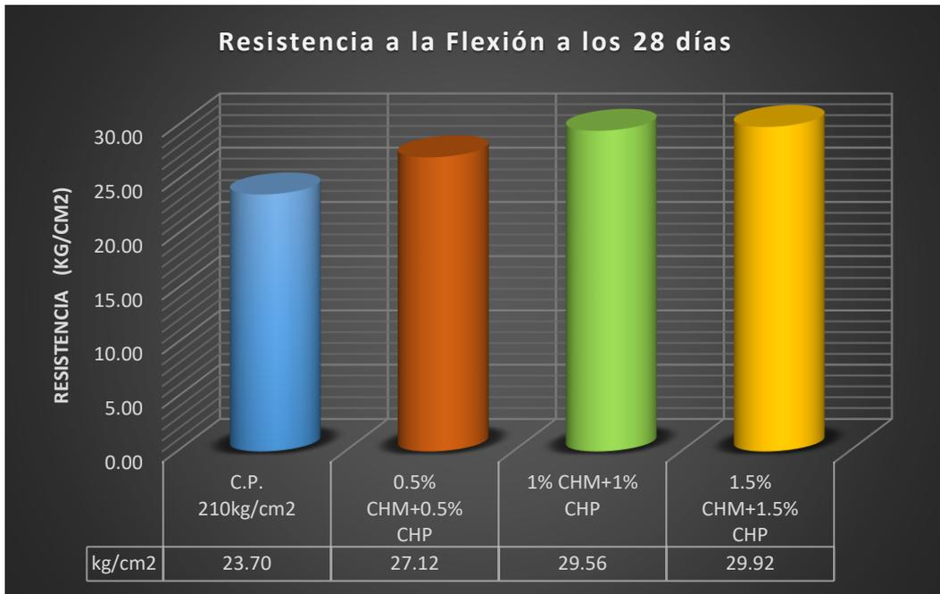
*Figura 49.* Grafica de la resistencia a flexión de la muestra patrón y con la adición de CHM y CHP para 28 días de edad.
