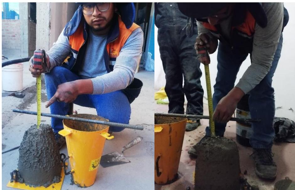
*Figura 39. Fotografía de Asentamiento del concreto de las dosificaciones de concreto patrón y la adición de CHM Y CHP.*
