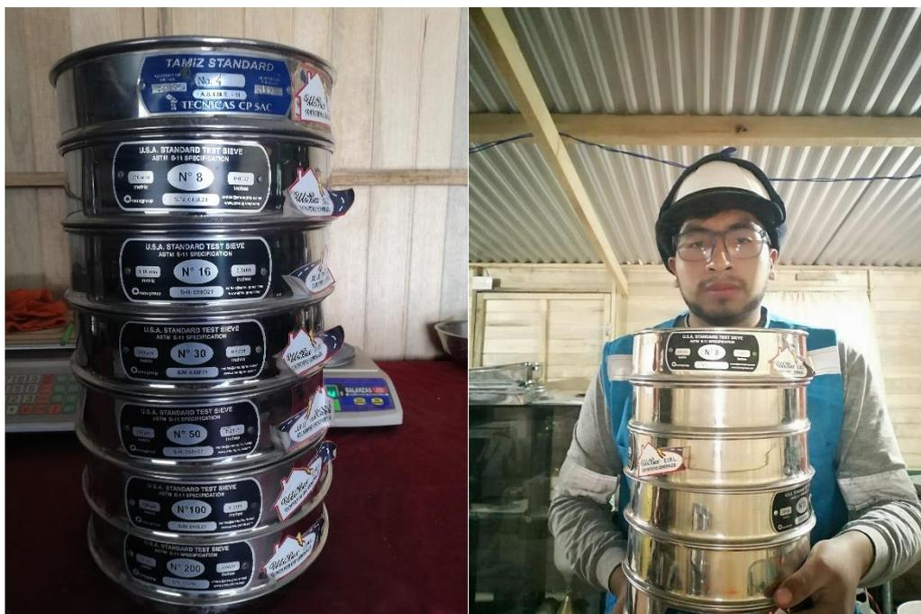
Figura 24. Fotografía de Tamices para granulometría del agregado fino.
