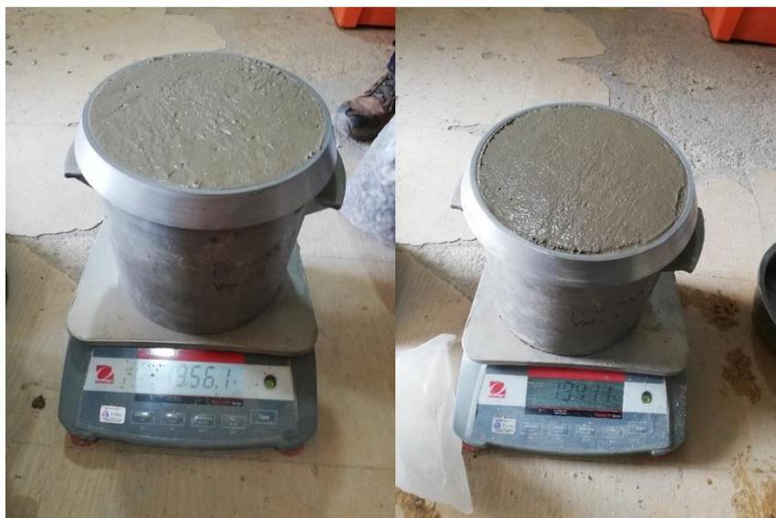
*Figura 35.* Fotografía del peso unitario del concreto de la muestra patrón(C.P.) y con la adición de CHM y CHP.
