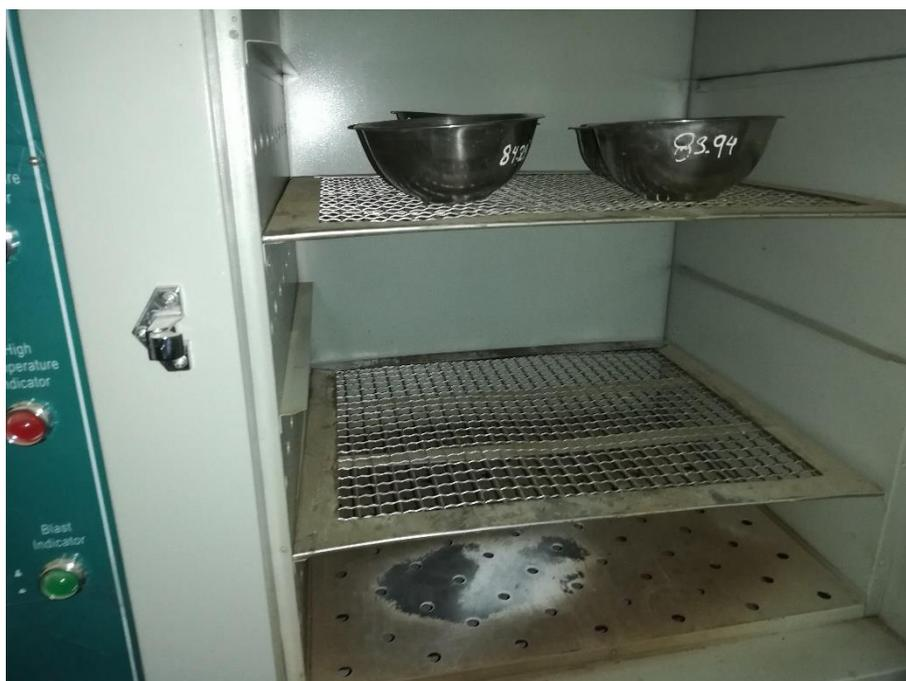
Figura 28. Fotografía del secado de las muestras para sacar contenido de humedad de la cantera isla.
