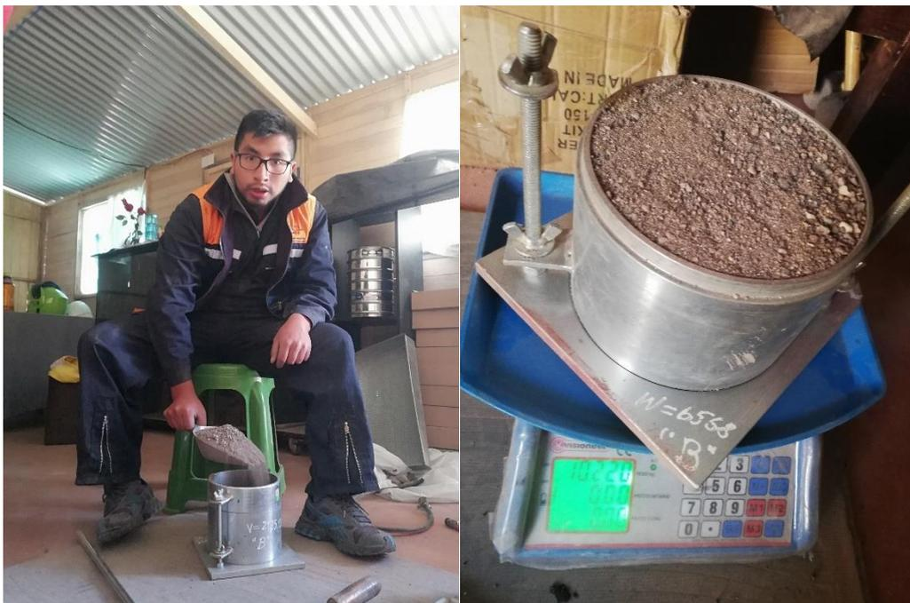
**Figura 29.** Fotografía de Peso unitario suelto del agregado fino.
