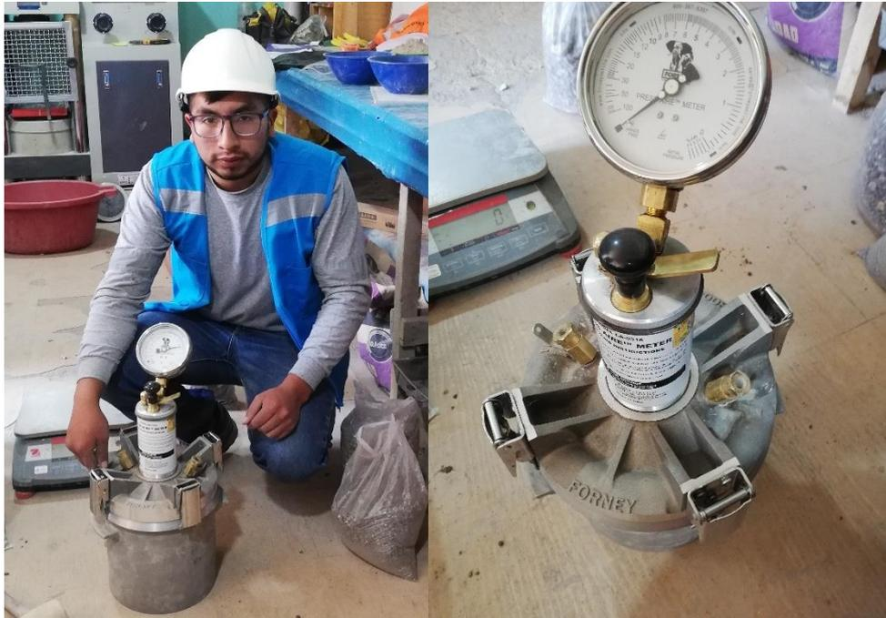
Figura 37. Fotografía del ensayo de contenido de aire de la muestra patrón y con la adición de CHM y CHP.
