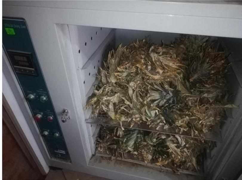
*Figura 17.* Finalización de secado al horno de las hojas de piña.
