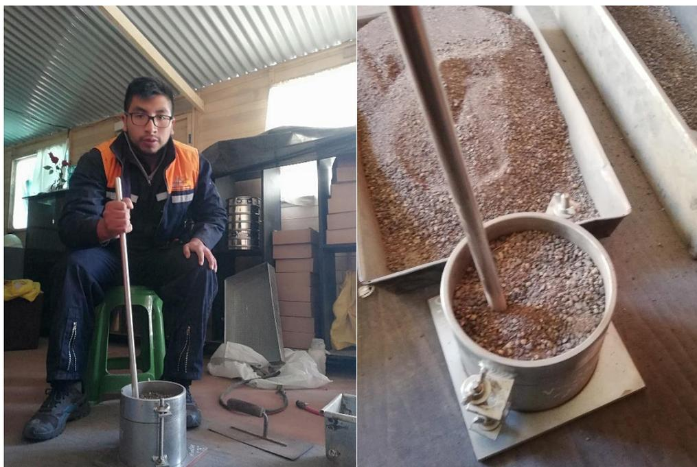
*Figura 30.* Fotografía de Peso unitario compactado o varillado del agregado fino (cantera isla).
