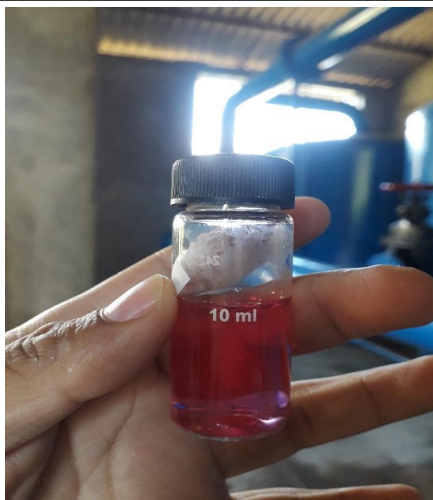
Solución entre el reactivo DPD y el agua clorada
