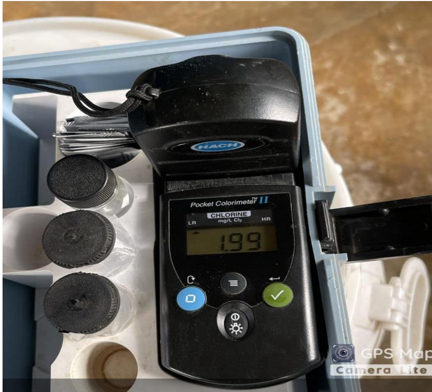
Lectura de cloro residual en el Reservorio Cochaongo - PTAP
