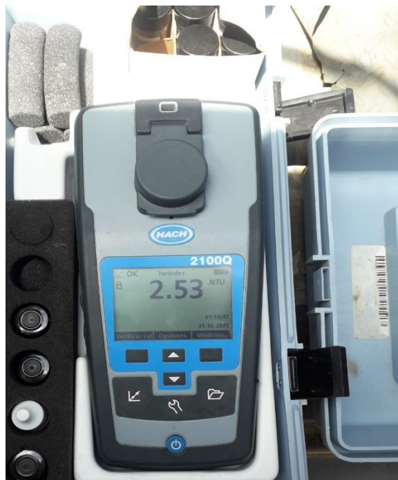
Lectura de Turbidez en el Reservorio Cochaongo - PTAP
