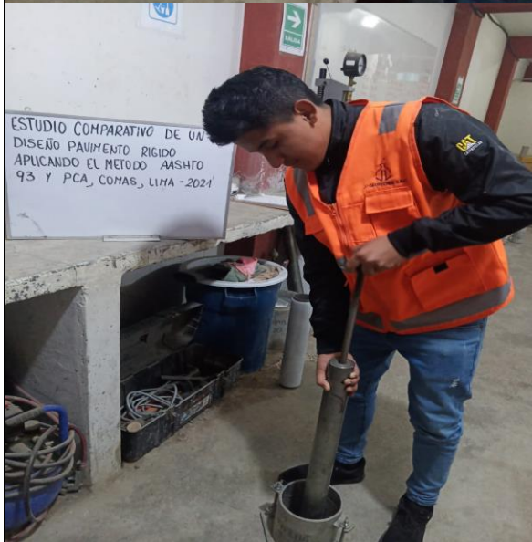
Ensayos de laboratorio de análisis granulométrico, límites de consistencia, CBR y proctor modificado para el conseguir los valore correctos para el diseño de pavimento rígido.
