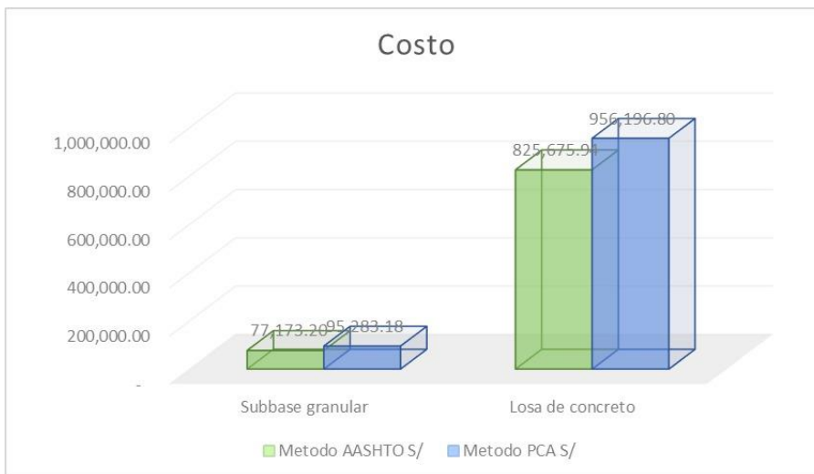
Figura N° 28: Costo del pavimento rígido por ambos métodos.
