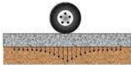
Figura N° 2: Distribución concerniente a pavimento rígido.
