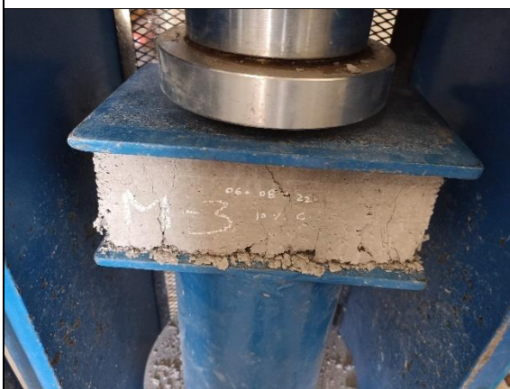
Foto N° 11: Ensayo de resistencia a la compresión de ladrillos macizo de concreto.
