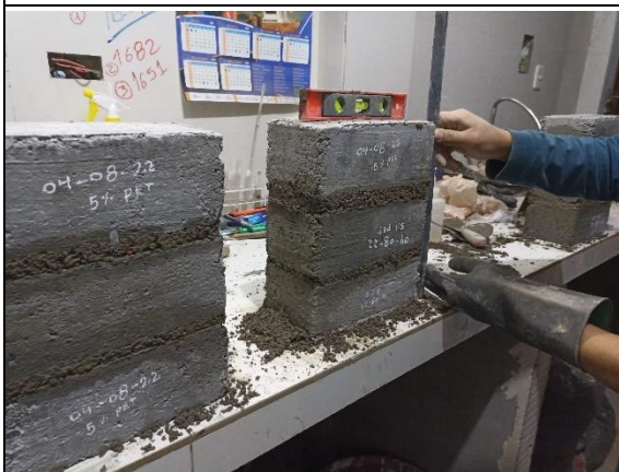
Foto N° 09: Elaboracion de pilas con ladrillo macizo de concreto.
