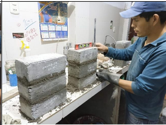
Foto N° 10: Elaboración de pilas con ladrillo macizo de concreto.
