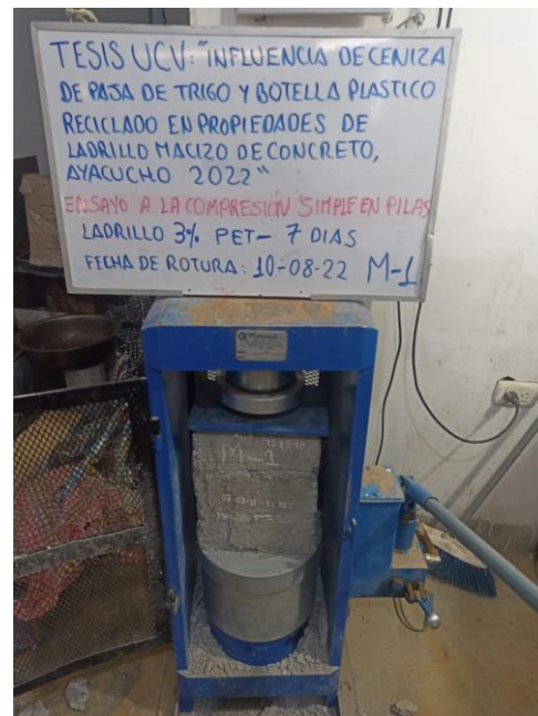
Figura 30. Ensayo a la compresión en pilas con 3% PET
