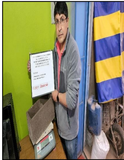
Figura 18. Medición de la masa saturada con agua de los bloques de concreto.
