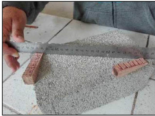
Figura 7. Ensayo alabeo de bloques de concreto.
