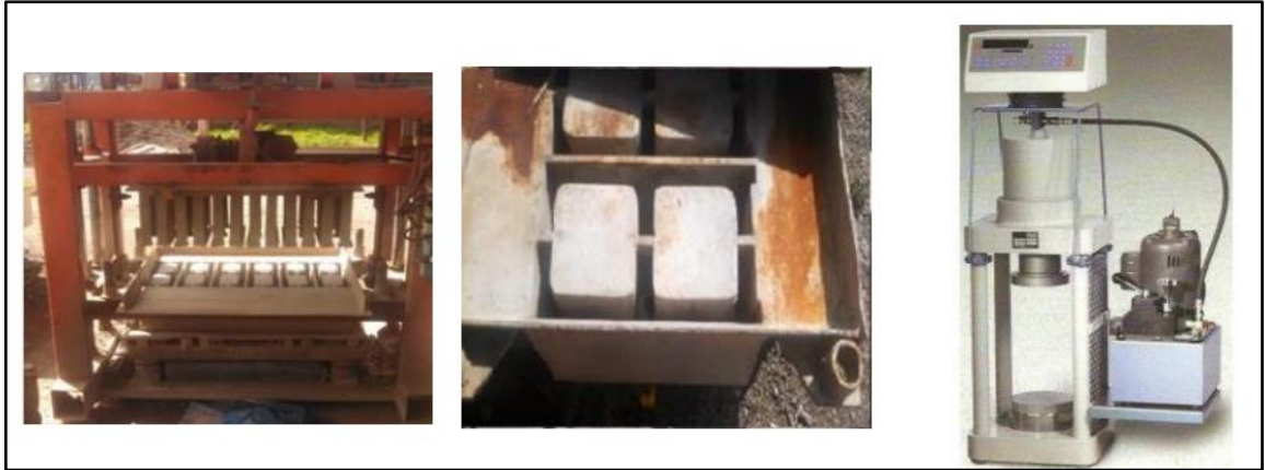
Figura 9. Principales equipos usados: Vibro compactadora, moldes metálicos y máquina de compresión axial.
