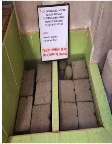
Figura 37. Inmersión de muestras de los bloques de concreto para control de absorción.
