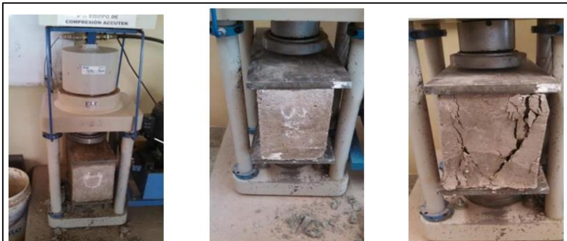
Figura 10. Ensayo a compresión, colocación de los bloques en la máquina de ensayos y falla característica de los bloques.
