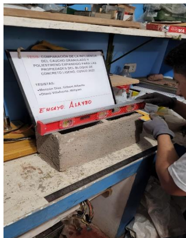
Figura 32. Ensayo alabeo de los bloques de concreto ligero.
