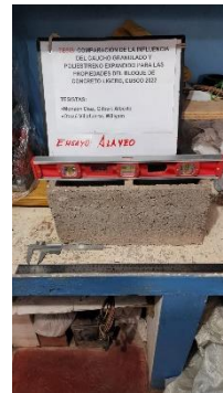
Fotografía 16: alabeo bloques de concreto.
