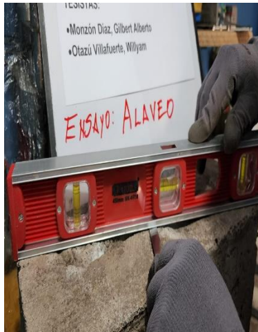
Figura 33. Medición del alabeo en una de las caras de los bloques de concreto ligero.
