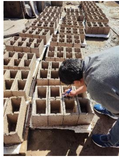
Fotografía 7: clasificación de bloques de concreto
