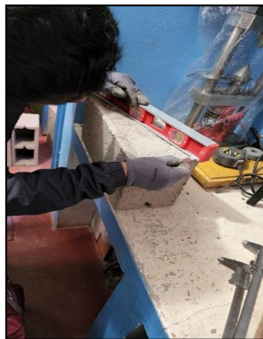
Figura 17. Medición de la convexidad y concavidad de los bloques de concreto.
