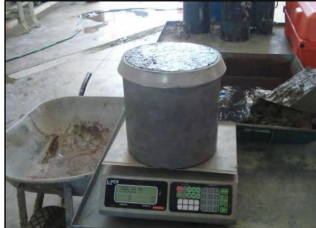
Figura 5. Ensayo Peso unitario de bloques.
