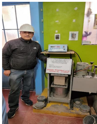
Figura 40. Ensayo resistencia a la compresión de los bloques de concreto.
