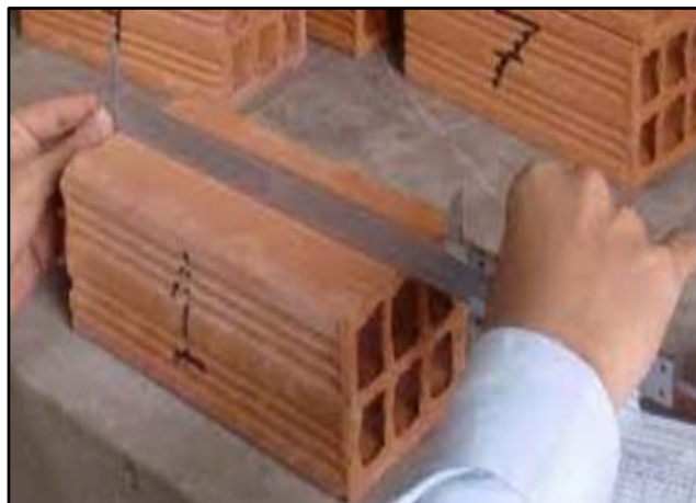
Figura 6. Ensayo variación dimensional de bloques.
