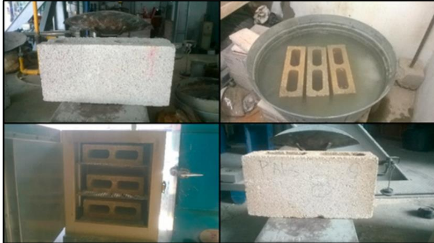
Figura 8. Ensayo de absorción en bloques de concreto.
