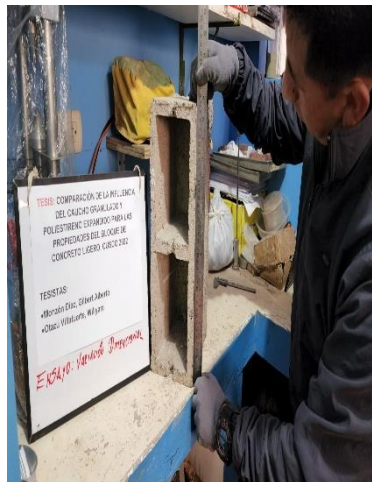
Figura 28. Ensayo de la variación dimensional de los bloques de concreto.
