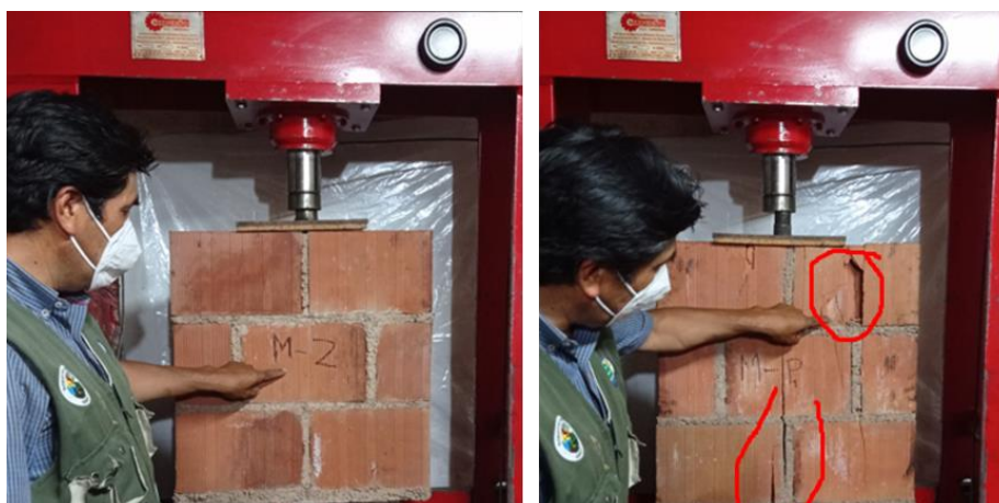
Figura N° 60: Ensayo de resistencia axial en muretes.
