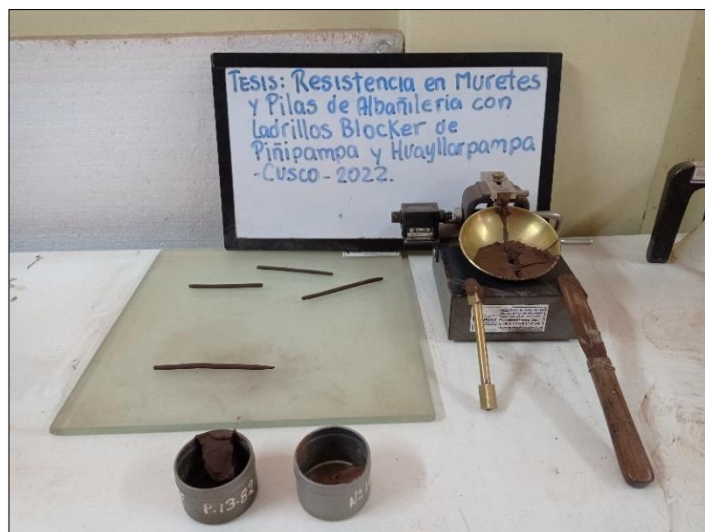
Figura N° 43: Muestra del ensayo con Casagrande
