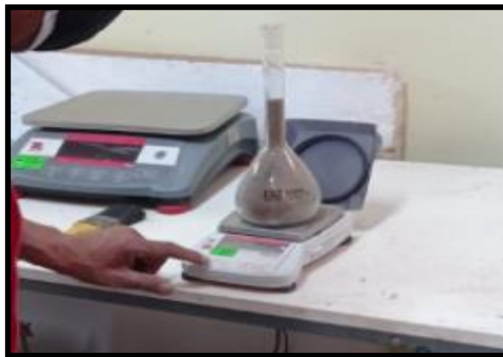
Figura N° 52: Instrumentos de medición de porcentaje de vacíos
