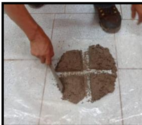
Figura N° 46: Cuarteo del agregado fino
