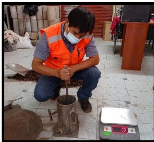
Figura N° 48: Compactando con barra en cada capa 25 golpes
