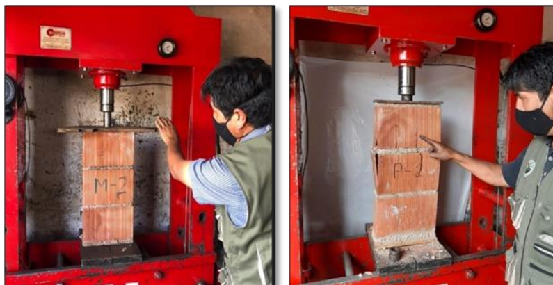
Figura N° 57: Proceso del ensayo axial en pilas
