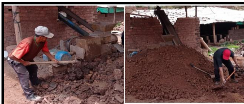
Figura N° 15: Proceso de trituración de arcilla
