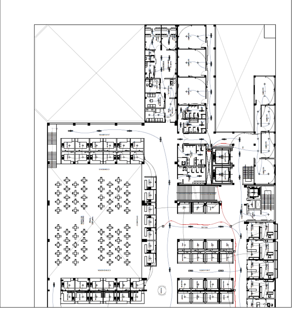
INSTALACIONES ELECTRICAS SEGUNDO NIVEL SECTOR "B" ESC. 1:100
