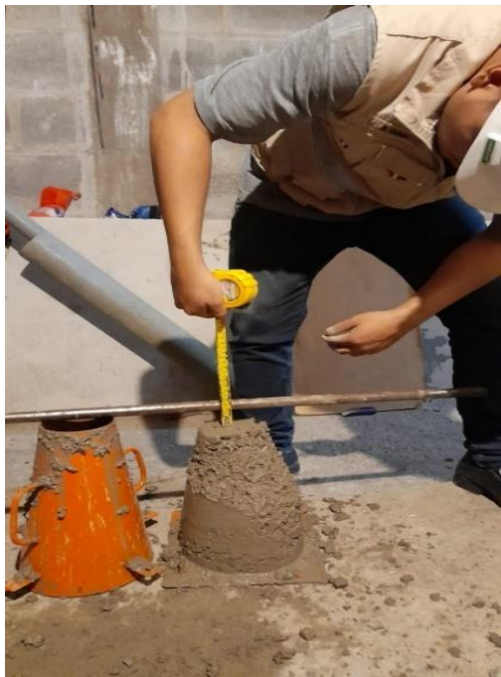
Figura N°17: Ensayo Slump con el 7% de fibra de guayaquil con una caída de 2" - Elaboración propia.
