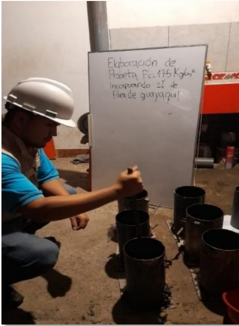
Figura N°20: Elaboración de probetas f'c= 175 \text{ kg/cm}^2 incorporado el 2% de fibra de guayaquil- Elaboración propia.
