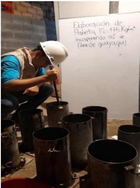
Figura N°21: Elaboración de probetas f'c= 175 \text{ kg/cm}^2 incorporado el 5% de fibra de guayaquil- Elaboración propia.
