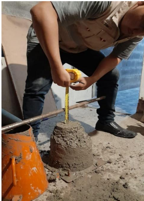
Figura N°15: Ensayo Slump con el 2% de fibra guayaquil con un asentamiento de 3.4" - Elaboración propia.
