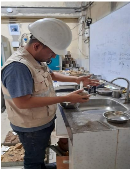
Figura N°11: Se procedió a retirar con cuidado el agua de la fiola, dejando dentro solo el agregado fino- Elaboración propia.
