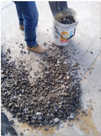
Figura N°18,19: Preparación de mezcla para la elaboración de probetas siguiendo las especificaciones al 0%, 2%, 5% y 7%- Elaboración propia.
