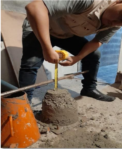
Figura N°14: Ensayo Slump con el concreto patrón con un asentamiento de 3" - Elaboración propia.
