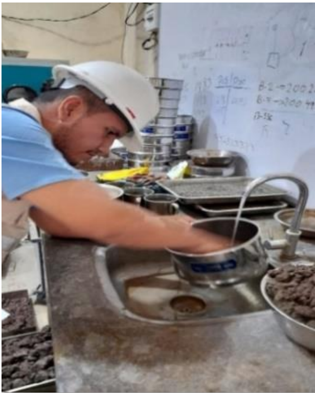
Figura N°9: Lavado del agregado fino, ensayo de granulometría- Elaboración propia.
