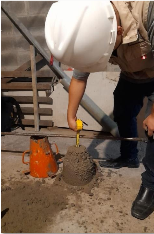
Figura N°16: Ensayo Slump con el 5% de fibra de guayaquil con una caída del concreto de 2.8" - Elaboración propia.
