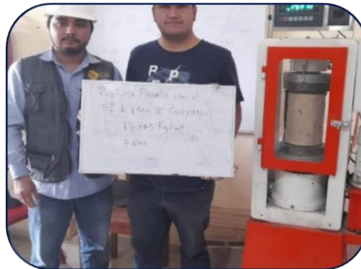
Figura N°28: Colocado de probeta en maquina de ensayo de compresion
