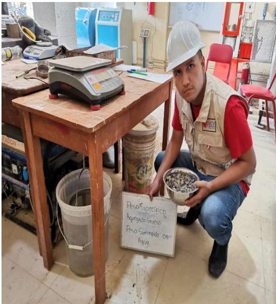
Figura N°13: ensayo de peso específico agregado grueso- Elaboración propia.
