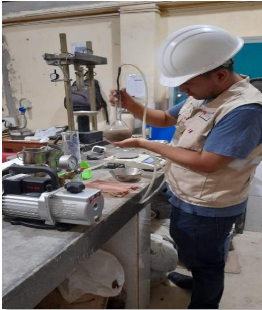
Figura N°10: Se procedió a retirar el aire de la fiola con ayuda de la bomba de vacío- Elaboración propia.
