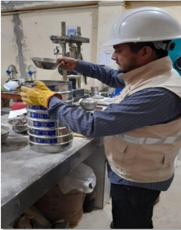
Figura N°08: Tamizado del agregado fino (arena gruesa) - Elaboración propia.
