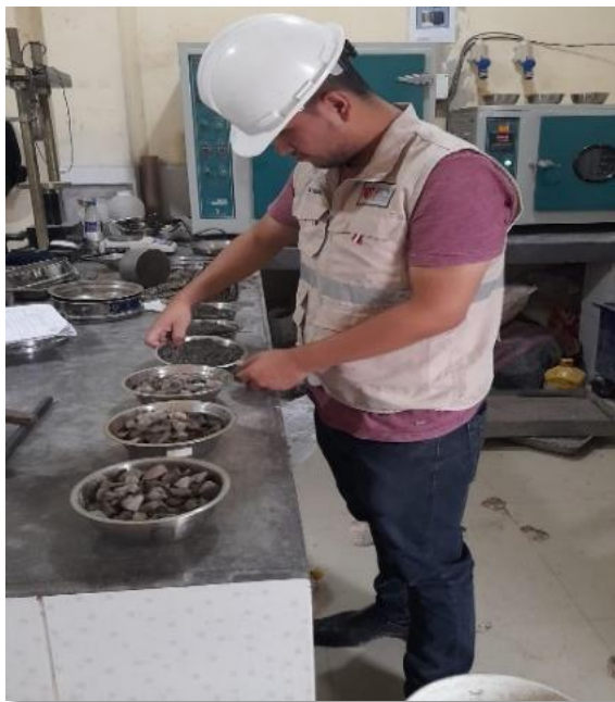
Figura N°5: Procedimiento del pesado de nuestro agregado grueso- Elaboración propia.
