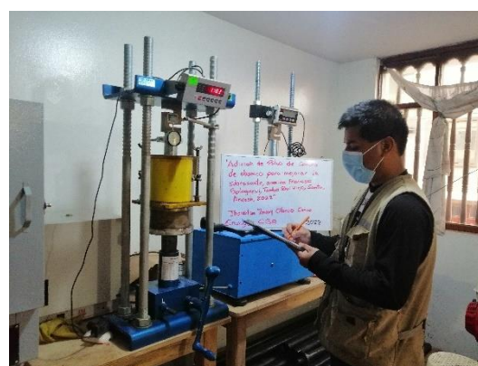
Figura 21. Ensayo CBR registro de datos SP y SP + Adiciones %
