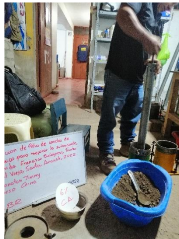
Foto N° 18: Ensayo CBR del suelo patrón más 6% PCA
