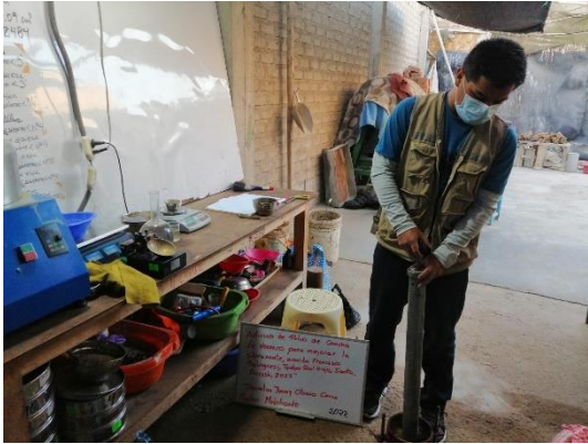
Figura 17. Ensayo Proctor Modificado Suelo Patrón (C-02)
