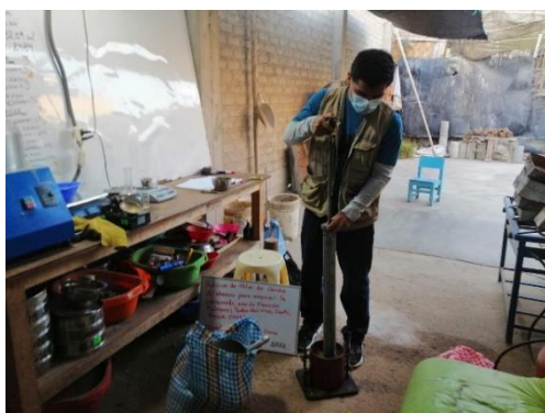
Figura 14. Ensayo Proctor Modificado OCH - Suelo Patrón (C-02)
