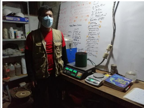
Foto N° 22: Pesado del molde CBR en la balanza calibrada
