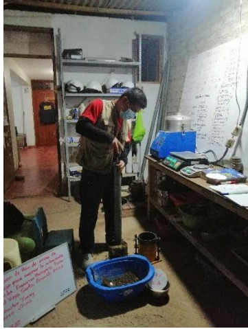
Foto N° 19: Ensayo CBR del suelo patrón más 9% PCA
