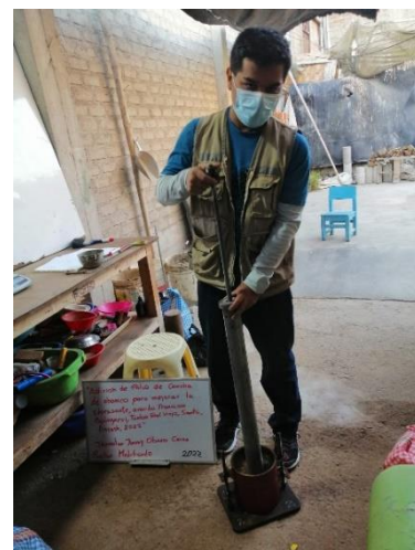
Figura 15. Ensayo Proctor M. OCH Suelo Patrón + %experimental
