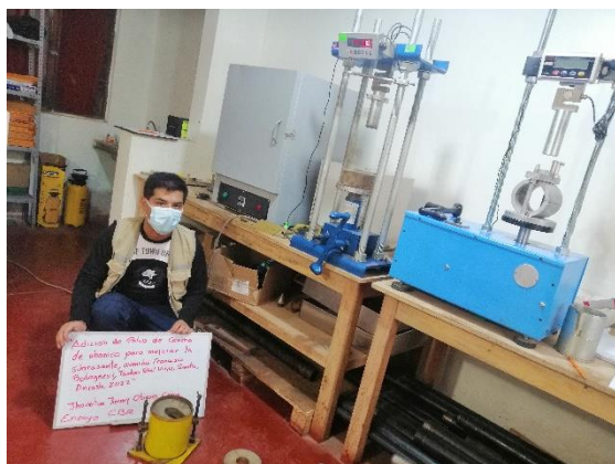
Foto N° 23: Colocación del molde en la prensa CBR
