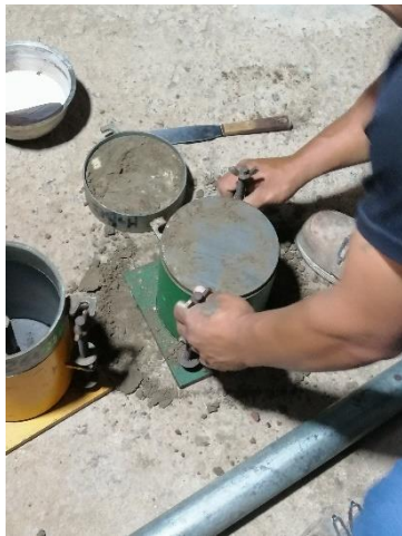
Foto N° 21: Enrase de moldes para posteriormente sumergirlos
