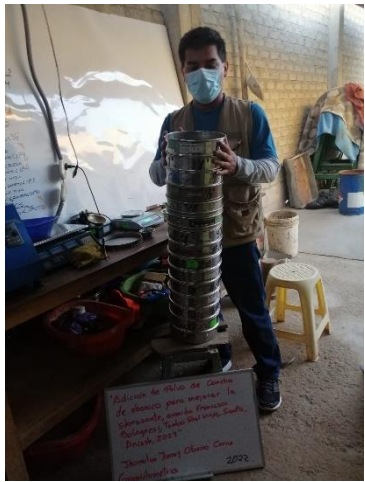
Foto N° 13: Tamizado del suelo natural (C-2), granulometría
