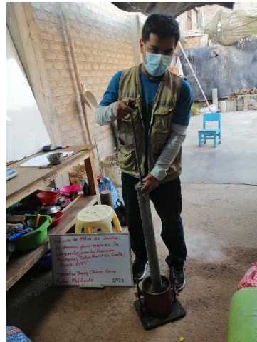
Foto N° 16: Ensayo Proctor Modificado para suelo patrón y experimental
