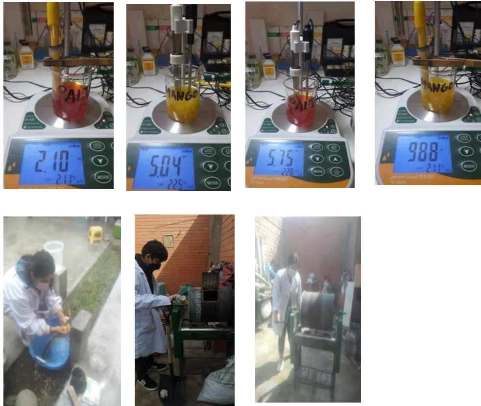
Figura 13. Determinación de las características físicas y químicas de las semillas de Persea americana y Mangifera indica , y torrefacción
