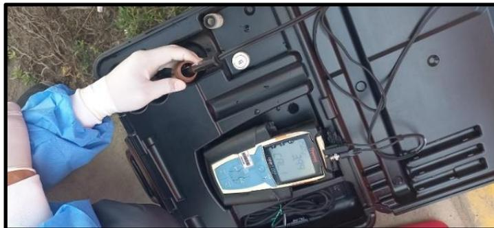
**Figura 23.** Proceso de calibrado de equipo multiparámetro
