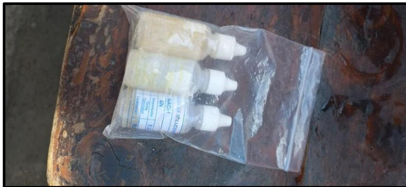
**Figura 26.** Preservante (ácido nítrico, ácido sulfúrico e hidróxido de sodio)
