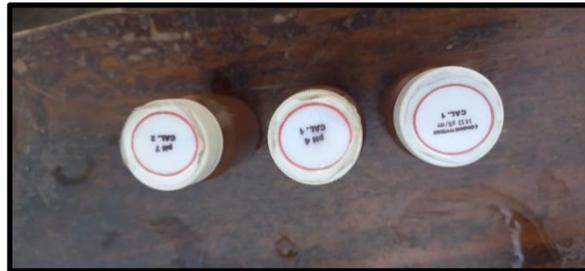
**Figura 22.** Patrones de calibración pH 4 pH 7 y conductividad 1314
