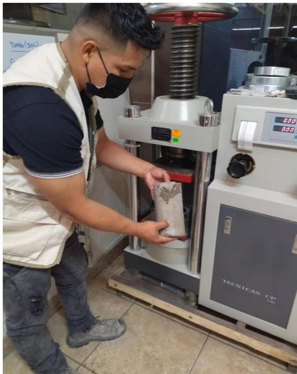
Ruptura de la probeta
