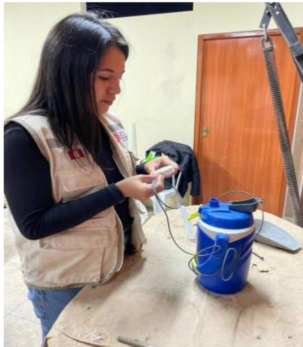
Medición de la temperatura de la mezcla en estado fresco
