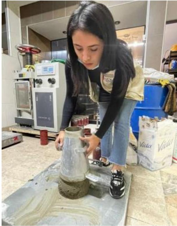
Ensayo del concreto en estado fresco en el Cono de Abrams
