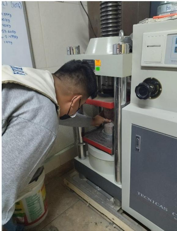
Colocación de la probeta en la prensa hidráulica
